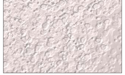
Görsel 3.2: Portakallanma kusuruna sahip boyalı yüzey
