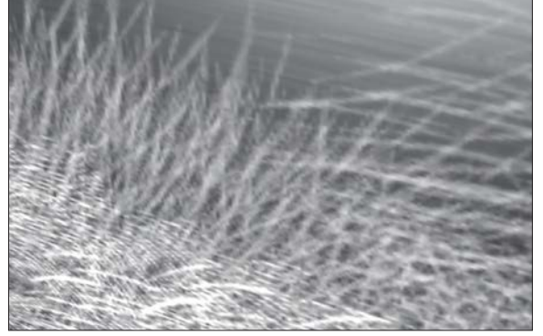
Görsel 3.4: Zımpara izi kusuruna sahip boyalı yüzey
