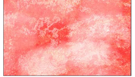
Görsel 3.10: Tebeşirlenme kusuruna sahip boyalı yüzey
