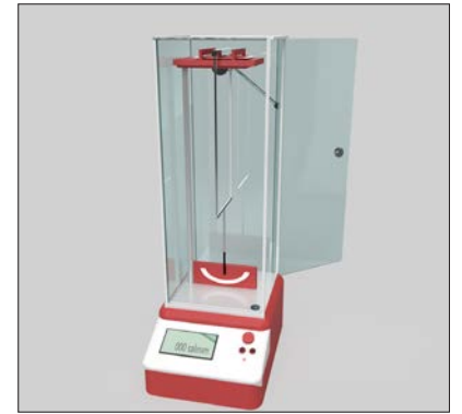
Görsel 2.8: Konig-Albert pendulum cihazı
