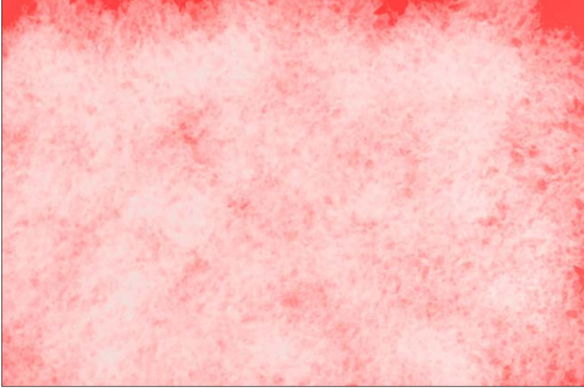
Görsel 3.14: Bulutlanma kusuruna sahip boyalı yüzey
