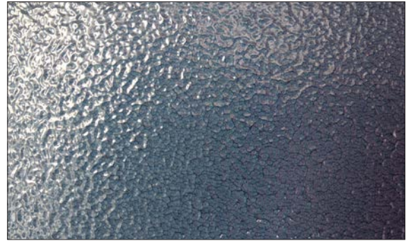
Görsel 3.5: Silikonlanma kusuruna sahip boyalı yüzey
