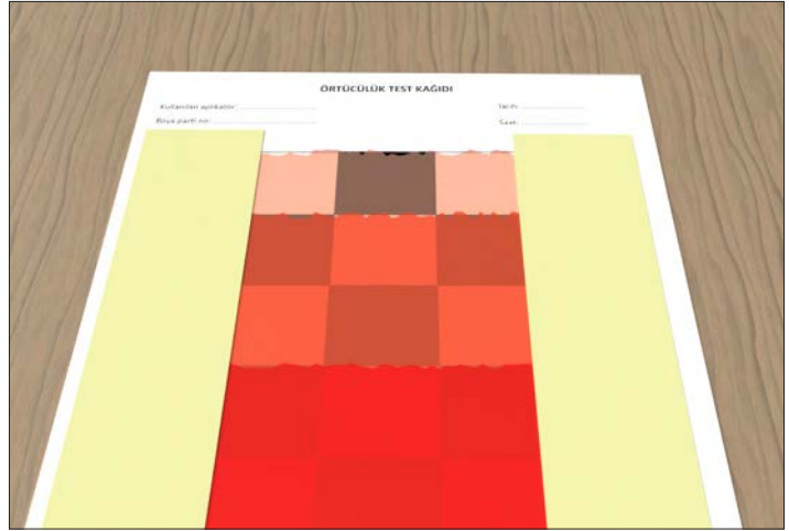
Görsel 1.31: Zebra kâğıdı ile örtme gücü ölçümü
