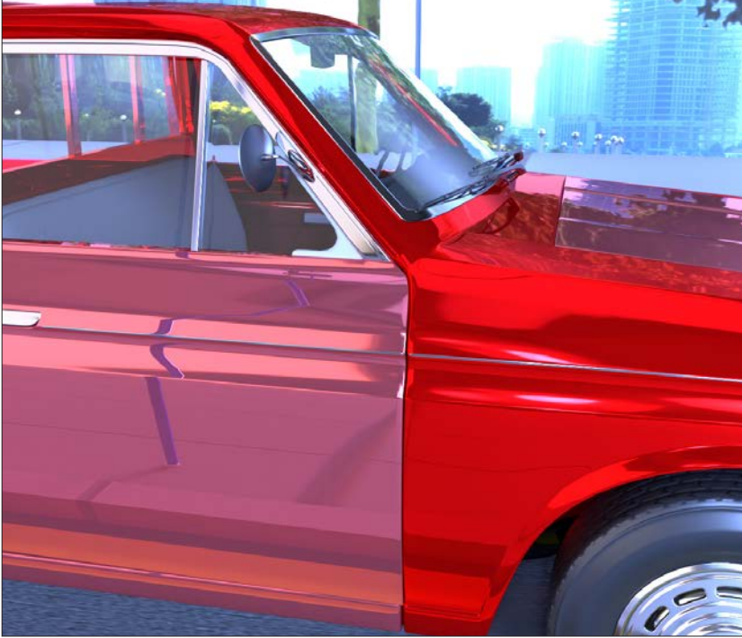
Görsel 3.13: Boya yapılmış aracın kapısında oluşan renk sapması
