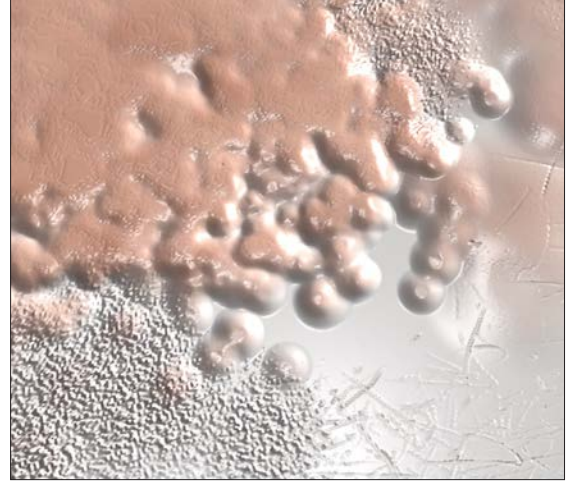
Görsel 2.18: Kabarcıklanmış boyalı yüzey
