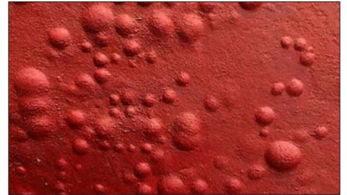
Görsel 3.3: Kabarcıklanma kusuruna sahip boyalı yüzey
