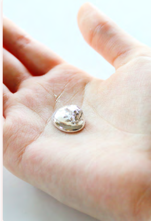
Görsel 4.1: Galyumun vücut sıcaklığında sıvılaşması
