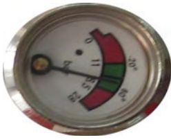
Görsel 2.40: Manometre ibresi yeşil bölge üzerinde olmalıdır.
