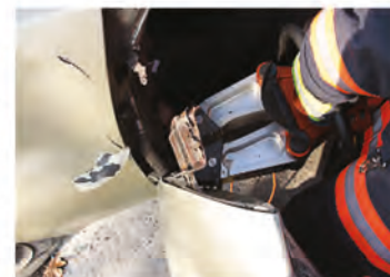
3. Aşama kapının menteşe tarafından kesilerek açılması
