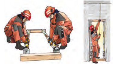
Görsel 4.38: Kapı desteği uygulaması
