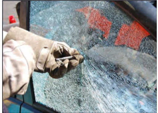
Görsel 6.18: Kaza yapan araç camının özel cam delgisi ile kırılarak çıkarılması
