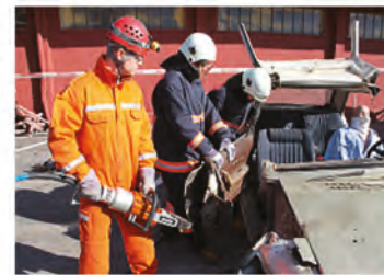
3. Aşama kapının menteşe tarafından kesilerek açılması
