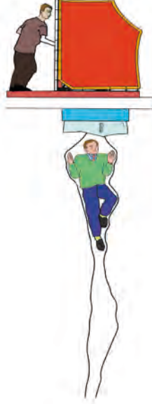
Görsel 7.22: Bina içi kurtarma tüneli kullanma
