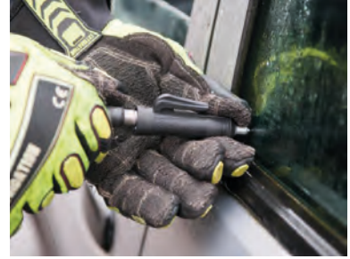
Görsel 6.33: Kaza yapan aracın özel cam delgisi ile kırılarak çıkarılması
