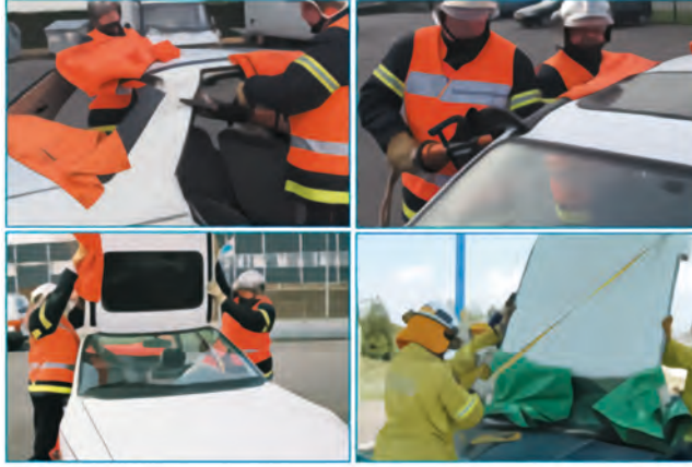
Görsel 6.26: Kaza yapan aracın tavanının arkadan öne doğru açılması
