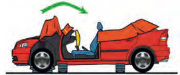
Görsel 6.37: Kaza yapan aracın tavanının önden arkaya doğru açılması
