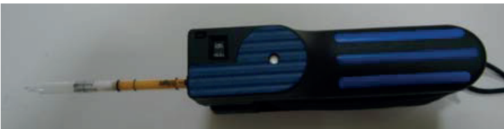
Görsel 1.62: Sorbent tüpleri ile ölçüm yapmak
