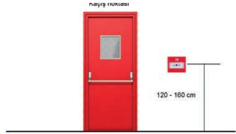
Şekil 4.3: Yangın ihbar butonunun kaçış noktasına yerleşimi
