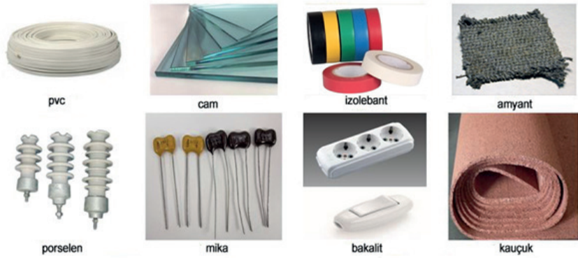
Görsel 3.17: Çeşitli yalıtkan malzemeler
