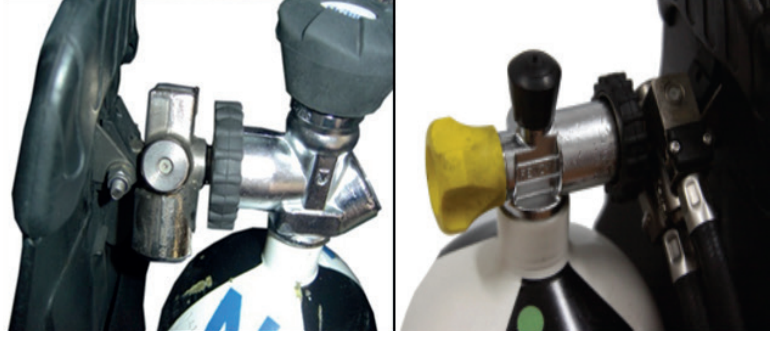
Görsel 1.24: Tüpün regülatör bağlantısı
