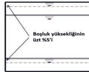
Şekil 4.14: Dedektörlerin delikli tavana yerleşimi
