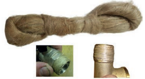
Görsel 11.18: Keten ve dişlere sarılması
