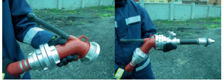
Görsel 7.17: Dirsek ve lans ile kullanım
