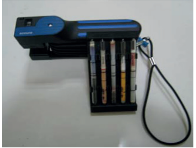
Görsel 1.47: Sorbent tüpleri renk değişimi kimyası testi
