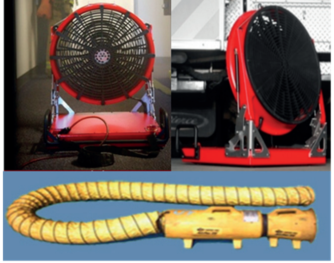
Görsel 6.12: Gaz tahliye ekipmanları
