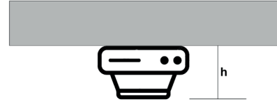
Şekil 4.7: Dedektörlerin eğimli tavana yerleşimi
