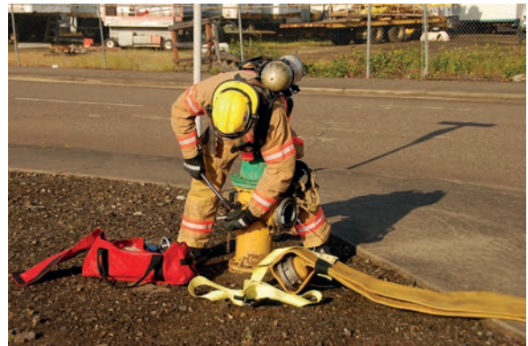
Görsel 7.53: Hortum birleştirme ve ekipman kullanımı
