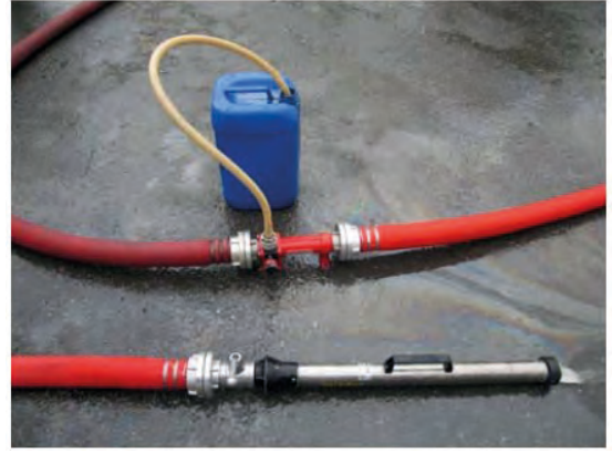
Görsel 7.5: Melanjör ve ağır köpük lansı bağlantısı
