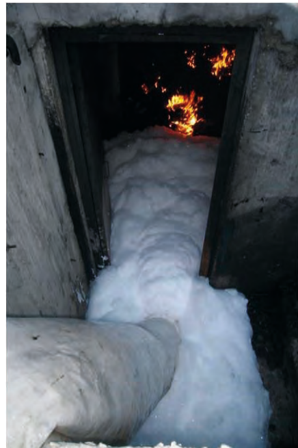
Görsel 7.8: Köpük jeneratörüyle müdahale
