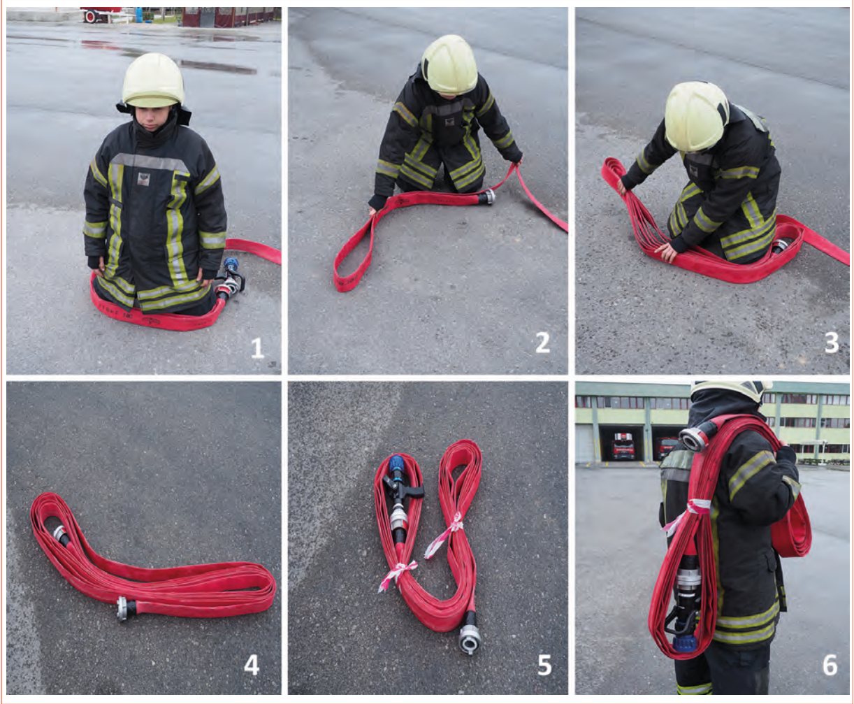
Görsel 3.11: Oval sarım yönteminin aşamaları
