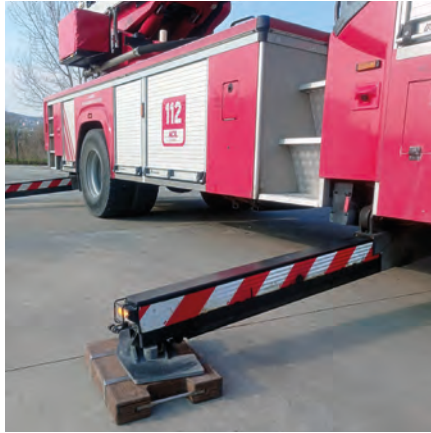
Görsel 4.34: Hidrolik destek ayağının açılması
