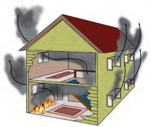
Görsel 3.45: Doğal havalandırma
