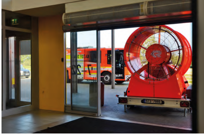
Görsel 6.4: Yangına kuvvetli üfleme fanı (ventilator)
