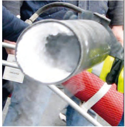
Görsel 7.15: Karbondioksidin kuru buz oluşturmaları
