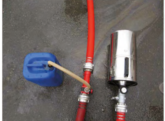
Görsel 7.6: Melanjör ve orta köpük lansı bağlantısı
