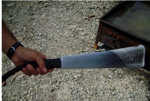
Görsel 7.20: Karbondioksitli söndürücü
