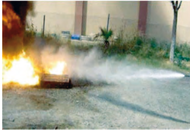
Görsel 7.16: Hidrokarbonlu söndürücü
