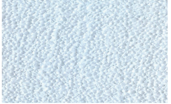
Resim 7.12: b) Polistiren köpüğün yapısı
