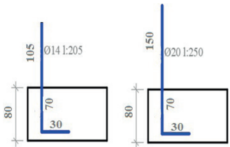
Şekil 3.51: Tipik kolon ve perde filizi (Temel yüksekliği 80 cm)
