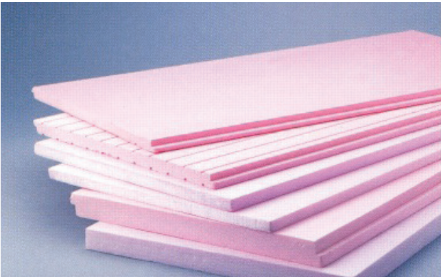
Resim 7.13: a) Ekstrüde polistiren köpük
