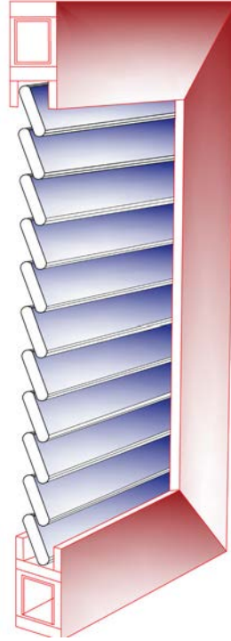
Şekil 4.63: Pencere kepenk sistemi kesit çizimi
