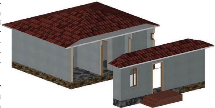
Görsel 1.14: Düşey kesitin yapı üzerindeki ifadesi
