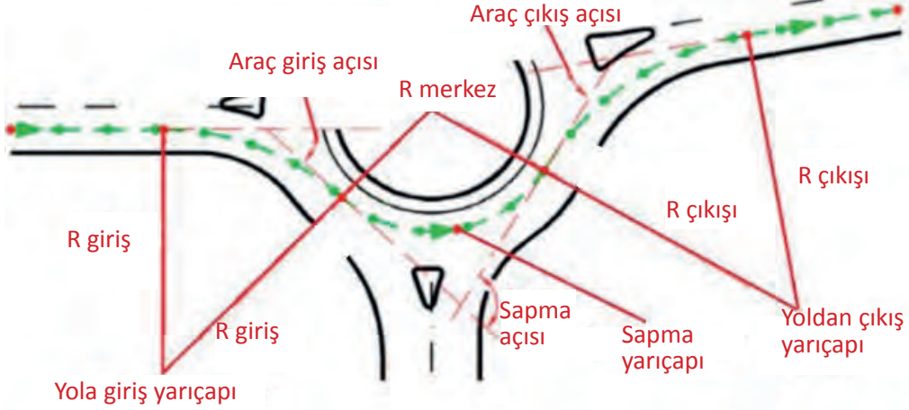
Şekil 2.14: Dönel kavşak geometrik elemanları
