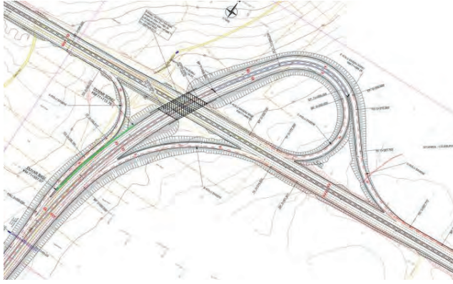
Şekil 2.19: Trompet köprülü kavşak tasarımı
