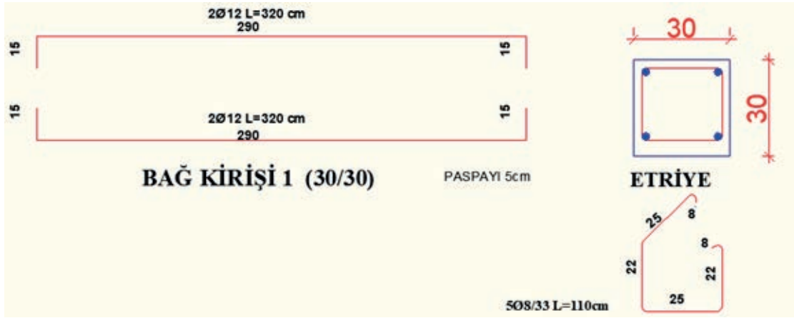
Şekil 14.5: Bağ kirişi 1 donatı açılımı ve detayı
