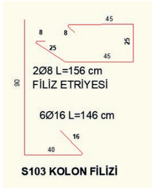
Şekil 14.8: S103 kolon donatı açılımı
