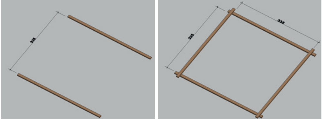
Şekil 2.42: Destek kirişlerinin yere çakılması
