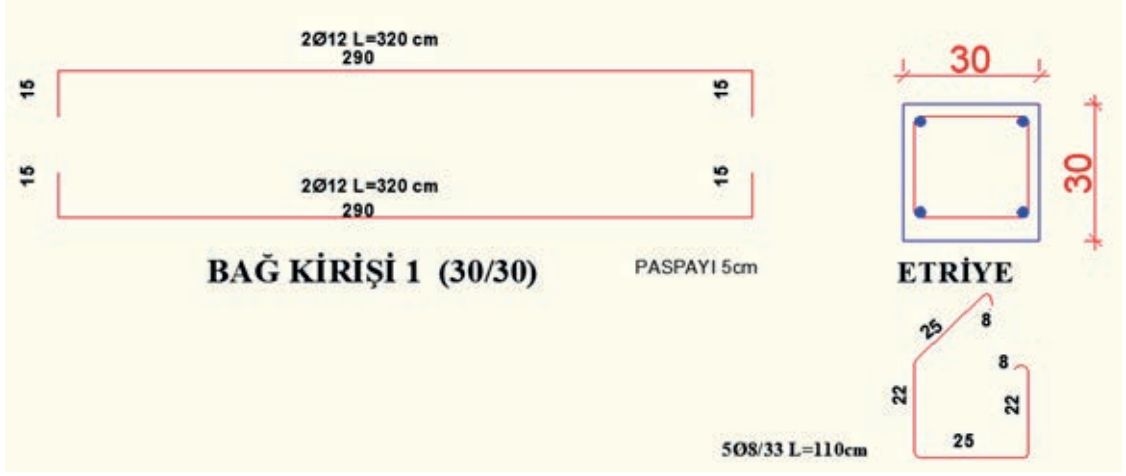
Şekil 14.14: Bağ kirişi 1 donatı açılımı
