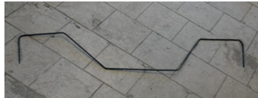
Resim 11.29: Tamamlanmış pilye demir donatısı
