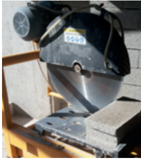
Resim 19.5: Bims blokların spiralle kesilmesi
