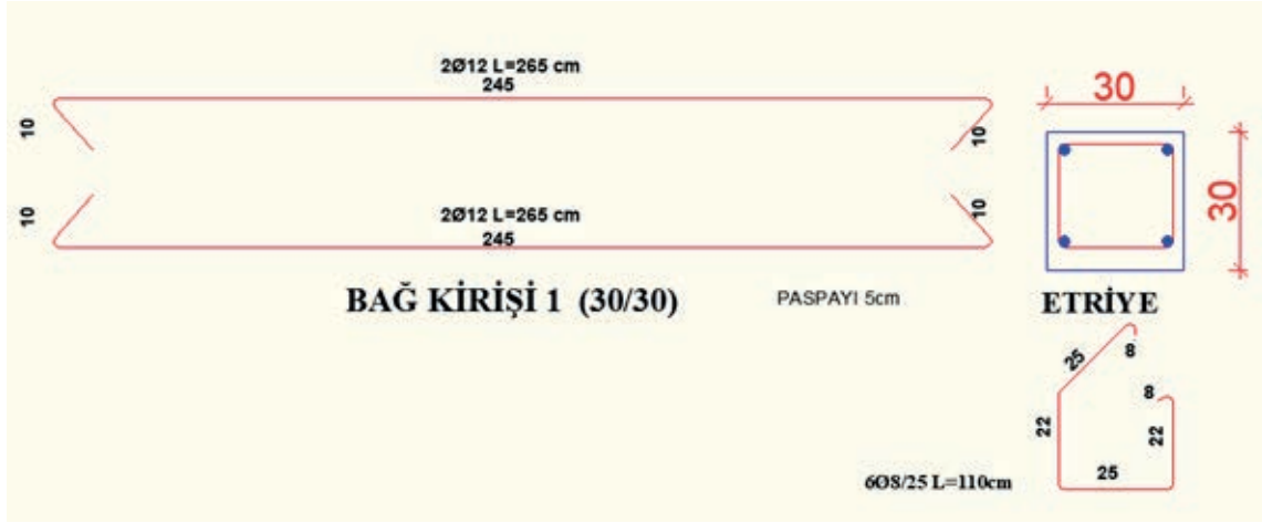
Şekil 14.16: Bağ kirişi 1 donatı açılımı
