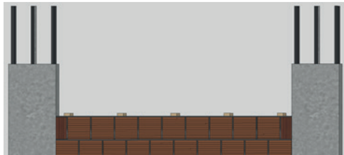
Şekil 4.5: Montaj takozunun duvar üzerine çakılması
