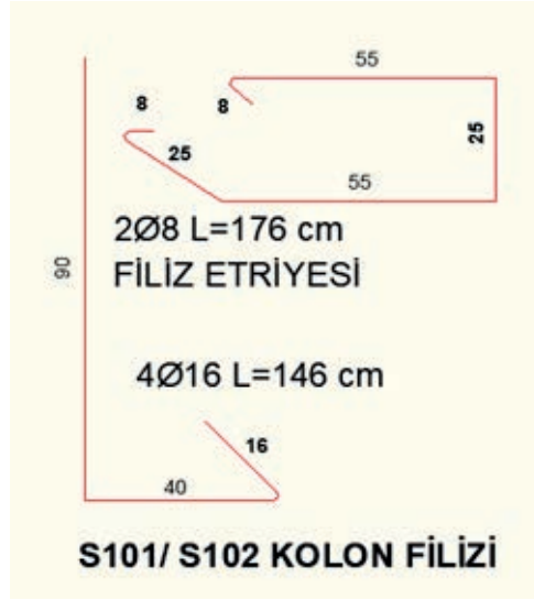
Şekil 14.4: S101 kolon donatı açılımı
