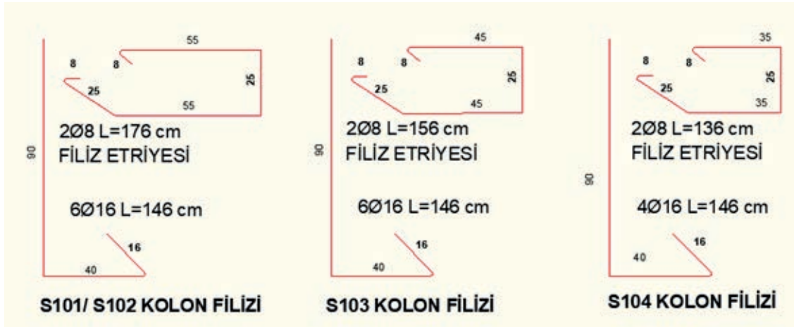
Şekil 14.22: Kolon filiz donatı açılımı
