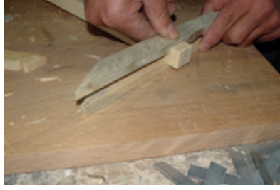
Resim 10.59: Kuşakları dikmelere kertme
