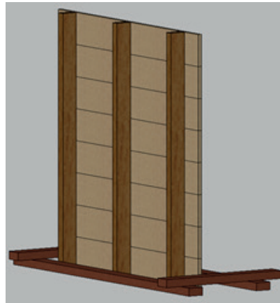
Şekil 3.14: Kalıp yüzey tahtasının aks içerisine sabitlenmesi
