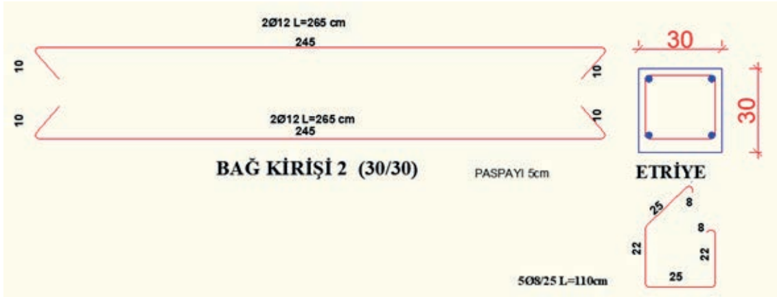
Şekil 14.9: Bağ kirişi 2 donatı açılımı
