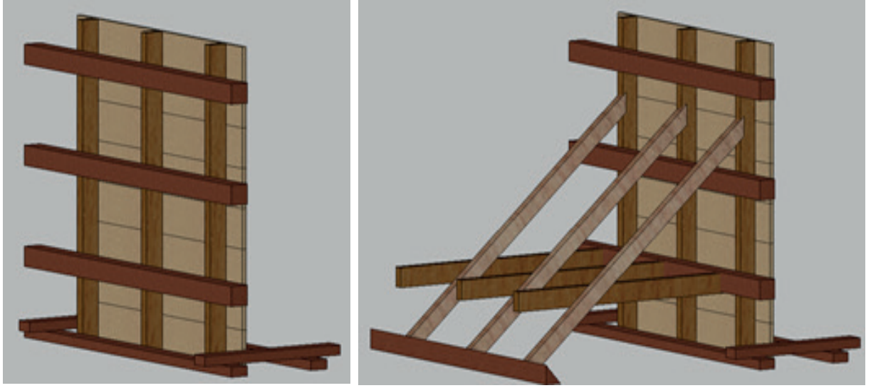
Şekil 3.15: Kalıp yüzey tahtasının şakülüne getirilmesi
