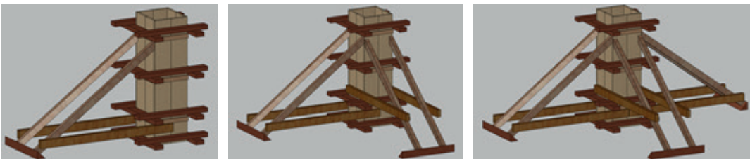
Şekil 3.9: Kolon kalıbının sabitlemesi
