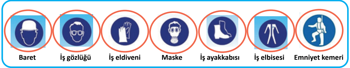
Şekil 7.1: Betonun dökülmesi ve sıkıştırılması esnasında kullanılacak KKD'ler
