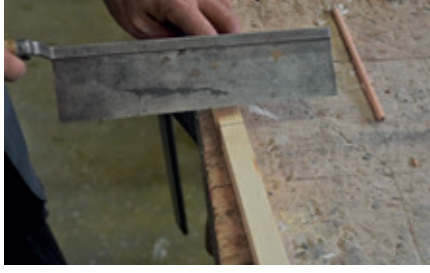
Resim 10.7: Makas dikmelerinin kesilmesi
