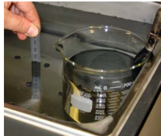
Görsel 6.3: Piknometrenin beher ile su banyosunda bekletilmesi
