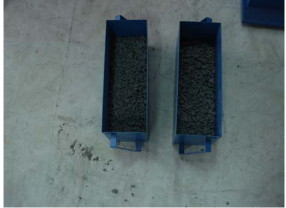
Görsel 2.9: c) Bölgeç aletiyle ayırma yöntemi
