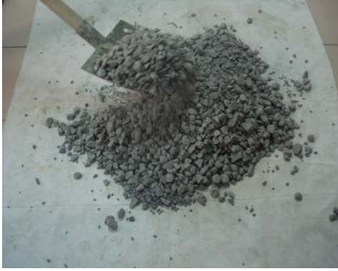
Görsel 2.8: a) Çeyrekleme yöntemi
