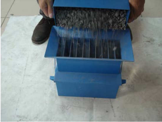
Görsel 2.9: b) Bölgeç aletiyle ayırma yöntemi
