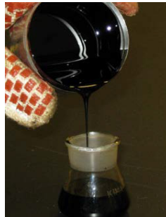
Görsel 6.2: Bitüm numunesinin piknometreye dökülmesi
