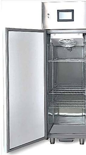
Görsel 4.3: Donma-çözülme test kabini
