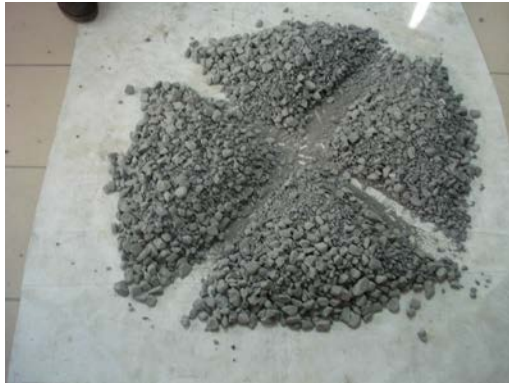
Görsel 2.8: e) Çeyrekleme yöntemi
