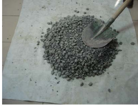
Görsel 2.8: b) Çeyrekleme yöntemi
