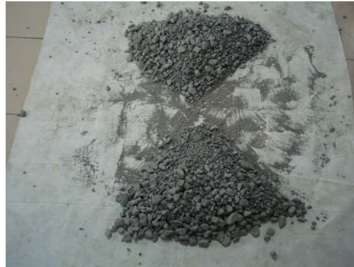
Görsel 2.8: f) Çeyrekleme yöntemi
