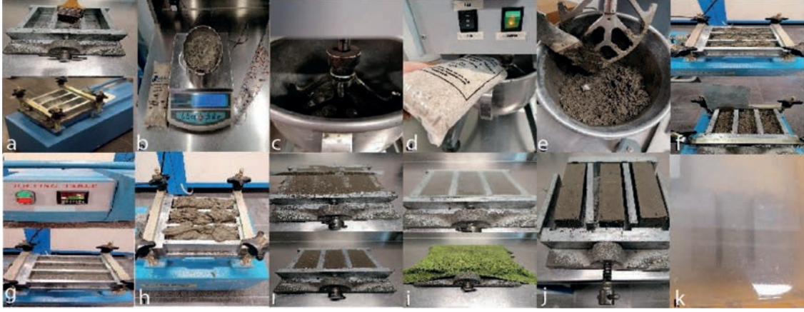
Görsel 15.11: Harcın ve prizmalarının hazırlanması
