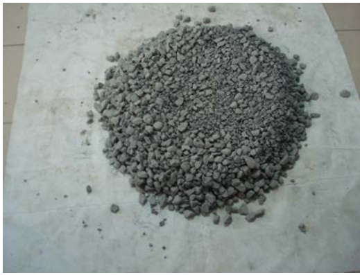
Görsel 2.8: c) Çeyrekleme Yöntemi
