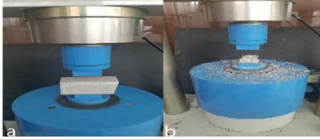
Görsel 15.13: Basınç dayanımının uygulanması
