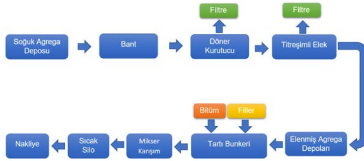
Görsel 8.21: Batch tipi plent üretim şeması
