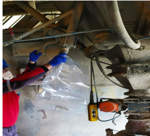
Görsel 10.22: Klapeğin açılarak çimento numunesi alınması
