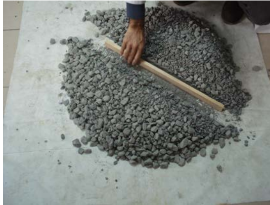
Görsel 2.8: d) Çeyrekleme Yöntemi
