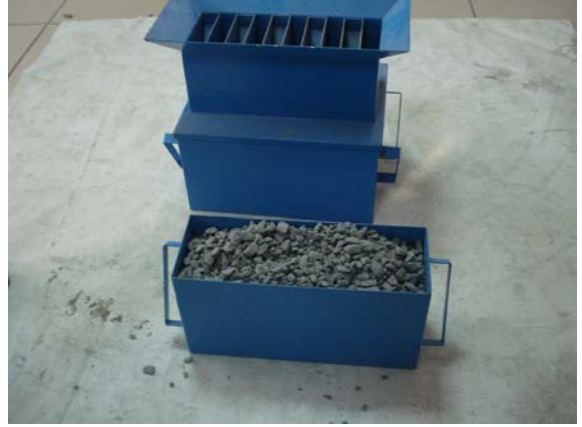
Görsel 2.9: a) Bölgeç aletiyle ayırma yöntemi
