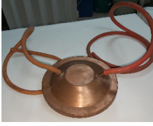
Görsel 8.13: Refluks ekstraktör yoğunlaştırıcısı ve hortumları
