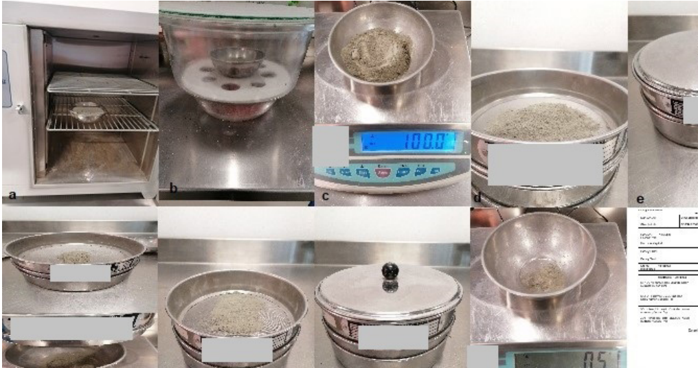
Görsel 15.4: Çimentolarda tane büyüklüğü tayini deneyi (Elle eleme yöntemi)
