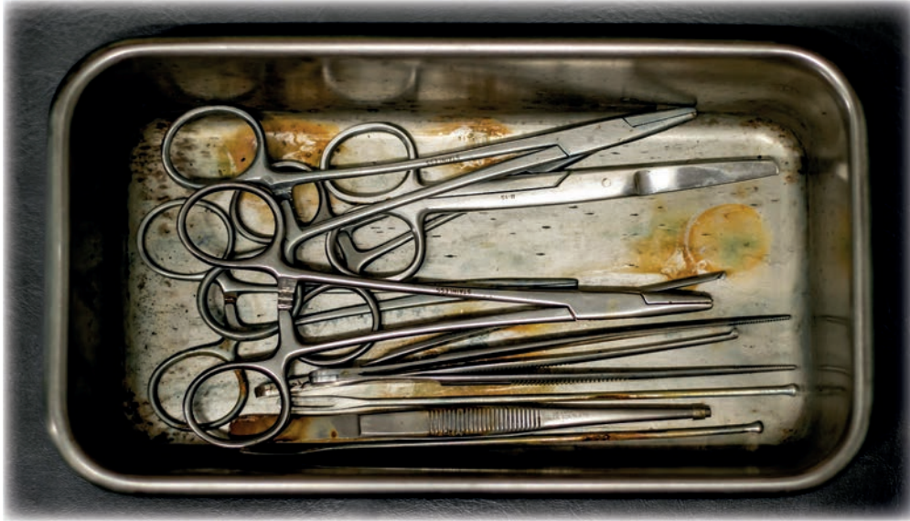
Görsel 4.21: Tıbbi aletlerde korozyon oluşumu
