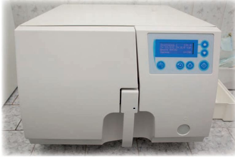
Görsel 4.20: Buhar formaldehit sterilizatörü
