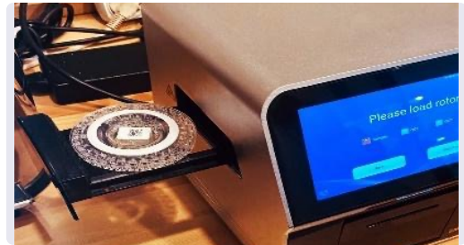
Görsel 8.27: Rotor kitle çalışan biyokimya cihazı
