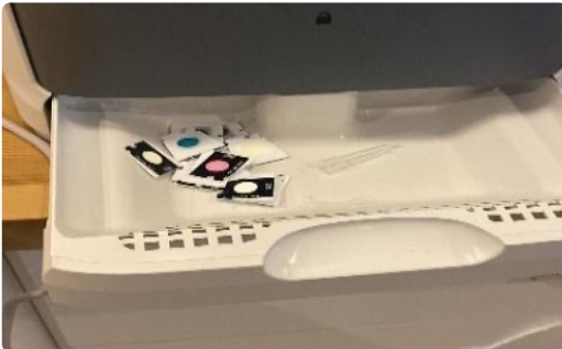
Görsel 8.26: Kuru slayt ile çalışan 24 parametrelilik cihaz
