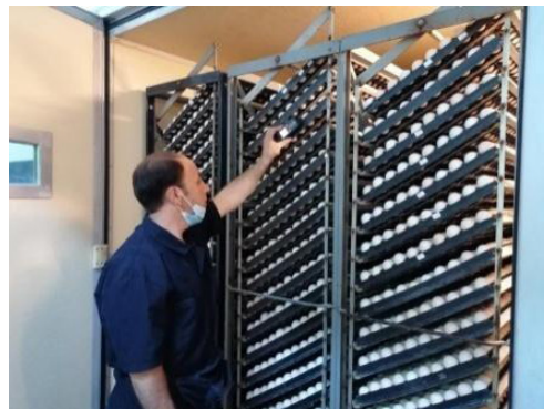
Görsel 12.6: Gelişim makinesinde çevirme açısı ölçümü
