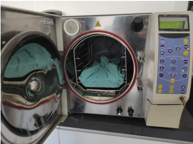
Görsel 4.14: Uygun ebatlarda hazırlanmış paketin otoklava yerleştirilmesi
