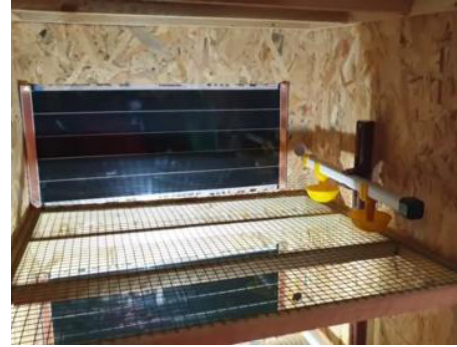
Görsel 13.5: Kafes tipi civciv ana makinesinde kullanılan karbon film ısıtıcı
