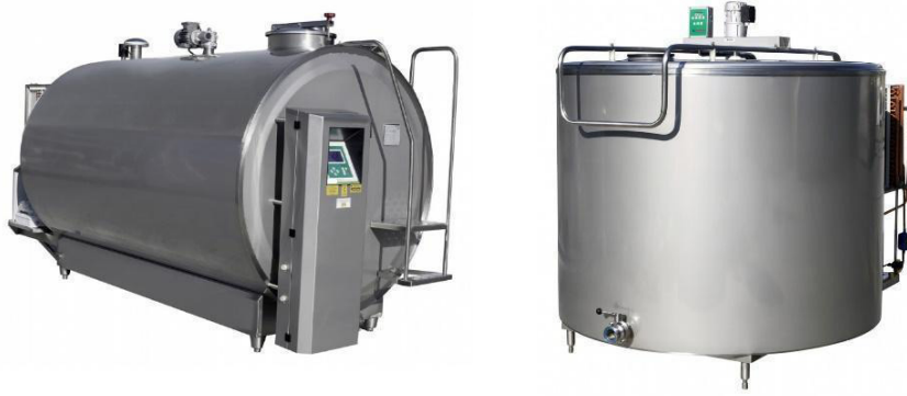
🖼️ Görsel 3.38: Yatay ve dikey tipte soğutucu tanklar
