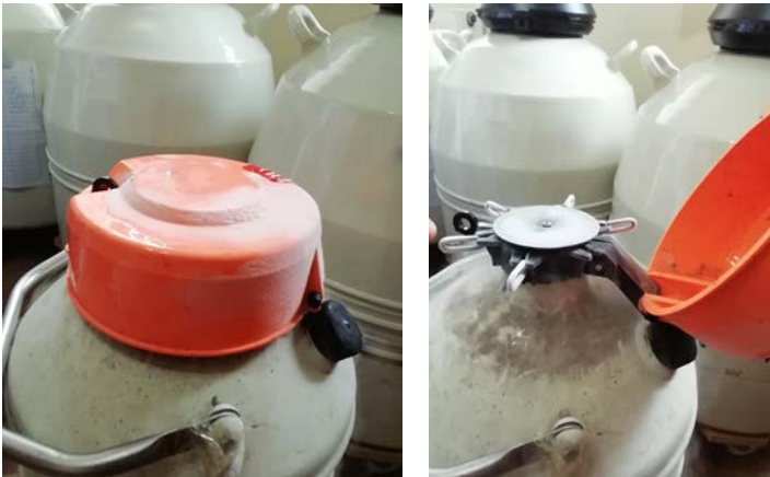
Görsel 1.42: Vakumu bozulmuş konteynerde buzlanma
