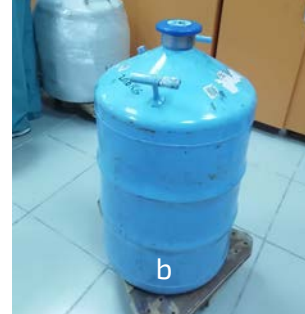
Görsel 1.39: Farklı ebattarda saha ve depo konteyneri (a) ile azot nakliye tankı (b)
