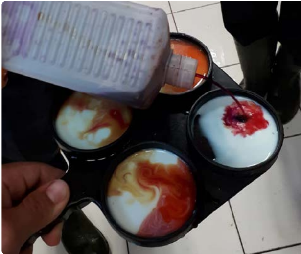
🖼️ Görsel 2.14: CMT testinde kullanılan solüsyonun süt örneğine dökülmesi
