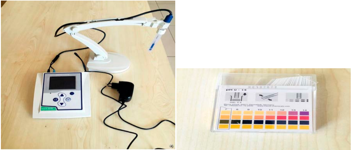
📷 Görsel 4.8: Sütün pH kontrolünün yapılmasında kullanılan masa üstü pH ölçer ve pH metre kâğıtları
