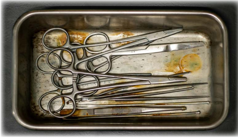
Görsel 4.21: Tıbbi aletlerde korozyon oluşumu
