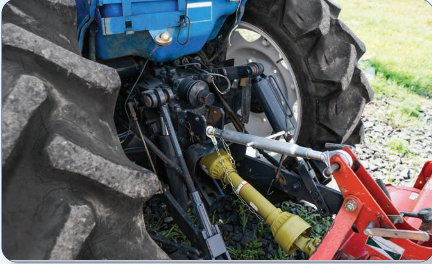
Görsel 1.21: Kuyruk miline tarım makinesinin bağlanması
