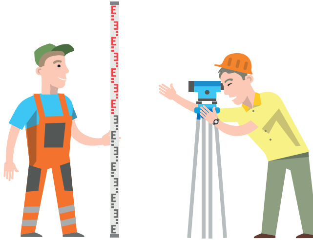
Görsel 7.6: Nivonun miraya yönlendirilmesi
