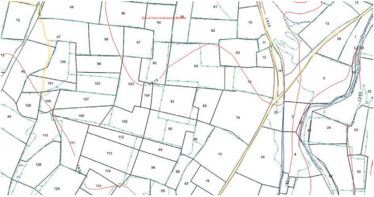
Görsel 3.7: Kadastral altlık ile hâlihazır harita birleştirilmiş proje
