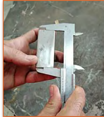
Görsel 3.36: İş parçasının kumpas ile son kontrolü
