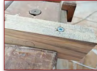
Görsel 4.33: Havşa açılmış iş parçasına vida montajı
