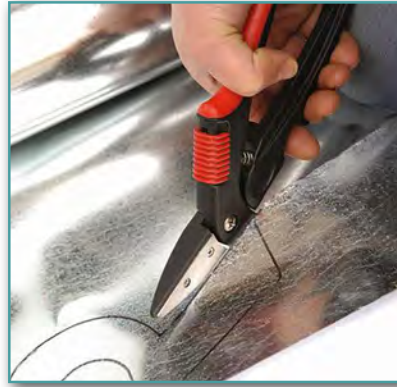
Görsel 7.8: Parçanın metal sac kesme makası ile kesilmesi
