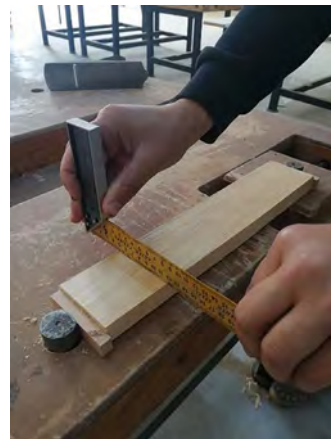
GörSEL 3.17: İş parçasının yüzey kontrolü
