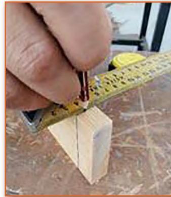
Görsel 3.43: İş parçasının markalanması
