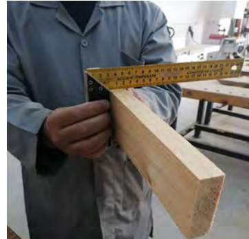
Görsel 3.22: İş parçasının gönye ile son kontrolleri
