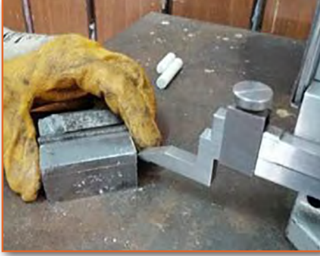
Görsel 3.10: İş parçasının mihengir ile kontrolü
