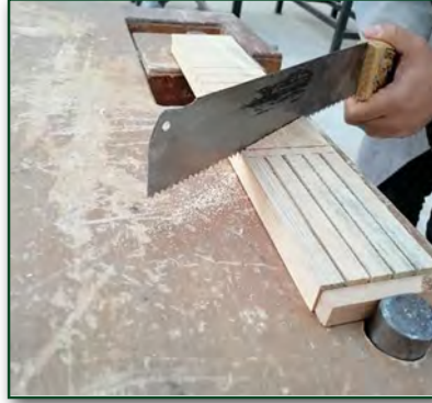
Görsel 2.34: İş parçasının yatay konumda kesilmesi
