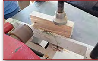
Görsel 4.21: İş parçasının makine tablasına bağlanması
