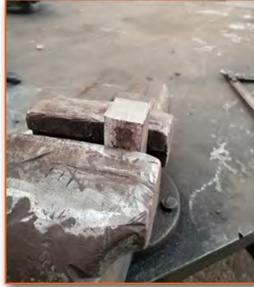
Görsel 3.24: İş parçasının mengeneye bağlanması
