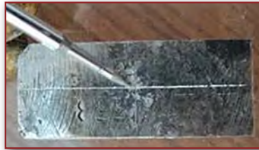
Görsel 4.4: Markalama çizgilerinin belirginleştirilmesi
