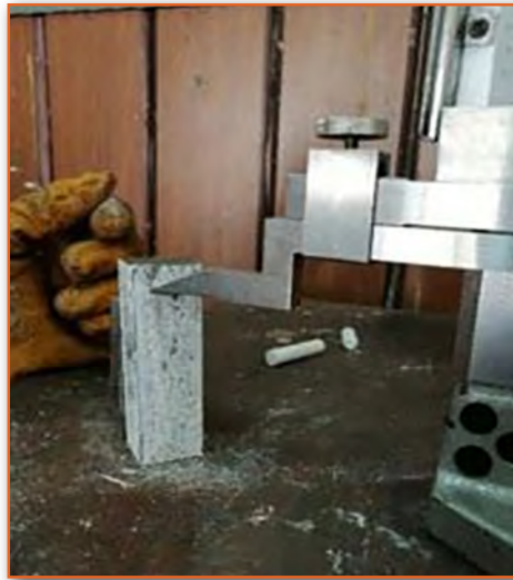
Görsel 3.23: İş parçasının mihengir ile markalanması
