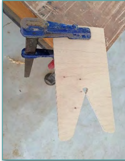
Görsel 7.21: Kıl testere sehпасının marangoz tezgâhına bağlanması
