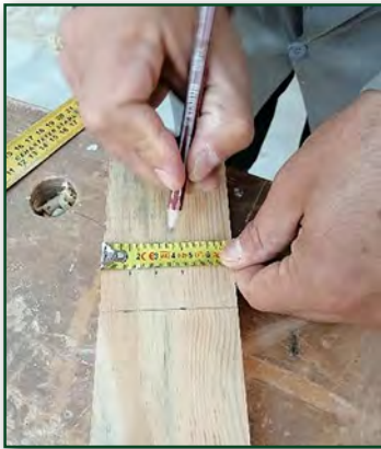
Görsel 2.26: İş parçasının işaretlenmesi
