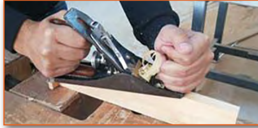
Görsel 3.21: İş parçasının rendelenmesi
