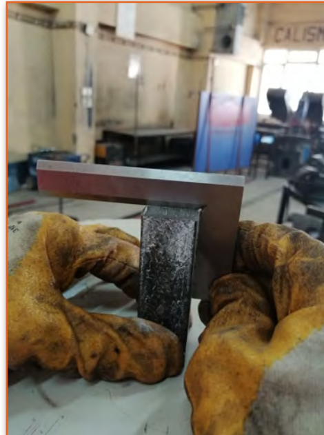
Görsel 3.26: İş parçasının gönye ile kontrolü
