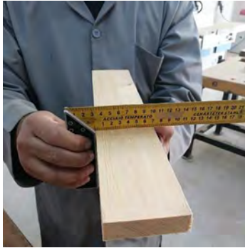
Görsel 3.22: İş parçasının gönye ile son kontrolleri
