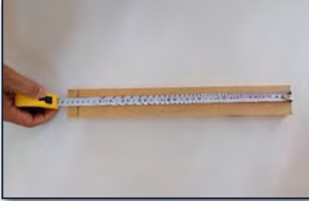
a) Şerit metre ile boy ölçümü
