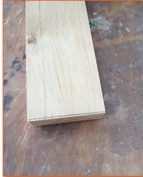
Görsel 3.38: İş parçasının ilk alın kısmının markalanması
