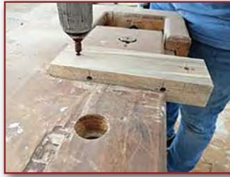
Görsel 4.31: İş parçasına havşa açılması
