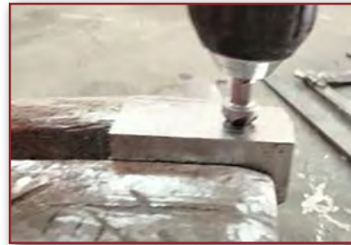
Görsel 4.27: İş parçasına havşa açılması
