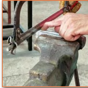
Görsel 3.30: Demir testeresinin iş parçasının üzerine yerleştirilmesi
