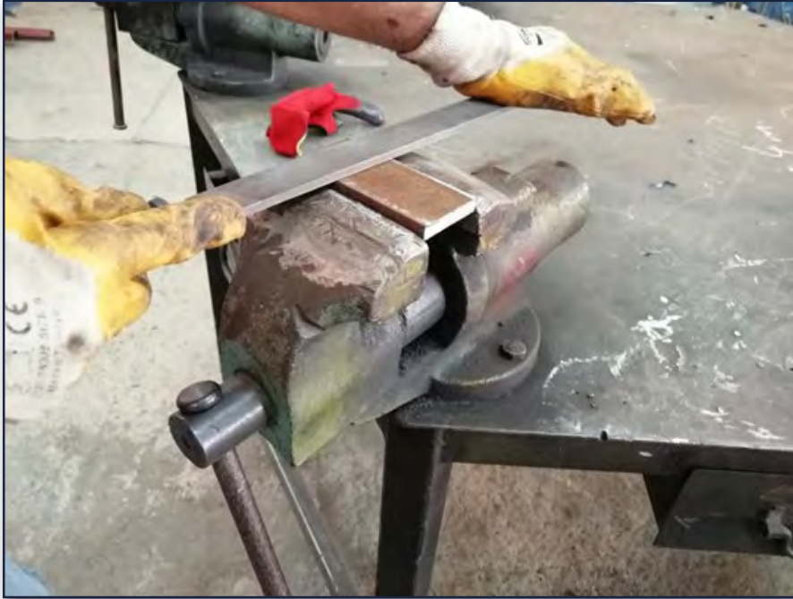
Görsel 1.52: Metal iş parçasını eğleme işlemi
