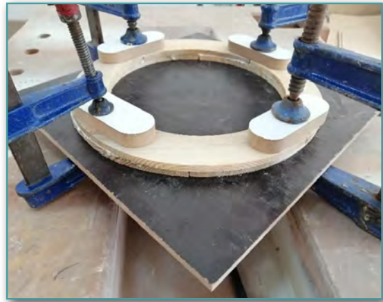
Görsel 7.23: Model parçasının montaj aşamaları
