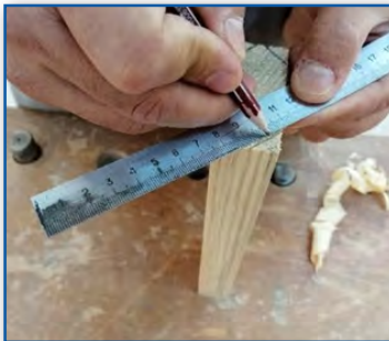
Görsel 5.6: İş parçasının ölçülmesi
