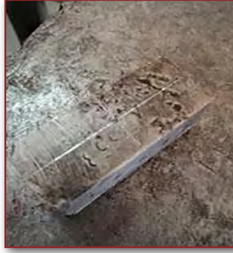
Görsel 4.7: Markalama merkezleri işaretlenmiş parça
