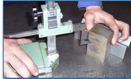
Görsel 5.5: İş parçasının mihengir ile markalanması
