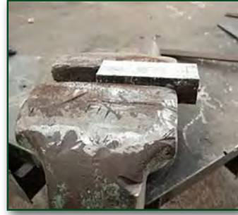
Görsel 2.21: İş parçasının mengeneye bağlanması
