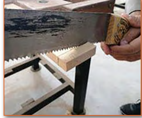
Görsel 3.45: İş parçasının kesilmesi
