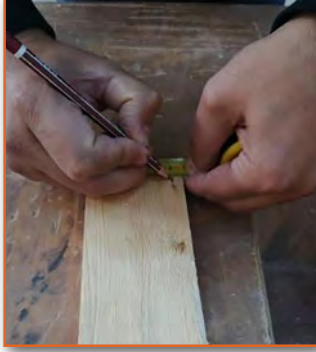
Görsel 3.18: İş parçasının işaretlenmesi
