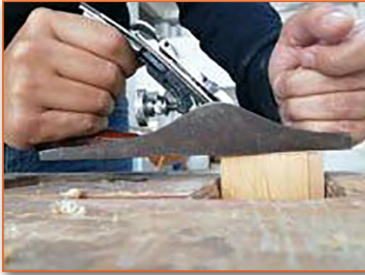
Görsel 3.40: İş parçasının ilk alın kısmının rendelenmesi
