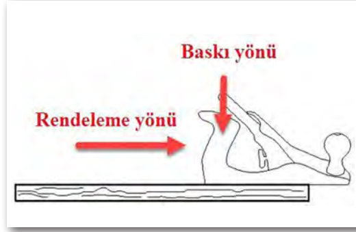
Şekil 3.3: Rende kullanımı (arka baskılama)
