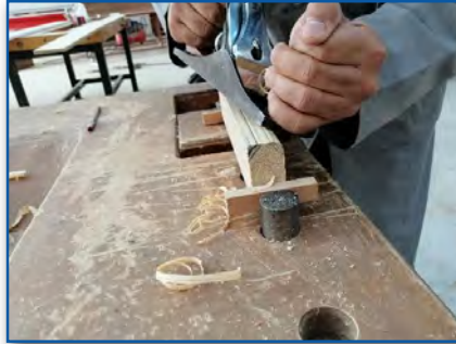
Görsel 5.10: İş parçasına pah açılması
