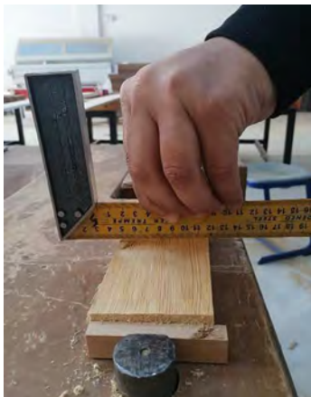
GörSEL 3.17: İş parçasının yüzey kontrolü
