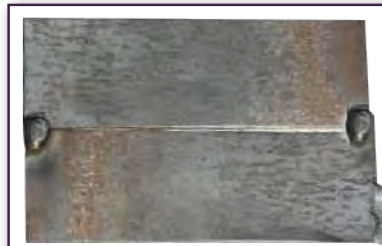
Görsel 6.18: Hatalı çekilmiş punta
