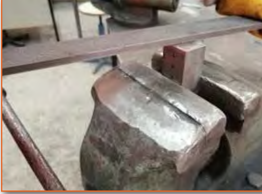
Görsel 3.33: İş parçasının alın kısmının eğelenmesi
