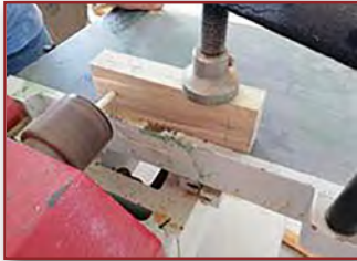
Görsel 4.22: İş parçasının geniş yüzeyinin delinmesi
