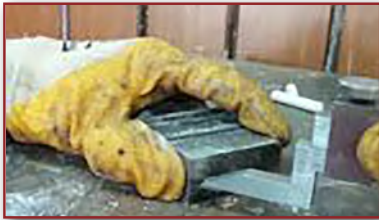
Görsel 4.3: İş parçasının mihengir ile markalanması
