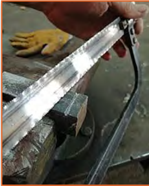
Görsel 3.31: İş parçasının kesilmesi
