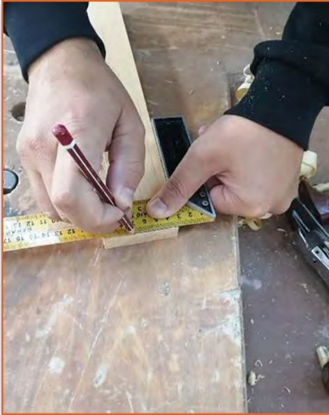
Görsel 3.37: İş parçasının ilk alın kısmının işaretlenmesi
