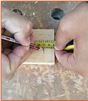
Görsel 3.42: İş parçasının işaretlenmesi
