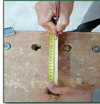
Görsel 2.14: İş parçasının ölçülmesi
