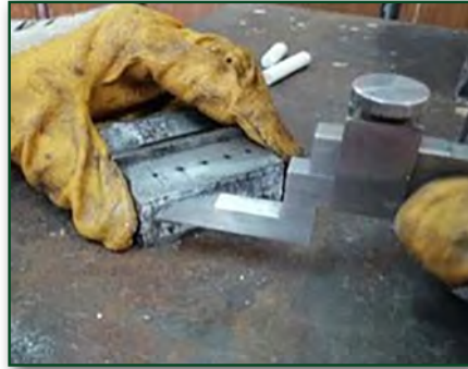
Görsel 2.8: İş parçasının mihengir ile çizilmesi
