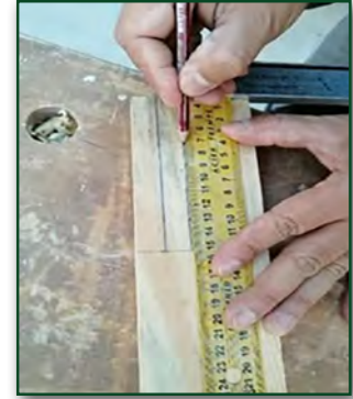
Görsel 2.17: İş parçasının markalanması
