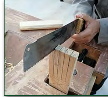
Görsel 2.30: İş parçasının tezgâh mengenesine dikey şekilde bağlanması
