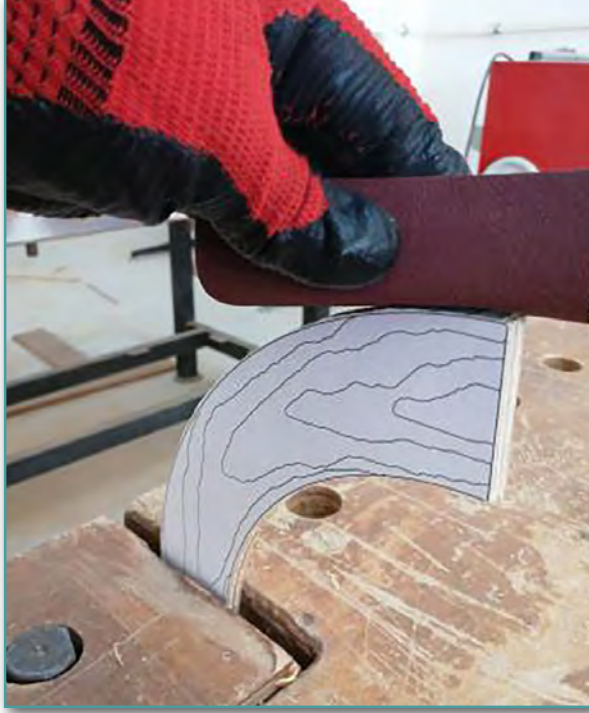
Görsel 7.15: Şablonun kenar fazlalıklarının zımpara ile düzeltilmesi
