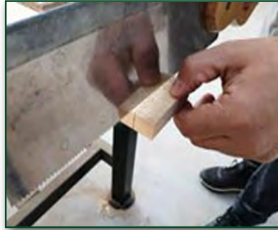
Görsel 2.35: İş parçasının fire kısmına iz yapılması
