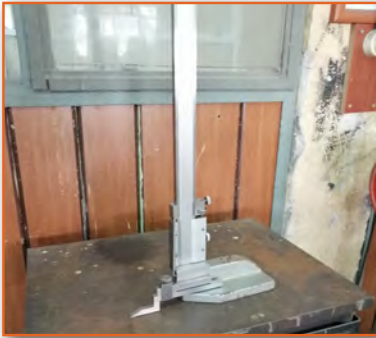
Görsel 3.6: Mihengirin pleyt üzerine yerleştirilmesi
