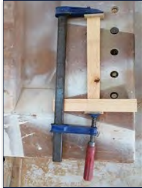
Görsel 1.57: İş parçasının işkence yardımıyla sıkıştırılması
