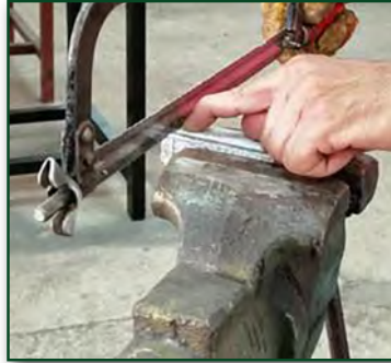
Görsel 2.22: Demir testeresinin iş parçasının üzerine yerleştirilmesi
