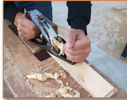
GörSEL 3.16: İş parçasının rendelenmesi
