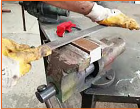
Görsel 3.2: İş parçasının eğelenmesi
