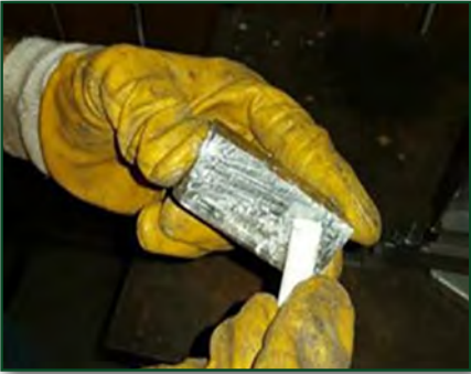
Görsel 2.7: İş parçasının tebeşir ile boyanması
