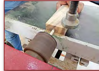
Görsel 4.24: İş parçasının alın kısmının delinmesi
