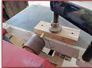
Görsel 4.23: İş parçasının dar yüzeyinin delinmesi
