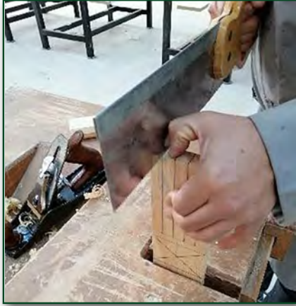
Görsel 2.31: İş parçasına dikey konumda iz yapılması
