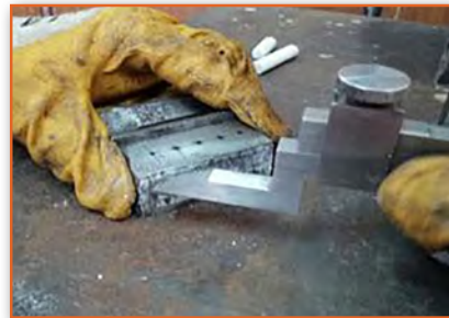
Görsel 3.9: İş parçasının mihengir ile çizilmesi
