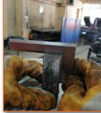
Görsel 3.34: İş parçasının gönye ile kontrolü
