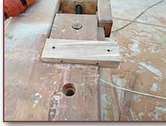
Görsel 4.30: İş parçasının tezgâha bağlanması
