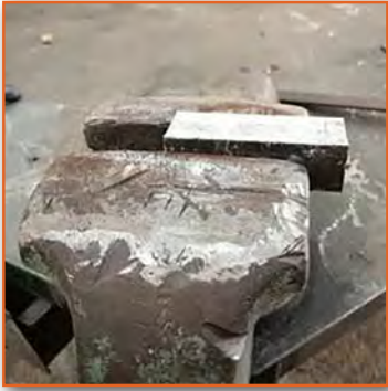
Görsel 3.29: İş parçasının mengeneye bağlanması
