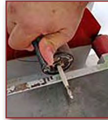
Görsel 4.20: Matkap ucunun yatay delik makinesine bağlanması
