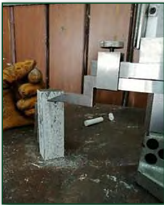
Görsel 2.19: İş parçasının markalanması
