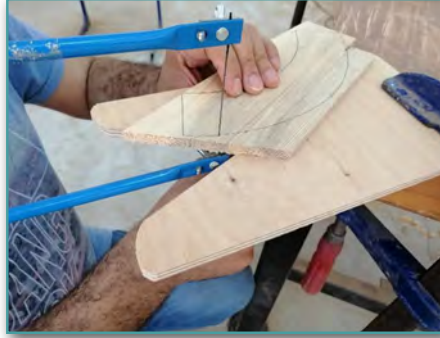
Görsel 7.22: Model parçasının kesimi
