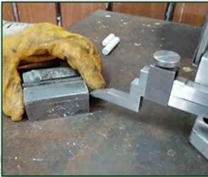
Görsel 2.9: İş parçasının mihengir ile kontrolü
