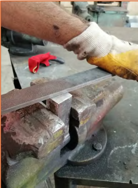
Görsel 3.25: İş parçasının eğelenmesi
