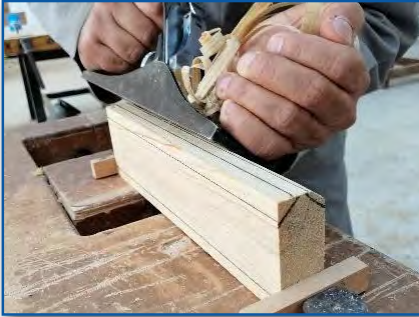
Görsel 5.11: İş parçasına radius açılması
