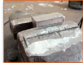
Görsel 3.1: İş parçasının mengeneye bağlanması
