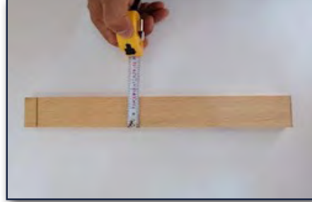
b) Şerit metre ile en ölçümü
