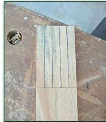
Görsel 2.27: İş parçasının markalanması
