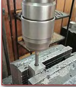
Görsel 4.13: İş parçasının dikey konumda delinmesi
