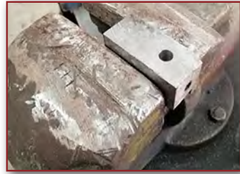
Görsel 4.25: İş parçasının mengeneyle bağlanması
