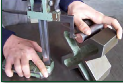
Görsel 2.11: Yuvarlak iş parçasının markalanması
