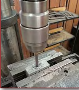
Görsel 4.12: İş parçasının yatay konumda delinmesi
