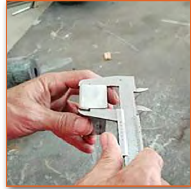
Görsel 3.13: İş parçasının kumpas ile son kontrolü
