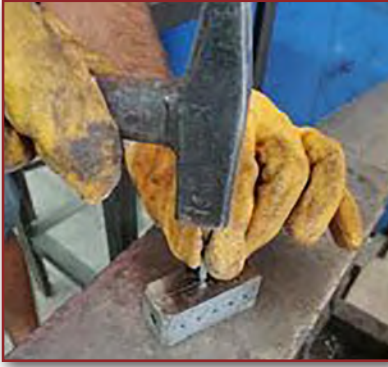
Görsel 4.6: Markalama merkezlerinin nokta ile işaretlenmesi
