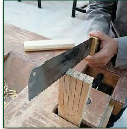
Görsel 2.32: İş parçasının dikey konumda kesilmesi
