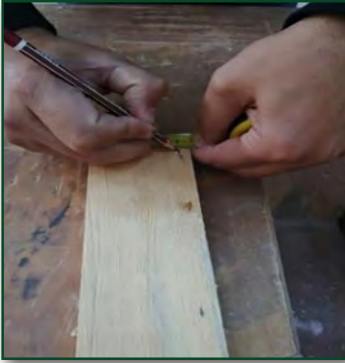
Görsel 2.15: İş parçasının işaretlenmesi
