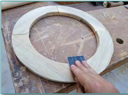
Görsel 7.27: Zımpara ile yüzey temizliği
