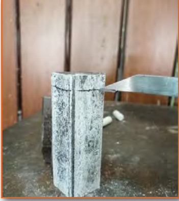
Görsel 3.27: İş parçasının mihengir ile markalanması
