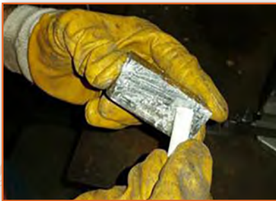
Görsel 3.8: İş parçasının tebeşir ile boyanması
