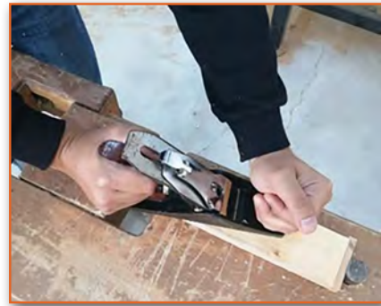
Görsel 3.15: Rendenin ön kısmına baskı uygulanması
