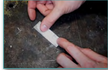
Görsel 7.7: Şablon resminin iş parçası üzerine yapıştırılması
