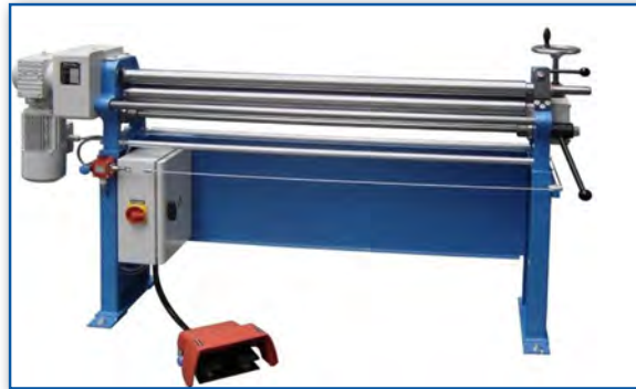
Görsel 5.2: Elektrikli, üç toplu silindir makinesi
