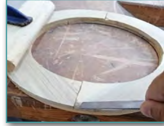
Görsel 7.25: Tutkal artıklarının temizlenmesi
