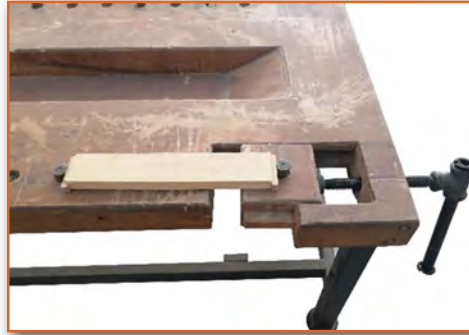
Görsel 3.14: İş parçasının tezgâha bağlanması
