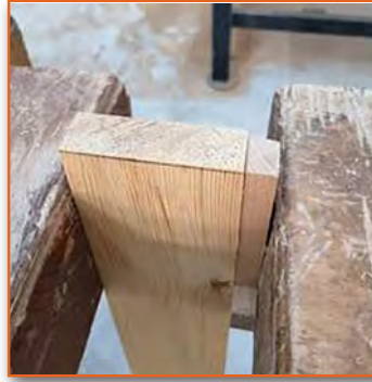
Görsel 3.39: İş parçasının tezgâha bağlanması
