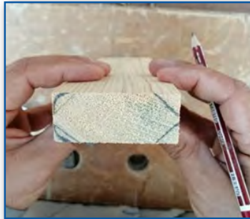
Görsel 5.7: İş parçasının markalanması
