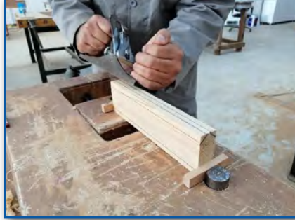
Görsel 5.9: İş parçasının tezgâha bağlanması ve rendelenmesi
