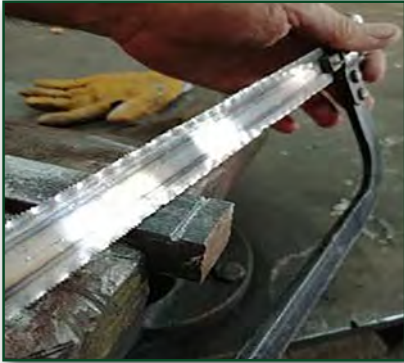
Görsel 2.23: İş parçasının kesilmesi
