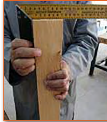
Görsel 3.41: İş parçasının gönye ile kontrolü
