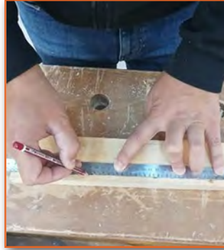
Görsel 3.19: İş parçasının markalanması
