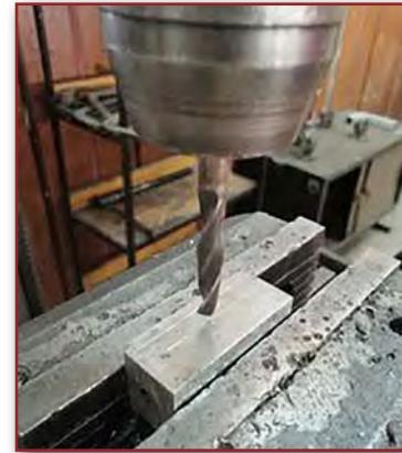
Görsel 4.11: İş parçasının mengeneye bağlanması
