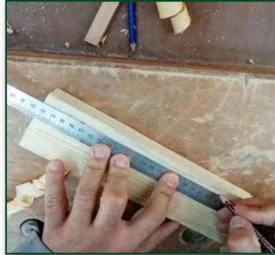
Görsel 2.16: İş parçasının ölçülmesi
