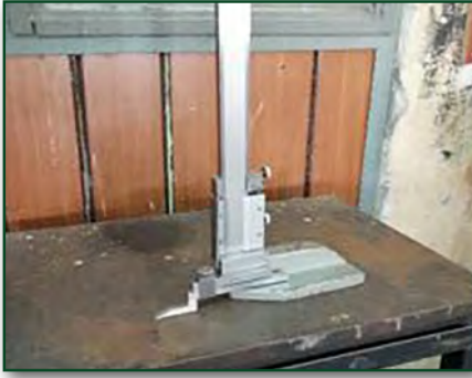
Görsel 2.5: Mihengirin pleyt üzerine yerleştirilmesi
