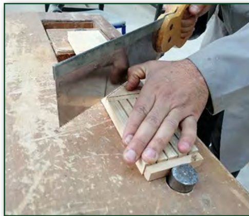
Görsel 2.33: İş parçasına yatay konumda iz yapılması
