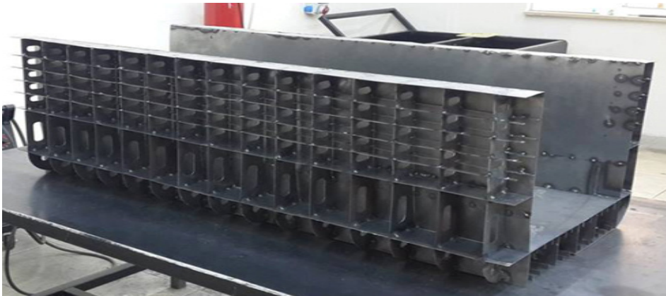
Görsel 3.2: Postaların döşeklere montajlanması
