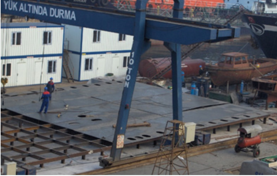
Görsel 1.11: Jig üzerinde tank top sacı
