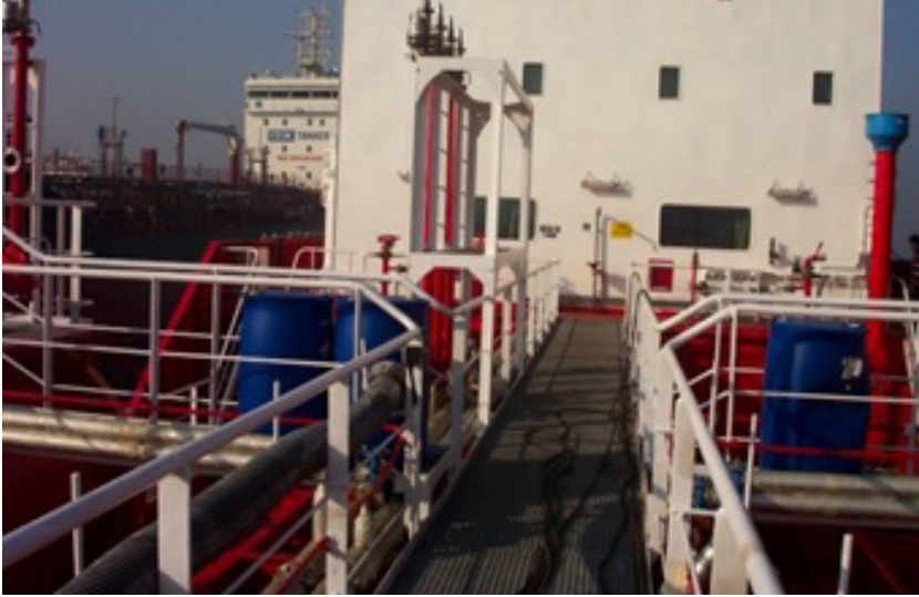
Görsel 6.17: Kedi köprüsü ve vardavela
