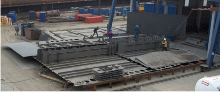
Görsel 1.4: İç dip kaplaması üzerine kaynatılan Hollanda profili ve yan iç tulani
