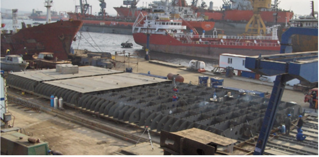
Görsel 1.15: Double bottom tankının sacının sarılması hazırlığı.
