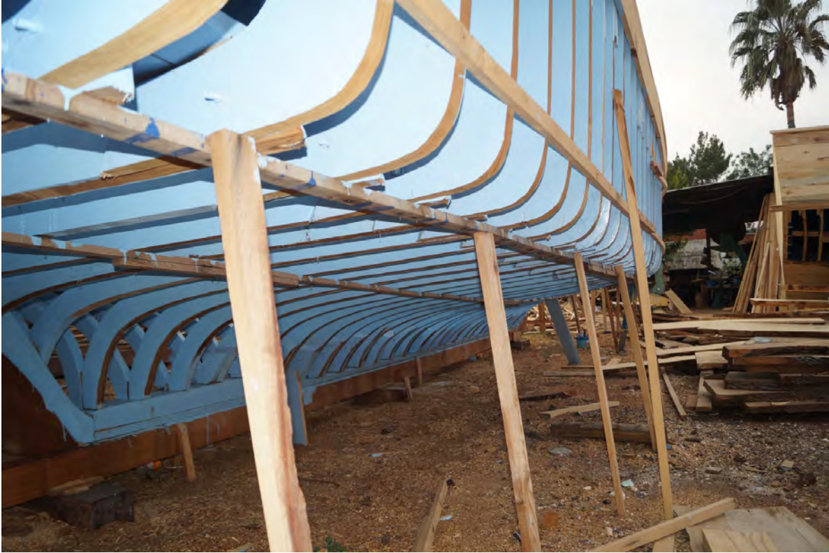
Görsel 2.21: Postaların çita ile tutturulması
