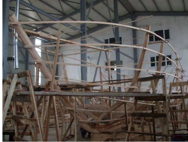
Görsel 3.2: Form çitalarının hazırlanması
