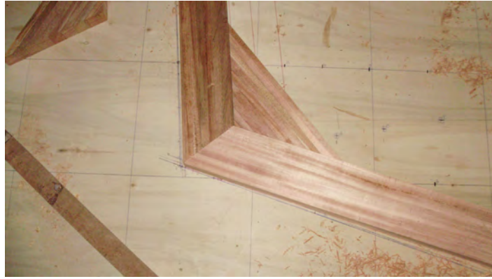
Görsel 2.7: Postaların kesildikten sonra kontrol edilmesi
