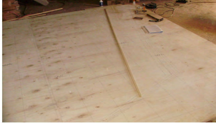
Görsel 2.6: Posta kalıplarının kontrplak üzerine çizilmesi
