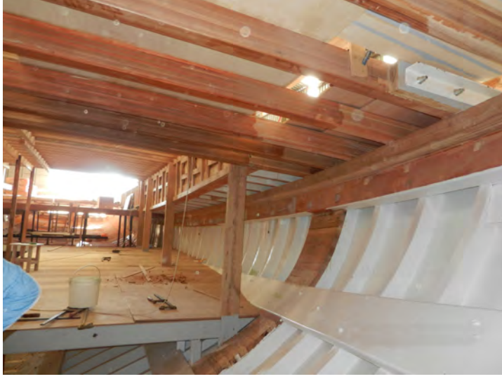
Görsel 8.9: Farş kemerelerinin üzerinin kaplanması
