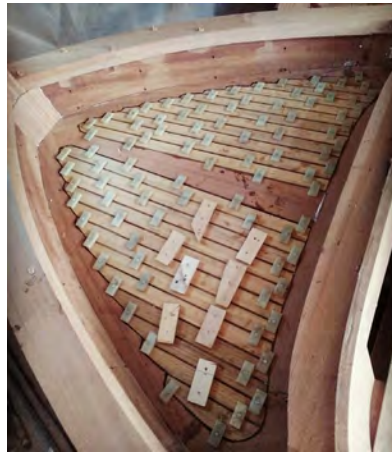
Görsel 6.4: Derz boşluklarının plastik parçalarla yüzeye yapıştırılması
