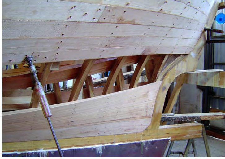
Görsel 5.7: Dış kaplamaların alıştırılması ve montajı
