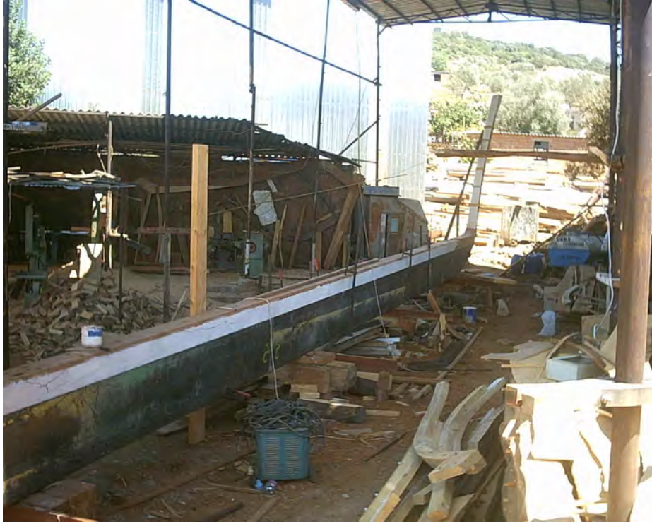
Görsel 1.9: Salma omurganın cıvata ile birleştirilmesi
