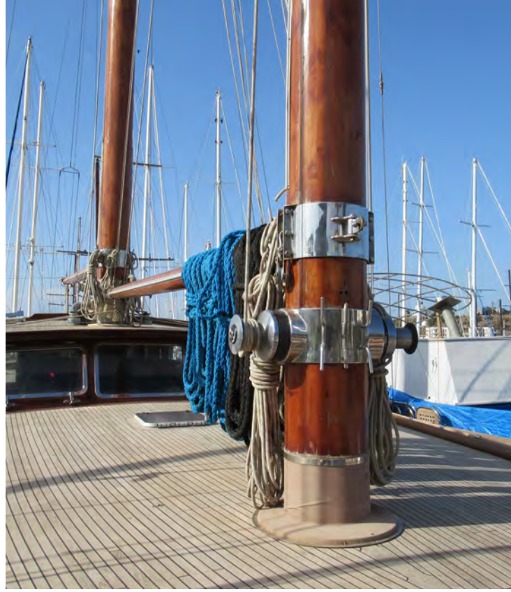
Görsel 7.8 : Güverte üzerine yelken direği montajı
