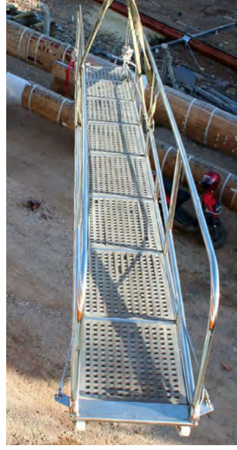
Görsel 7.3: Krom ve ahşap ile imal edilmiş pasarella
