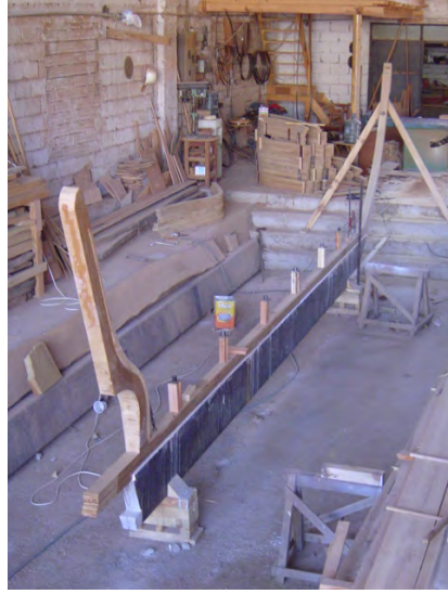
Görsel 1.12: Baş kiç bodoslama montajı
