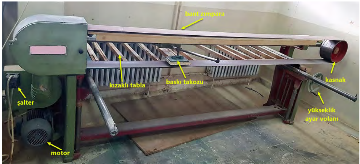
Görsel 7.4: Bant zımpara makinesi ve kısımları
