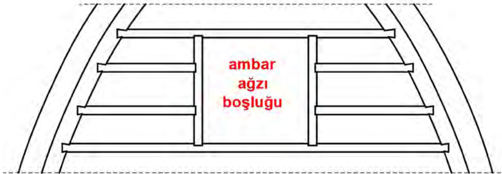
Şekil 6.1: Ambar ağız boşluğunun oluşturulması
