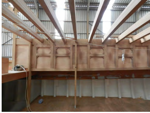
Görsel 8.6: Kamara kemerelerinin yan atkıya montajı
