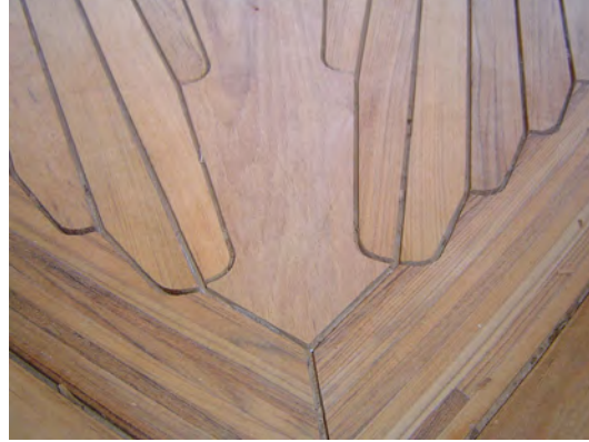
Görsel 6.3: Kenardan merkeze güverte kaplaması
