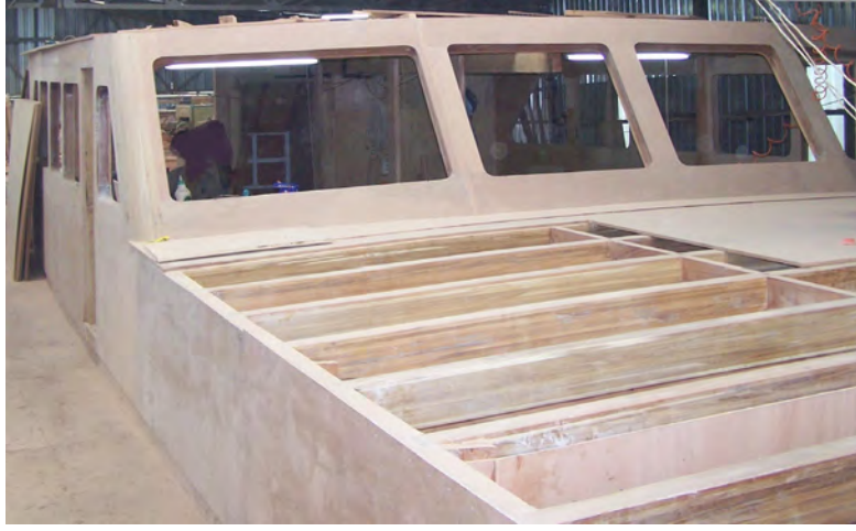
Görsel 11.4: Kaptan köşkü yan kaplamaları montajı
