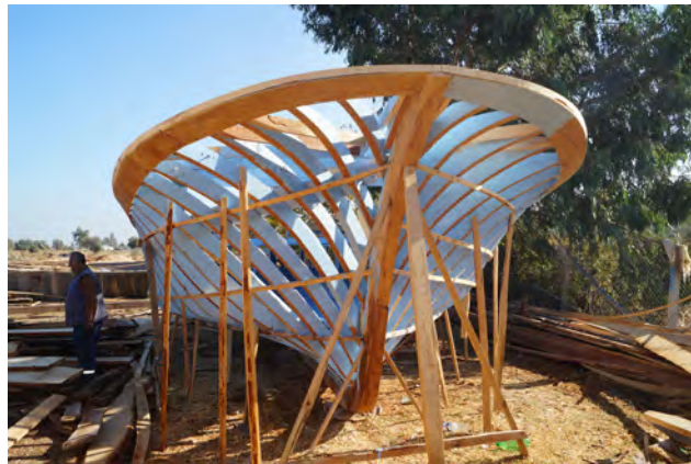
Görsel 2.2: Ahşap postaları oluşturulmuş tekne inşası
