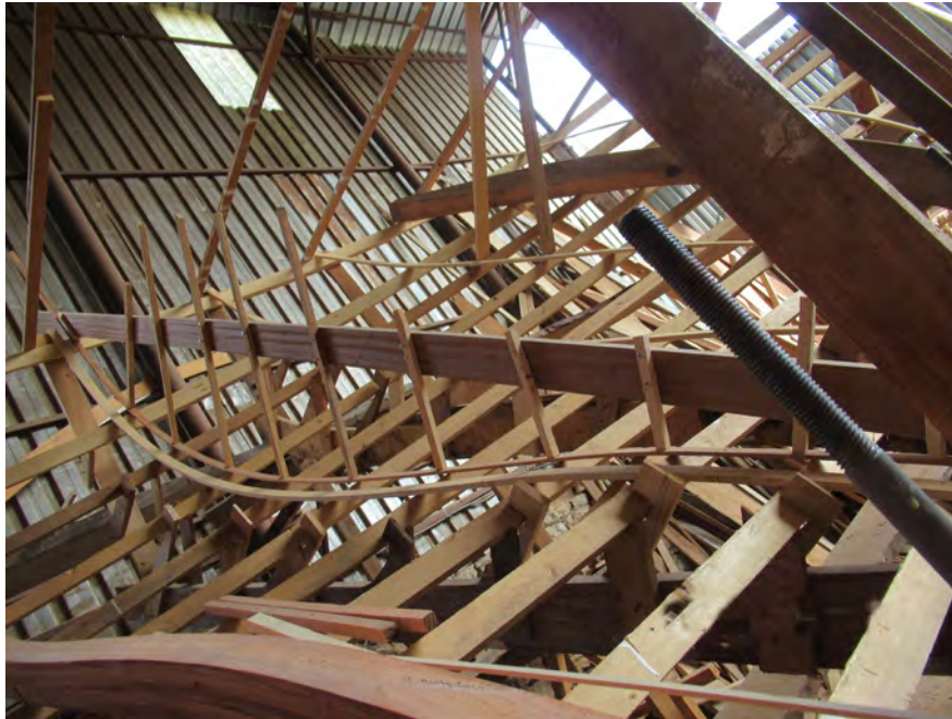
Görsel 2.9: Posta kalıplarının alınması
