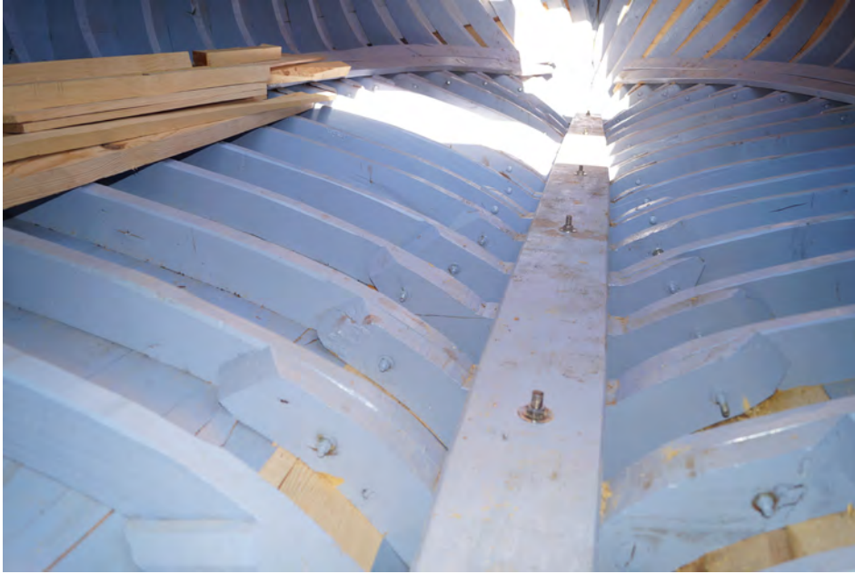
Görsel 2.25: Sotroponun civatalar ile sıkıştırılması
