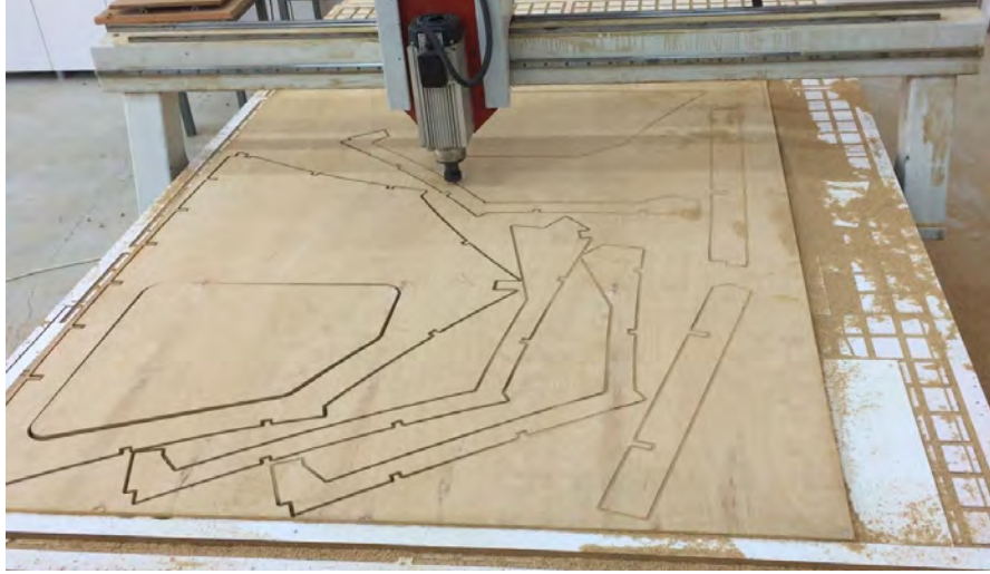
Görsel 2.5: Postaların CNC router ile kesimi
