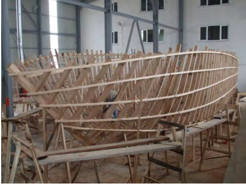
Görsel 3.3: Form çıtaları ile tekne yüzeyinin kontrolü
