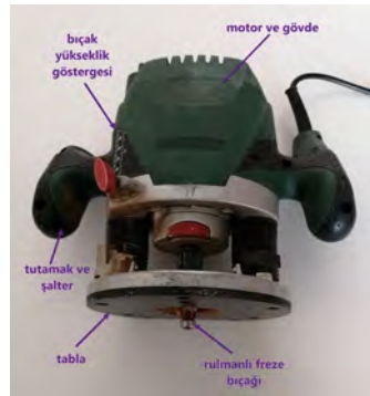
Görsel 5.5: El freze makinesi ve kısımları
