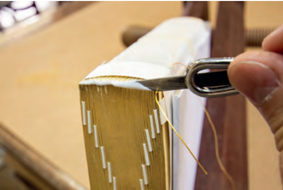
Görsel 2.128: İp için yapışkan sürme
