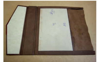
Görsel 3.130: Yapıştırma işlemi tamamlanmış mikleb yan kâğıdı
