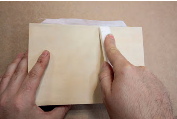
Görsel 2.180: Yapıştırılan bölümleri isteka ile pekiştirme
