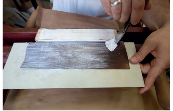
Görsel 3.149: Muhat iç yüzeyine tutkal sürme
