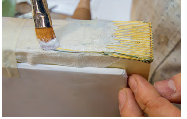
Görsel 2.167: Şiraze iplerinin yapıştırılması
