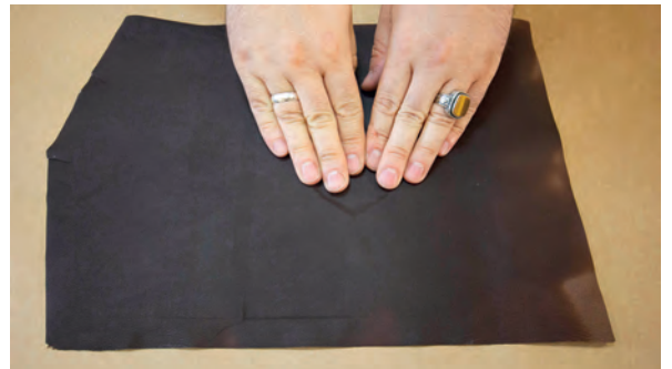
Görsel 3.46: Kalıp yuvalarını parmakla belirginleştirme
