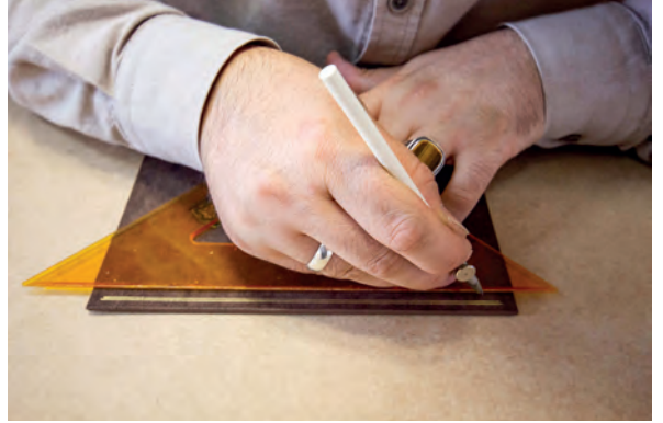
Görsel 3.120: Kitap kenarındaki işaretler üzerine cetvel yerleştirme
