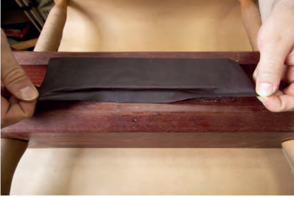
Görsel 3.169: İz yapılan kenardan tutarak deriyi kaldırma
