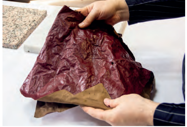
Görsel 1.45: Islatılmış derinin sıkılması
