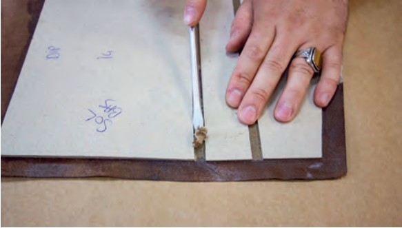
Görsel 3.64: Boşlukların tornavida ile temizlenmesi
