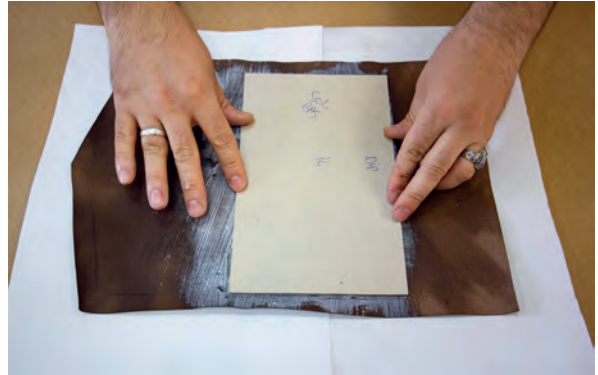
Görsel 3.40: Sol kap murakkasını deri üzerine yapıştırma
