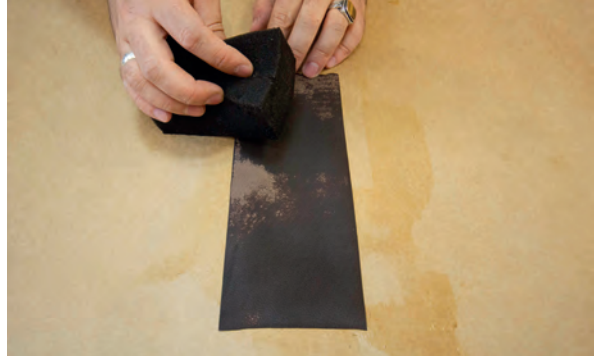
Görsel 3.99: Sertab içi derisinin nemlendirilmesi
