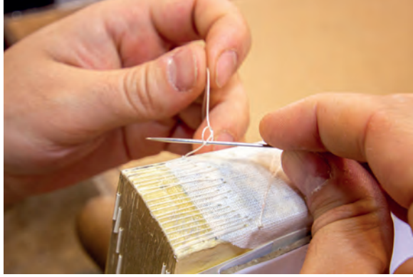
Görsel 2.119: Kolon ipinin sabitlenmesi
