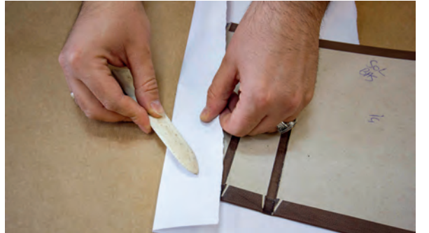
Görsel 3.89: İstekayı yapışan yüzey üzerinde gezdirme
