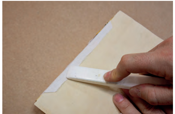
Görsel 2.182: Sırt bezini yan kâğıdının üzerine yapıştırma
