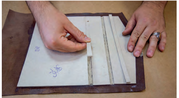
Görsel 3.62: Çıtaların yerlerinden çıkarılması
