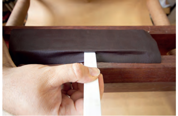
Görsel 3.168: Deri üzerinden iz yapımı
