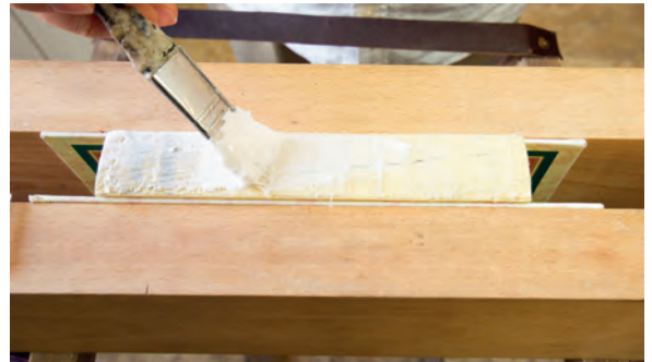
Görsel 2.104: Kitabın sırtına yapıştırıcı sürme
