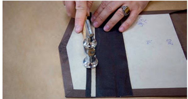
GörSEL 3.107: Çıtaları yerine yerleştirmek için çekiçle vurma
