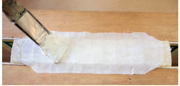
Görsel 2.107: Sırt bezinin üzerine yapıştırıcı sürme
