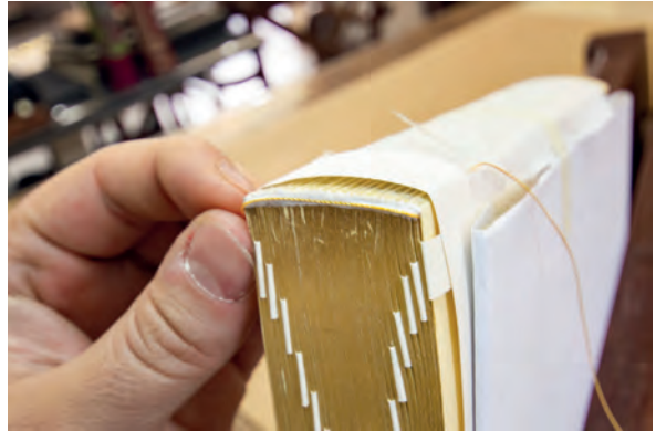
Görsel 2.129: Şiraze ipinin tutturulması
