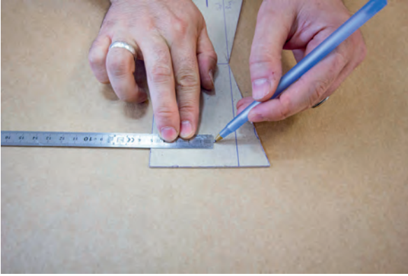
Görsel 2.265: Ölçüyü murakka üzerinde karşıya taşıma
