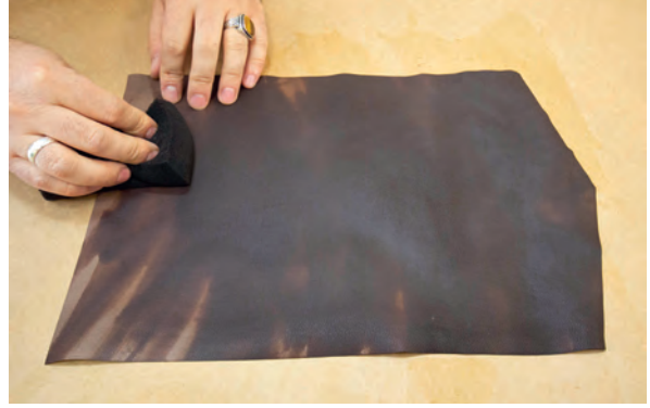
Görsel 3.38: Kapak derilerinin nemlendirilmesi
