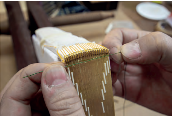
Görsel 2.148: Kitap üzerinde ölçerek ip uzunluğu ayarlama
