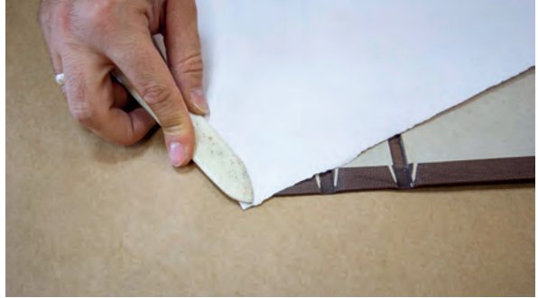
Görsel 3.94: İsteka yardımı ile köşenin kâğıt altında yapıştırılması
