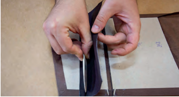
GörSEL 3.103: Sertab içi derisini dudak payı içine yerleştirme
