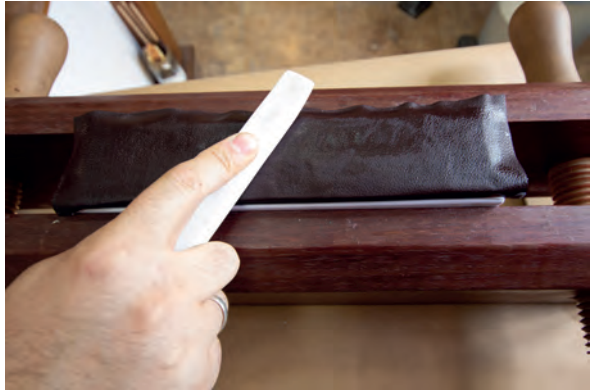
Görsel 3.178: Deriyi isteka ile sirta yapıştırma
