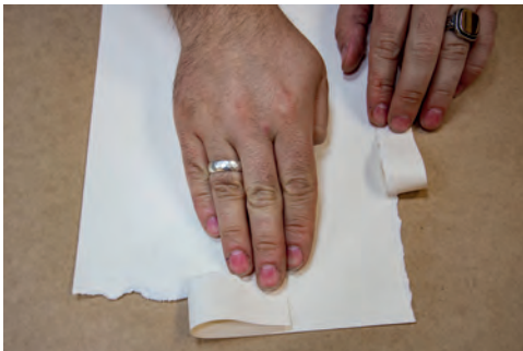
Görsel 2.13: Kâğıdın su yönünün tespiti
