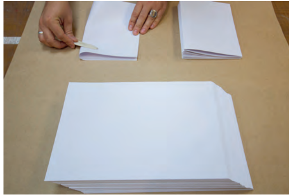
Görsel 2.34: Formaların katlanarak hazırlanması isteka ile kâğıdı katlama
