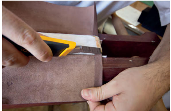
Görsel 3.144: Muhat kenarlarının katlı kısımlarının kesilmesi
