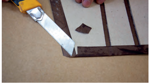
Görsel 3.75: Köşe kısmı kesilmiş kıvrıma payı
