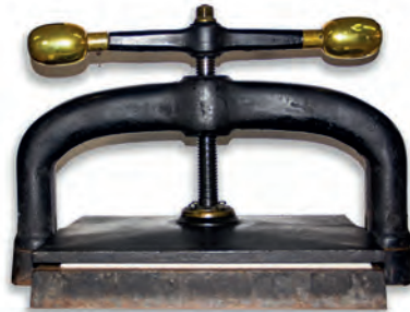
Görsel 1.5: El ile çalışan metal pres örneği
