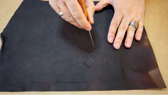
Görsel 3.47: Deri altında kalan havayı çıkarma
