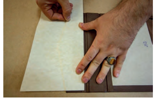
Görsel 3.125: Mikleb kenarına tırnakla baskı uygulama
