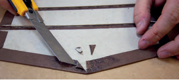
Görsel 3.96: Mikleb ucundaki katların çıkartılması ve yapıştırılması
