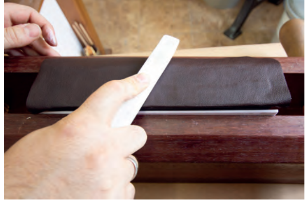
Görsel 3.167: Yapışan deriyi isteka ile düzeltme
