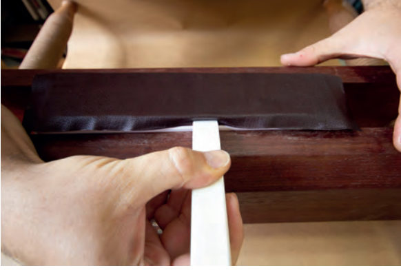
Görsel 3.179: Dip kısmın derisini isteka ile yerleştirerek yapıştırma
