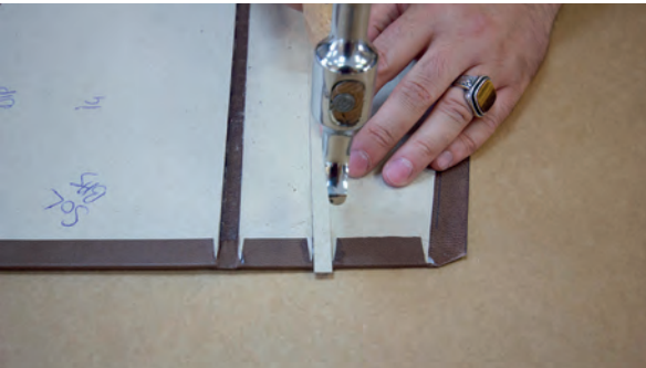
Görsel 3.80: Dudak paylarının içinden çıkarılan çıtalari yerine yerleştirilmesi
