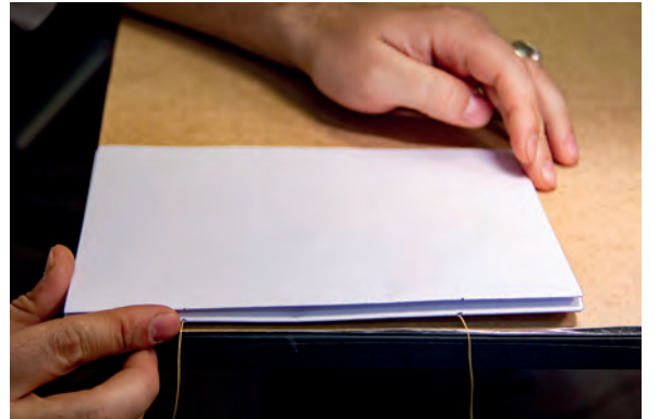
Görsel 2.49: İkinci formanın yerleştirilmesi
