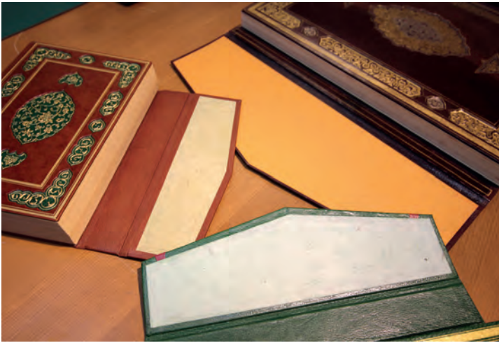
Görsel 3.109: Kenar kıvrırma işlemi yapılmış, sertab içi derisi yapıştırılmış kapak (Selman Küçükkömürler koleksiyonu)
