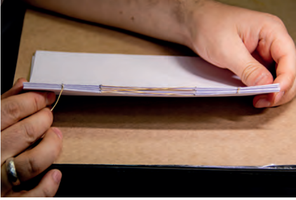
Görsel 2.89: Dikiş işlemi tamamlanmış formaların sırt görünümü
