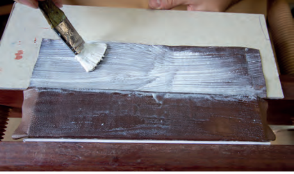
Görsel 3.174: Fazla kısımları kesilen derinin iç kısmına tutkal sürme
