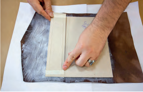
Görsel 3.42: Sertab murakkasının yapıştırılması
