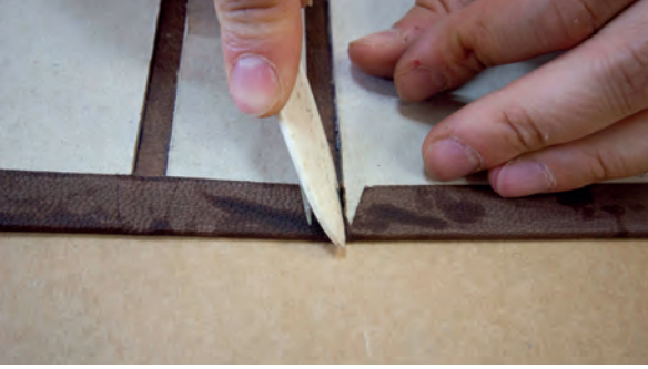
Görsel 3.78: Kesilen bölümü dudak payı içine yerleştirme
