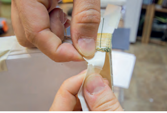
Görsel 2.165: Kolon altında kalan kâğıt şeridin koparılması
