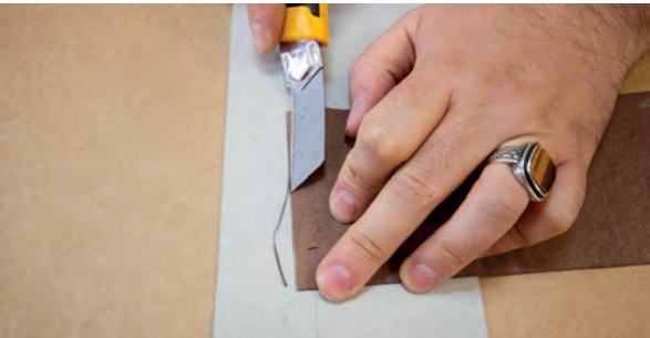
Görsel 3.98: Sertab içi derisinin baş ve etek kısmının pahlı kesimi
