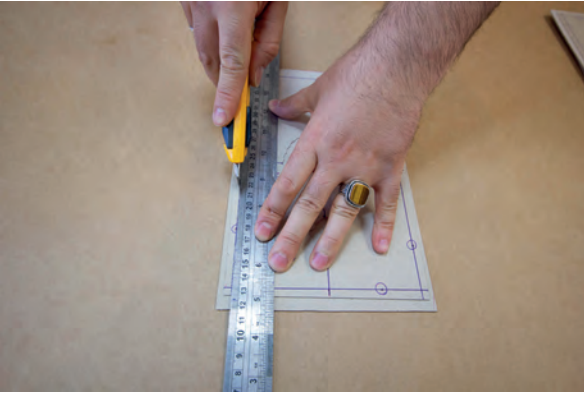
Görsel 2.257: Murakkaları kenar çizgilerinden kesme
