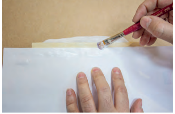
Görsel 2.181: Yan kâğıdının sırt bezi ile yapışacağı bölüme tutkal sürme
