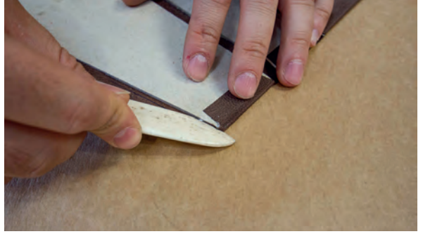
Görsel 3.81: Köşelerde kalan deri parçalarını mukavva kenarına yapıştırma
