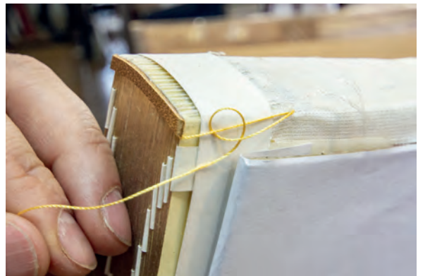
Görsel 2.137: Halkanın içinden ipi geçirerek düğüm oluşturma
