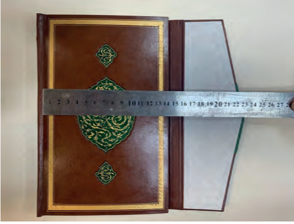
Görsel 2.216: Kabin genişlik ölçüsünü alma
