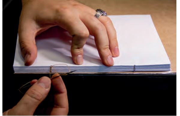
Görsel 2.59: İpin halka yaparak düğümlenmesi
