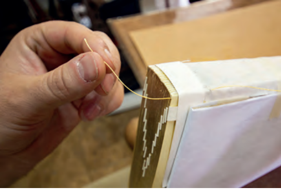
Görsel 2.127: İpin sırtta çıkarılması
