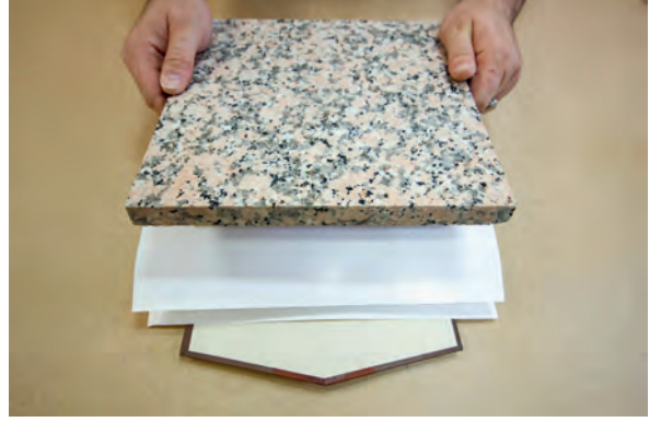
Görsel 3.136: Yapıştırılan kabın ağırlık altında bekletilmesi
