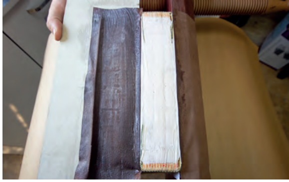
Görsel 3.156: Muhat derisinin altına mukavva yerleştirme
