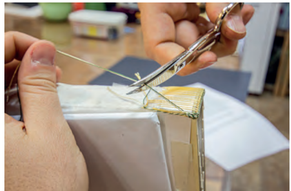
Görsel 2.164: Fazla iplerin kesilmesi
