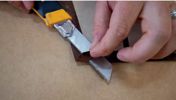
Görsel 3.74: Kıvrıma payının köşesinin kesilmesi
