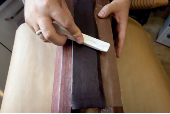
Görsel 3.161: İsteke ile deri altında kalan hava kabarcıklarını çıkarma
