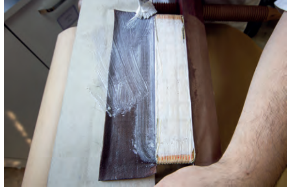
Görsel 3.158: Derinin açık olan yüzeyine tutkal sürme
