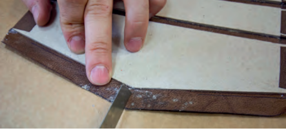
Görsel 3.85: Miklebin ucunun kesilmesi
