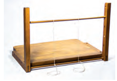
Görsel 2.96: Forma dikişinde kullanılan tezgâh
