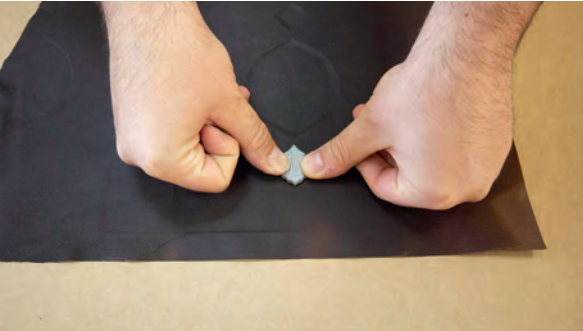
Görsel 3.48: Salbek kalıbını yuvaya yerleştirme
