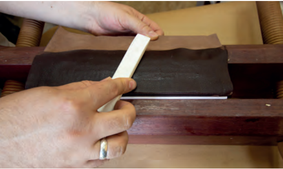
Görsel 3.152: Yapıştırılan deriyi isteka ile düzeltme
