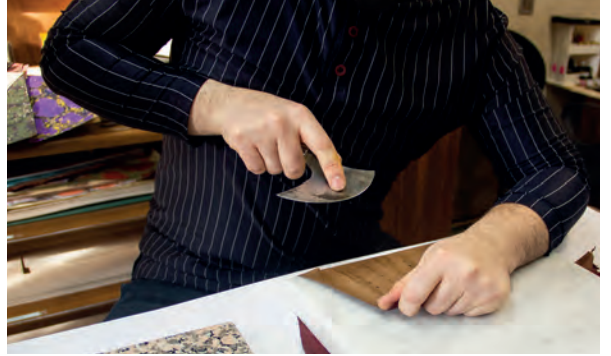
Görsel 1.49: Tıraşlama işlemi sırasında el tutuş pozisyonu
