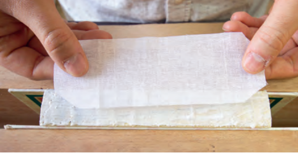
Görsel 2.105: Kitabın sırtına bezin yerleştirilmesi
