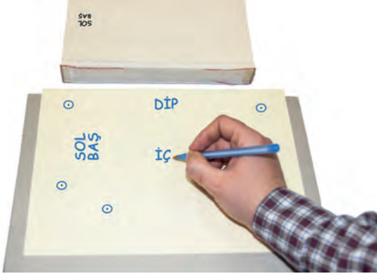
Görsel 2.210: Kitabın yön yazılarını ölçü kâğıdına yerleştirme
