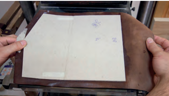
Görsel 3.59: Cilt dış yüzeyini çelik levha üzerine yerleştirme
