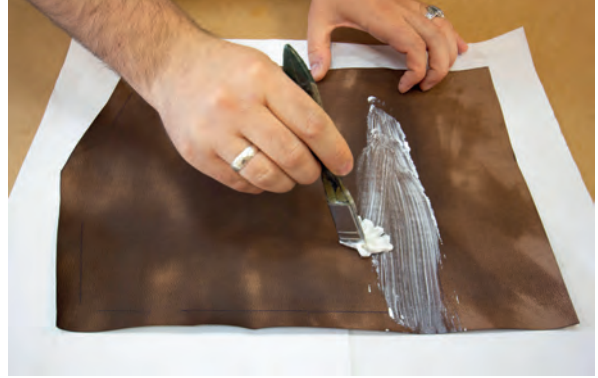
Görsel 3.39: Sol kap murakkasının yapıştırılacağı derinin iç yüzüne tutkal sürme
