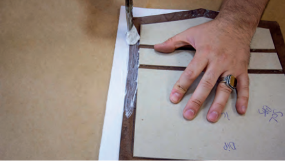
Görsel 3.67: Kıvrırma paylarına tutkal sürme
