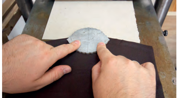
Görsel 3.56: Mikleb şemsesi kalıbının yerleştirilmesi
