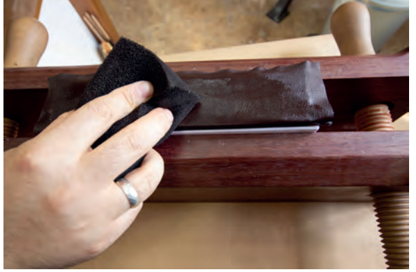
Görsel 3.177: Su ile derinin nemlendirilmesi
