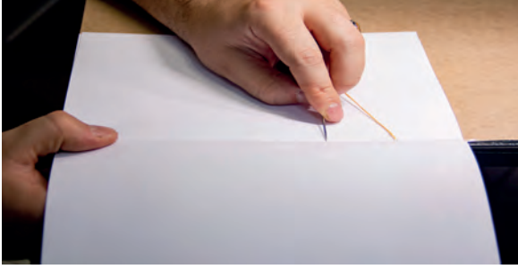
Görsel 2.78: İkinci formanın üçüncü durak yerinden dışarı çıkarma
