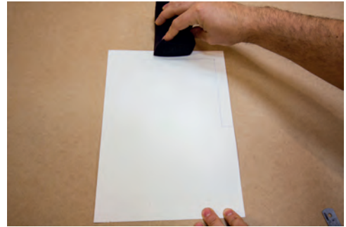
Görsel 2.8: Kâğıdın kısa kenarının ıslatılması
