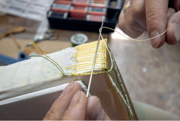
Görsel 2.156: İğnenin ikinci kolon altından geçirilmesi
