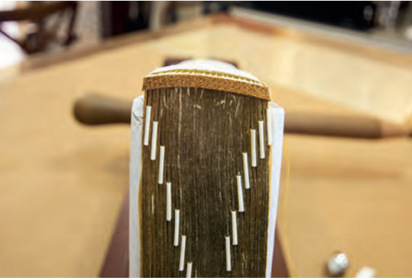
Görsel 2.133: Kitap genişliğine uygun kesilmiş yastık
