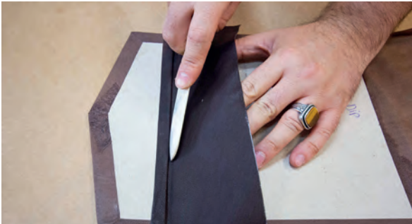
GörSEL 3.104: Deriyi dudak payı içine yapıştırma
