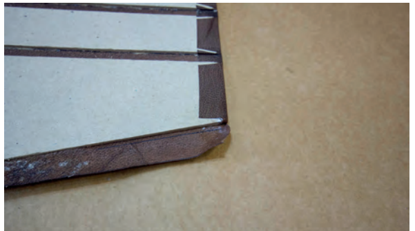
Görsel 3.83: Kısa kenar derisinin tekrar açılması
