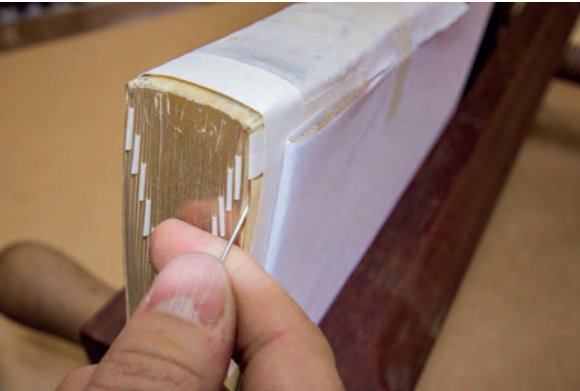
Görsel 2.116: Kolon ipini forma arasından geçirme
