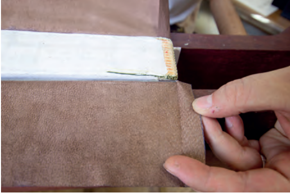
Görsel 3.145: Muhat kenarlarının kesilmiş hâli
