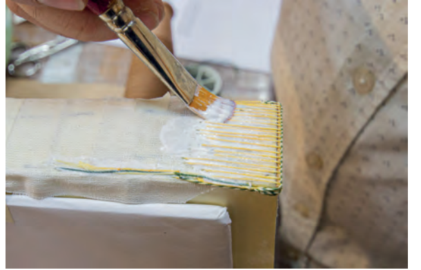
Görsel 2.168: Şiraze kolonlarının yapıştırılması
