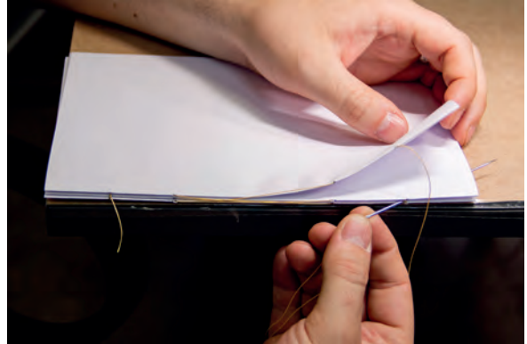
Görsel 2.87: İğnenin iki forma arasından geçirilmesi
