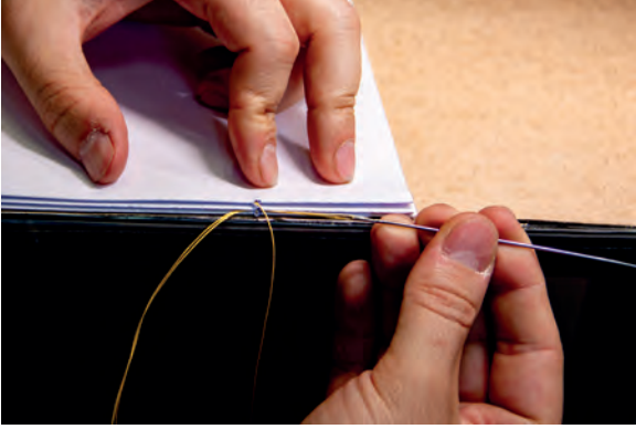
Görsel 2.55: İpin çekilerek bolluğunun alınması
