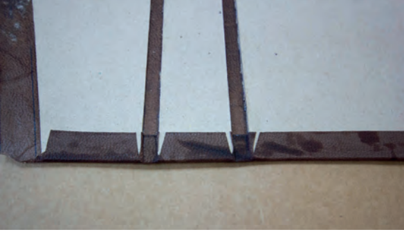
Görsel 3.79: Kesilen bölümün yapıştırılması
