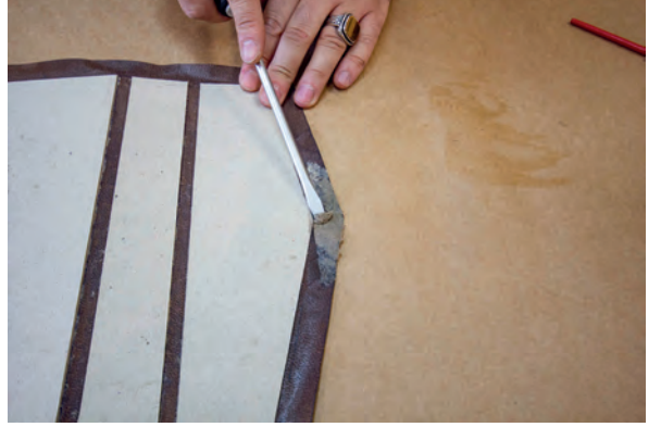
Görsel 3.65: Mikleb kenarlarında kalan mukavva artıklarının temizlenmesi
