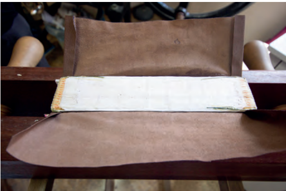
Görsel 3.143: Kitabın cendere ile sıkıştırılması
