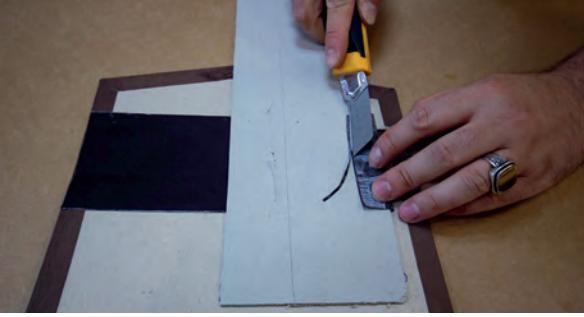
GörSEL 3.102: Nem etkisi ile ölçüsü uzayan deriyi sertab ölçüsünde kısaltma
