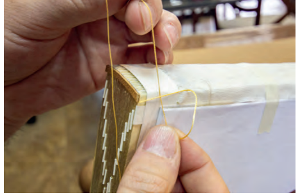
Görsel 2.135: Kolon içinden ip geçirme
