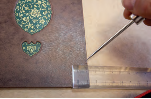
Görsel 3.118: Cilt kenarına cetvel ve iplik için işaret alma
