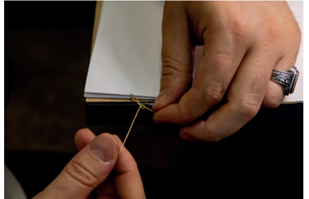
Görsel 2.82: Başlangıç ipi ile düğüm işlemi
