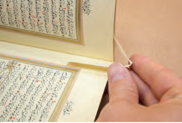
Görsel 2.112: Açıktaki ucu ikinci forma ortasına yerleştirme
