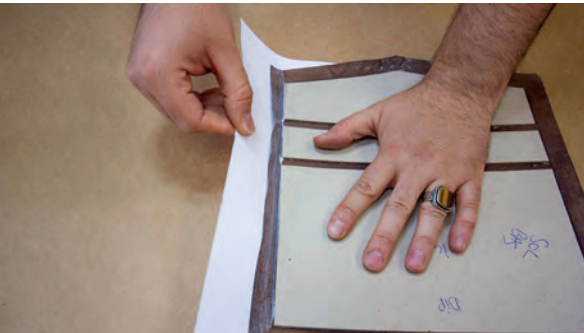
Görsel 3.68: Kıvrırma payının mukavva üzerine yatırılması
