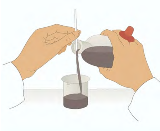
Görsel 1.2.6: Stok şişelerinden kimyasal alımı
