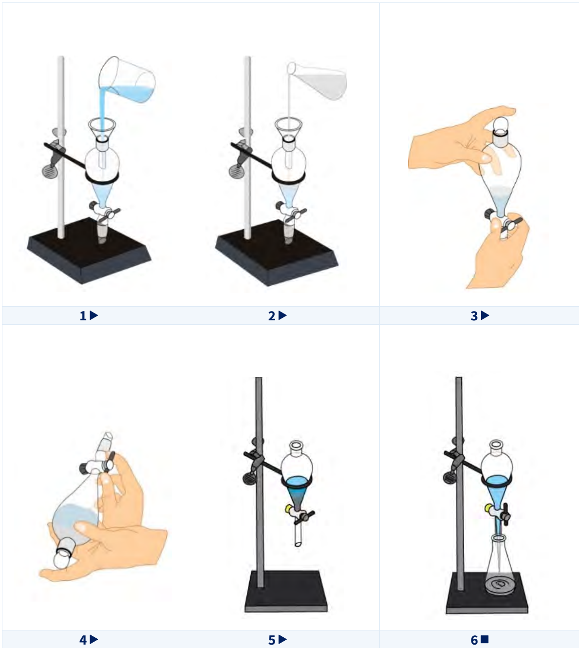
Görsel 5.6.3: Sıvı-sıvı ekstraksiyon uygulaması
