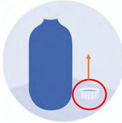
Görsel 1.2.5: Kimyasal şişesinin kapağı açıldığında kapağın iç tarafı yukarı gelmelidir.
