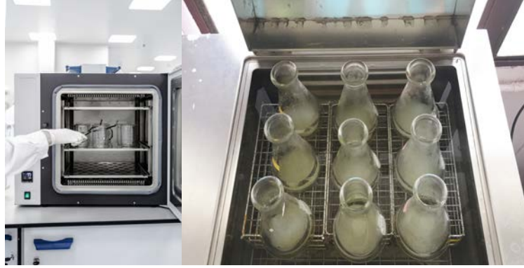
Görsel 6.8: İnkübasyonda kullanılan cihazlar (etüv ve su banyosu)
