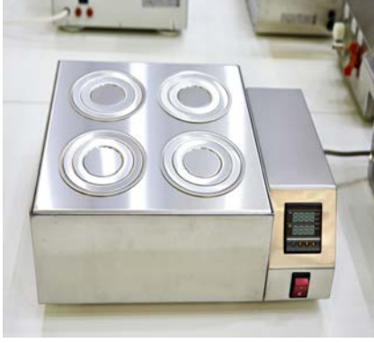
Görsel 6.4: Agarlı besiyerini istenen sıcaklığa getirmek için kullanılan ekipmanlar
