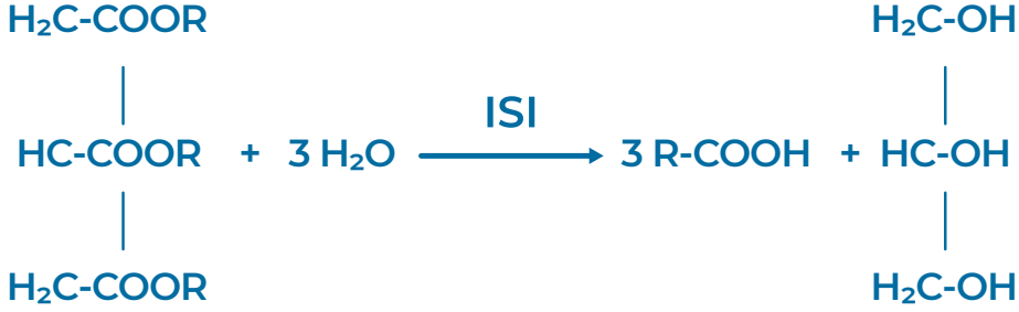
Şekil 2.7: Yağın hidrolizi reaksiyonu
