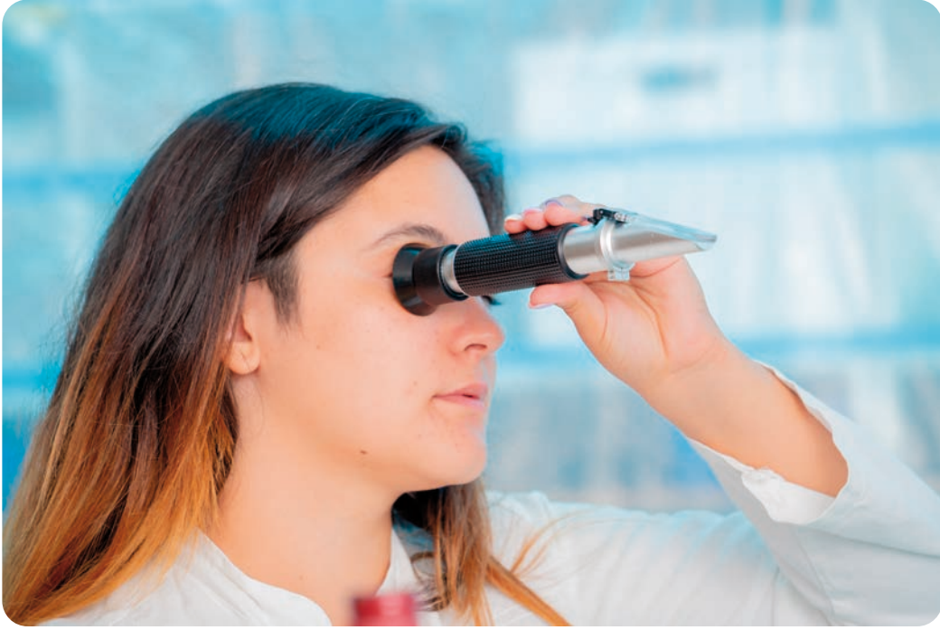
Görsel 2.15: Refraktometre ile okuma yapma
