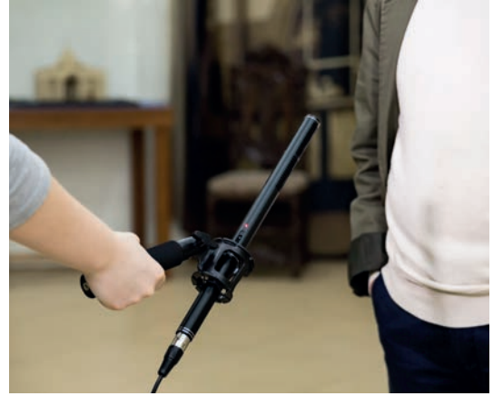
Görsel 3.18: Shotgun mikrofon
