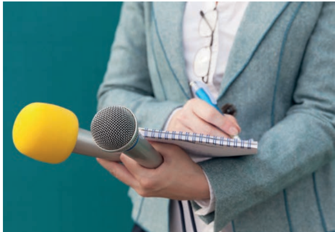
Görsel 3.23: Rüzgâr başlığı takılmış ve takılmamış mikrofonlar
