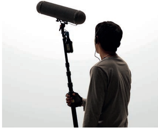
Görsel 3.24: Boom üzerine takılmış mikrofon
