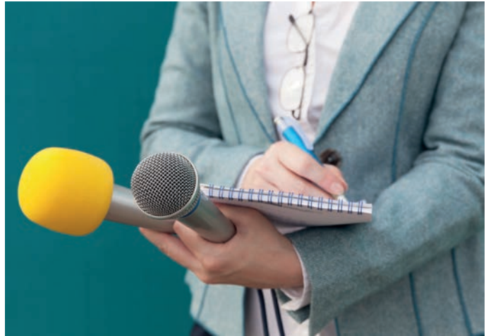
Görsel 3.23: Rüzgâr başlığı takılmış ve takılmamış mikrofonlar
