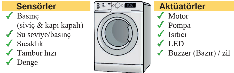
Şekil 1.18: Otomatik çamaşır makinesinde kullanılan sensör ve aktüatörler (çıkış elemanı)
