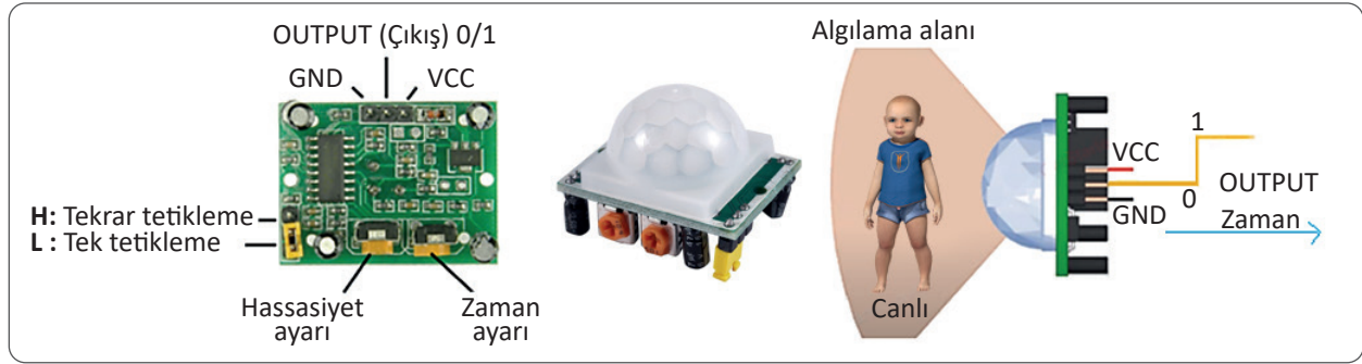
Şekil 2.51: HC-SR502 hareket algılama sensörünün görüntü ve pin bağlantı şeması
