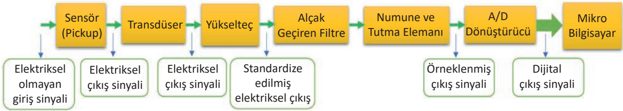
Şekil 1.3: Standart bir ölçüm sistemi blok şeması
