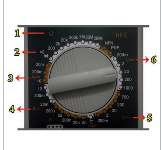
Görsel 1.4: Dijital multimetre kademe anahtarı
