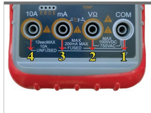
Görsel 1.3: Dijital multimetre girişleri
