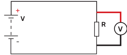
Şekil 1.16: Ölçü aletinin bağlanması
