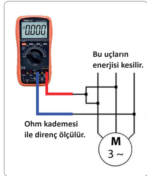
Görsel 1.4: Motorun omik direncinin ölçülmesi
