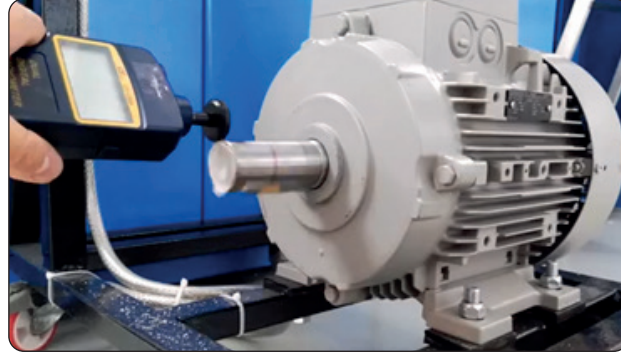
Görsel 1.8: Devir sayısı ölçme işlemi
