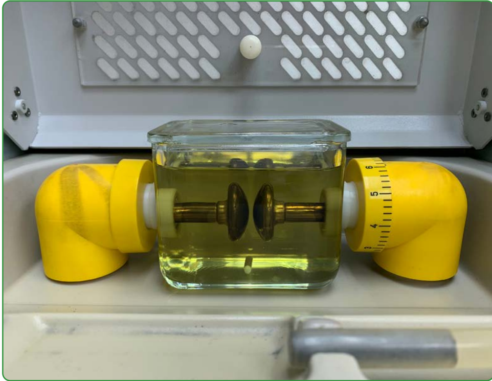
Görsel 2.10: Transformatör yağ testi
