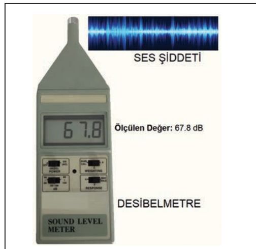
Görsel 1.16: Desibelmetre ile ses şiddetinin ölçülmesi
