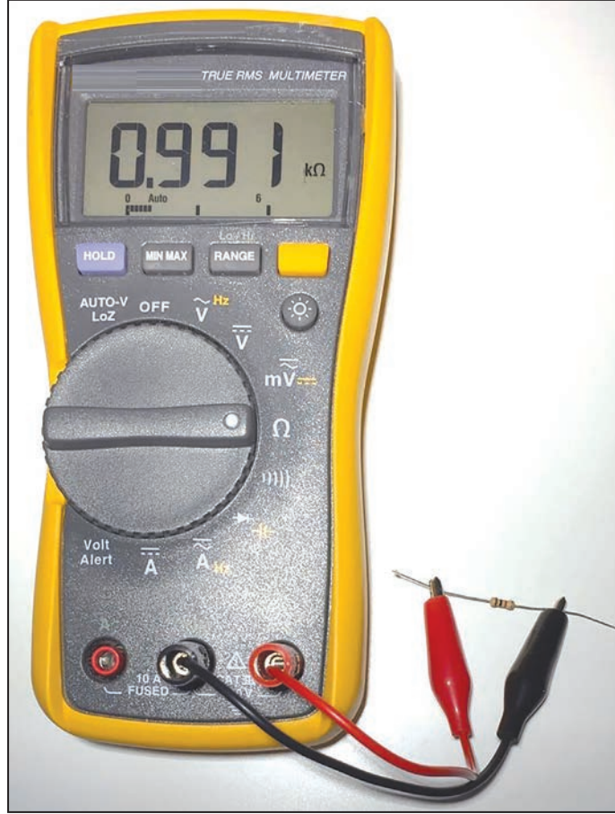
Görsel 4.11: Multimetre ile direnç ölçme işlemi
