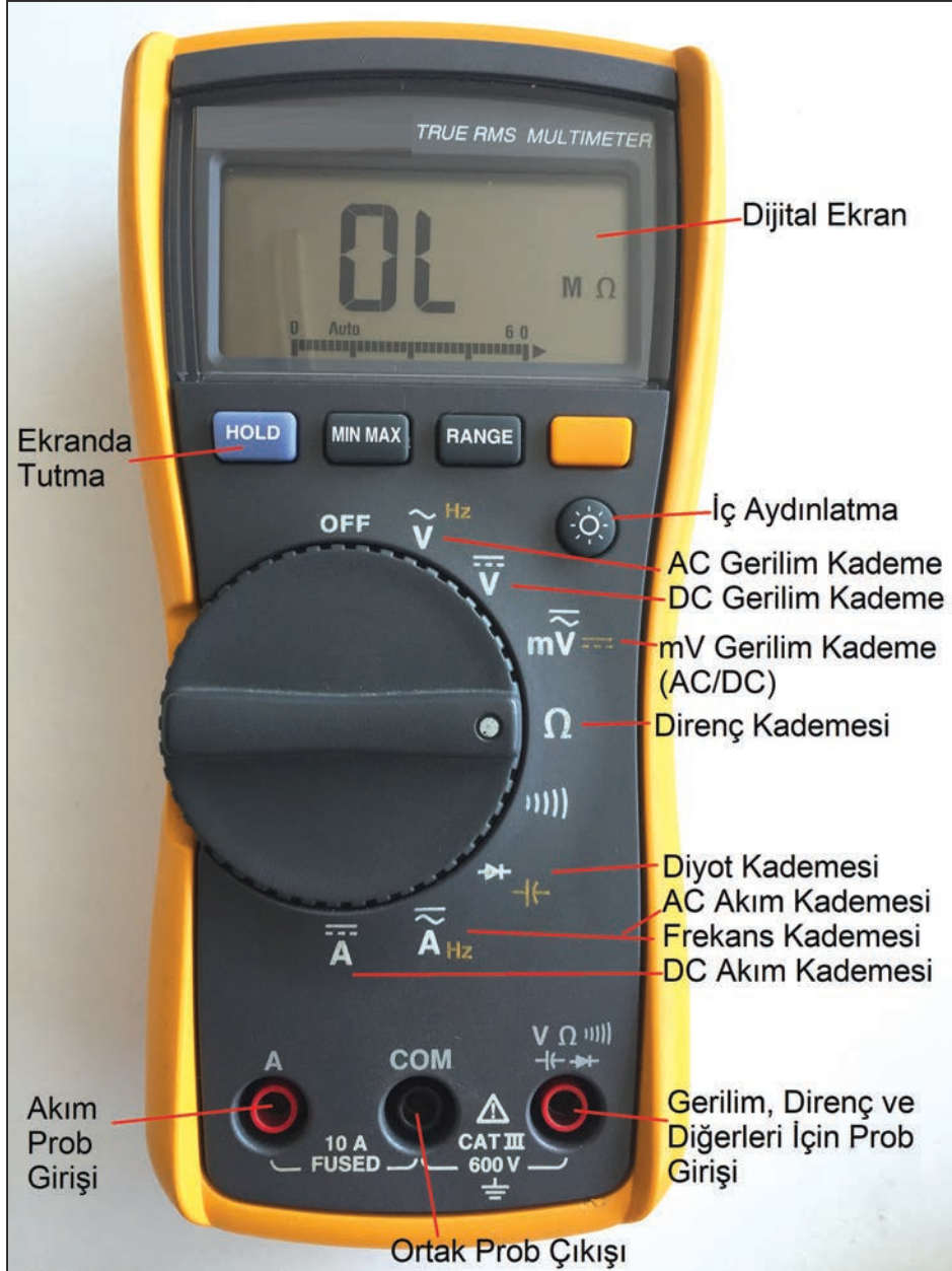
Görsel 1.34: Multimetrenin yapısı
