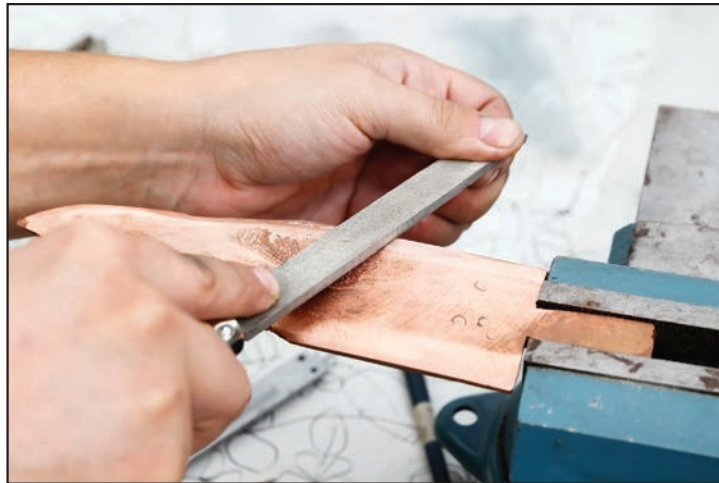
Görsel 3.12: Mengene üzerindeki parçanın eğelenmesi işlemi
