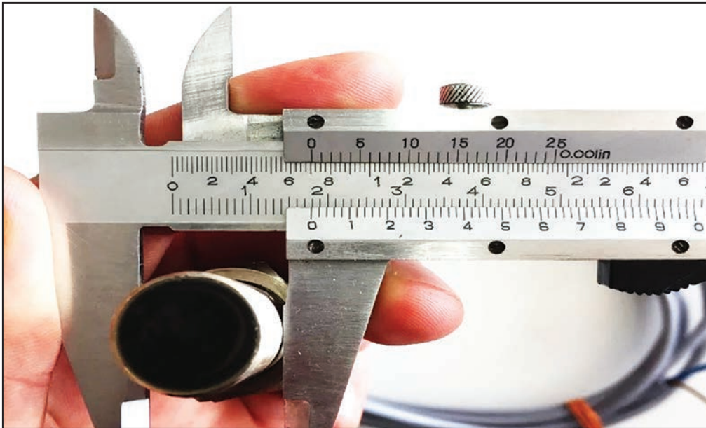
Görsel 1.9: Kumpas ile sensör çapı ölçümü
