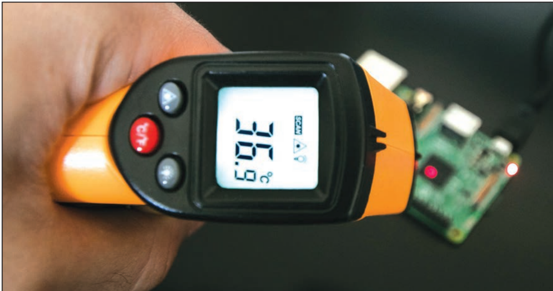
Görsel 1.18: Kızılötesi termometre ile devrede sıcaklık ölçümü
