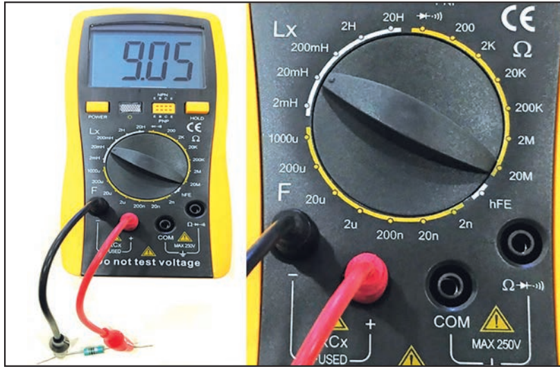
Görsel 4.23: LCRmetre ile endüktans ölçümü
