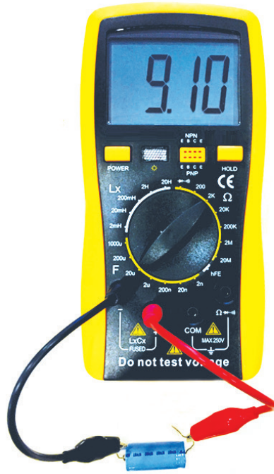
Görsel 4.20: LCRmetre ile kapasite ölçümü
