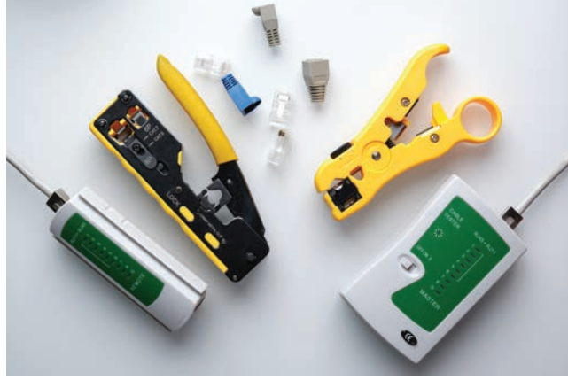
Görsel 4.12: Telefon kablosunun test malzemeleri
