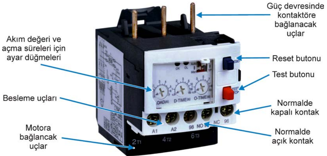
Görsel 3.24: Elektronik aşırı akım rölesi
