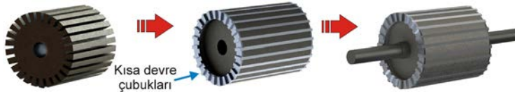
Görsel 3.6: Rotor, rotor sargılarının yerleştirilmesi, rotor ve milin birleştirilmesi
