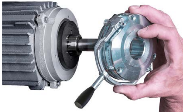
Görsel 6.7: Fren balatasının motora montajı
