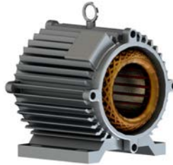
Görsel 3.3: Stator sargılarının yerleştirilmesi
