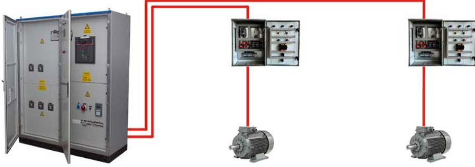
Görsel 2.17: Panoların cihazlara bağlantısı
