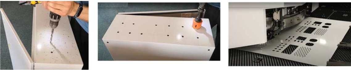
Görsel 1.23: Matkapla, pançla ve CNC tezgahlarında pano kapağının delinmesi
