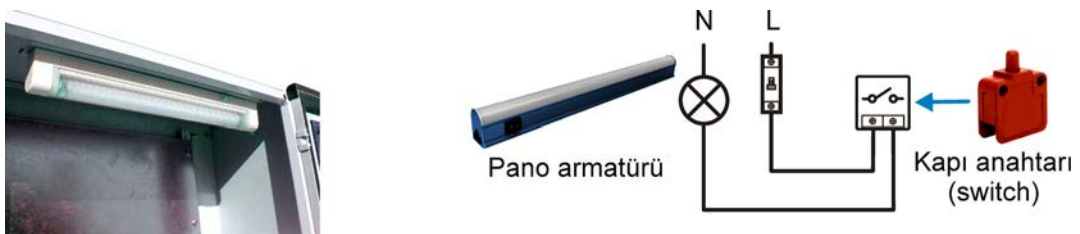
Görsel 9.31: Kompanzasyon panosunun aydınlatılmasına ait bağlantı şeması
