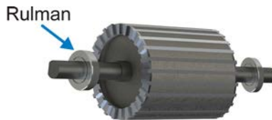
Görsel 3.8: Rulmanların mil üzerine monte edilmesi
