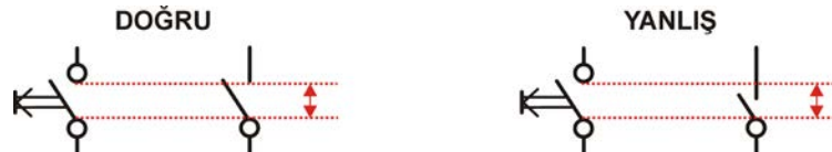
Görsel 4.19: Buton ve kontakların bağlantı uçları arasındaki mesafe
