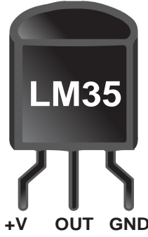
Görsel 2.12: LM35 pin yapısı
