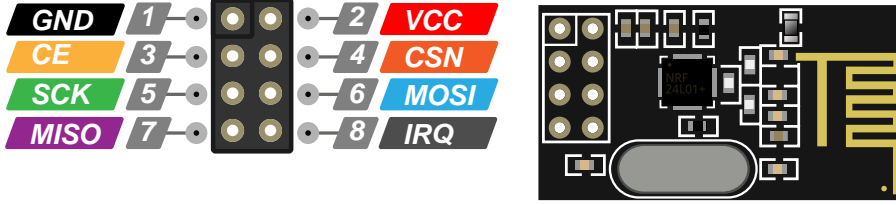
Görsel 3.79: nRF24L01+ pin yapısı
