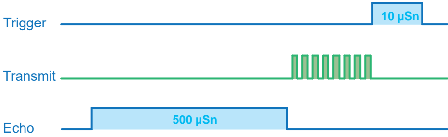
Görsel 3.21: Ultrasonik sensör engel algıladığında
