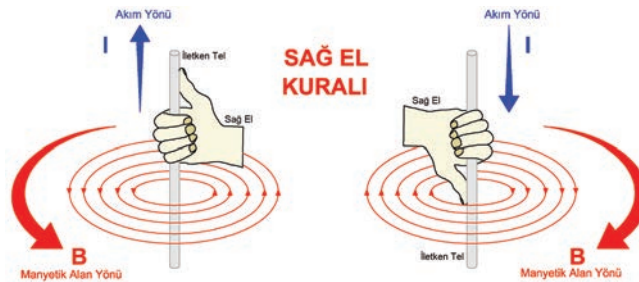
Görsel 1.7: Sağ el kuralına göre akım ve manyetik alan yönünün tespiti
