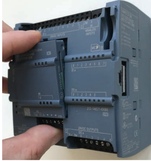
Görsel 7.13: PLC analog sinyal board montajı
