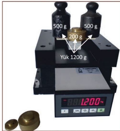
Görsel 1.33: Yük hücrenin tartım terminaline bağlanarak çalıştırılması ve farklı ağırlıkların ölçülmesi
