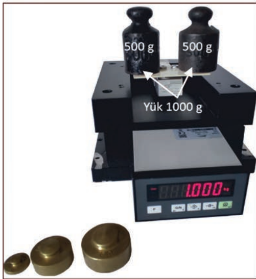
Görsel 1.33: Yük hücrenin tartım terminaline bağlanarak çalıştırılması ve farklı ağırlıkların ölçülmesi
