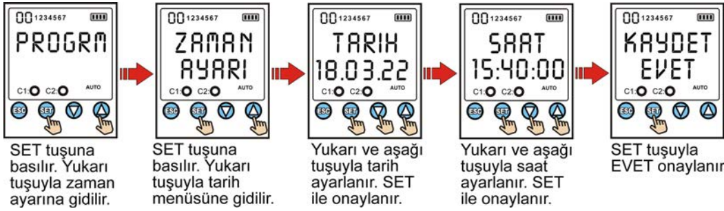
Görsel 2.14: Programlanabilir ve astronomik zaman saatinde tarih ve gerçek zaman saatinin ayarlanması
