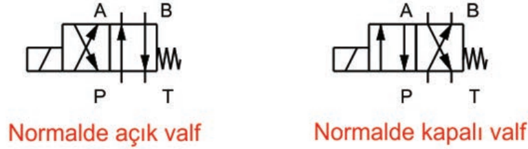
Görsel 7.1: Normalde açık ve normalde kapalı 4/2 selenoid valf
