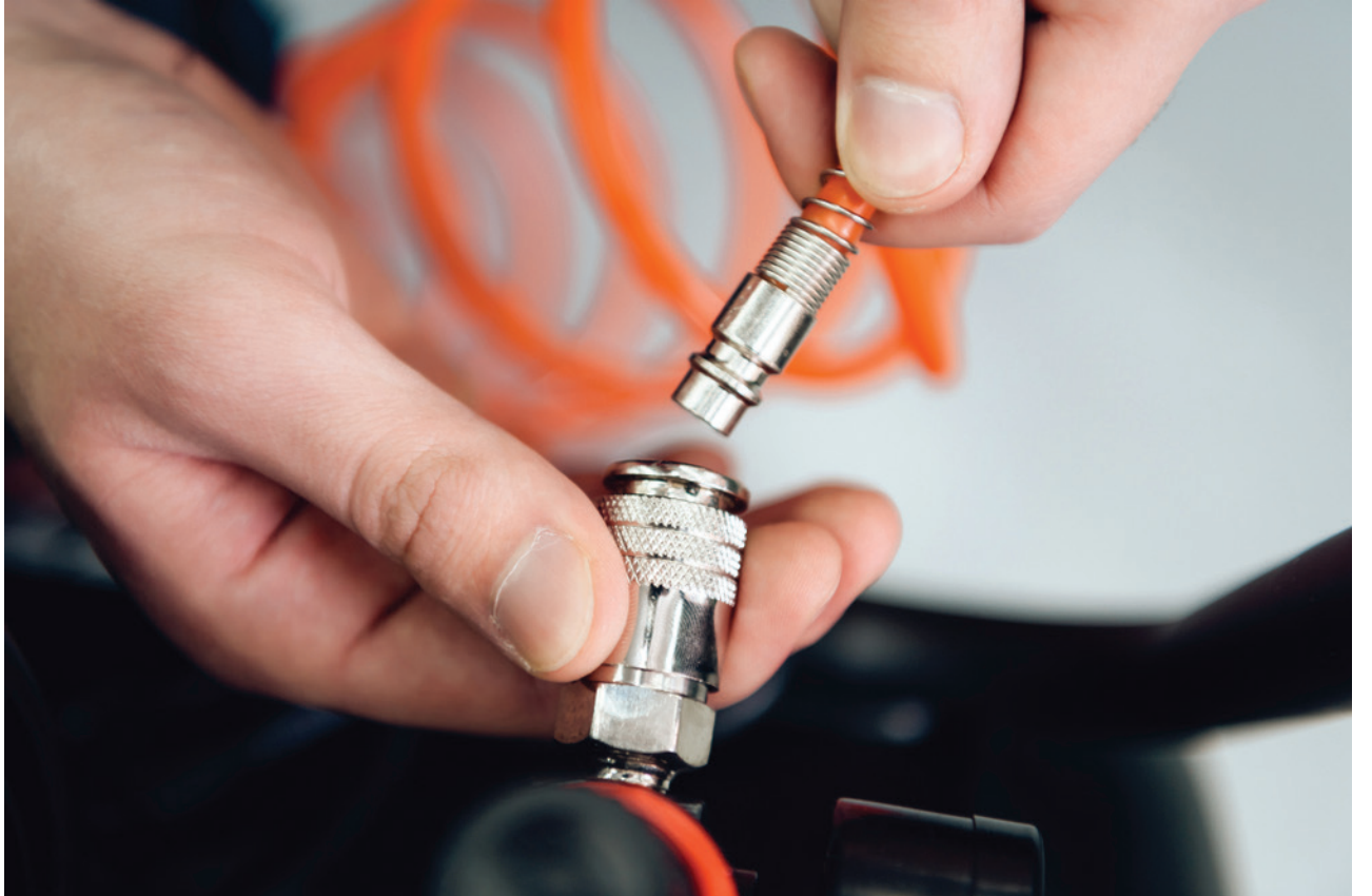
Görsel 4.19: Pnömatik elemanların bağlantısı
