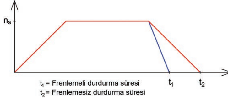
Görsel 3.1: Motorun frenlemeli ve frenlemesiz durma süreleri
