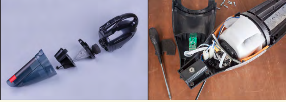
Görsel 7.2: Şarjlı elektrik süpürgesinin iç yapısı
