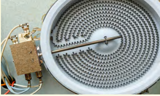
Görsel 5.6: Rezistanlı elektrik ocağının tamiri
