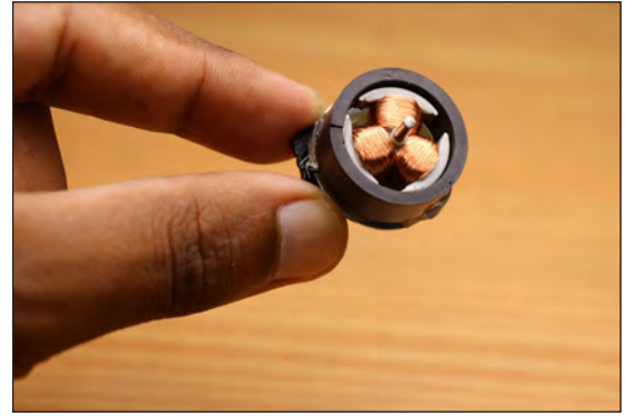
Görsel 9.16: Doğal mıknatıslı endüktör ve endüvi
