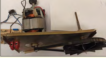
Görsel 2.29: Mutfak robotunun iç yapısı
