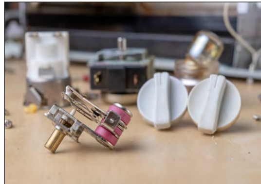
Görsel 3.5: Bimetal termostat ve ayar anahtarı
