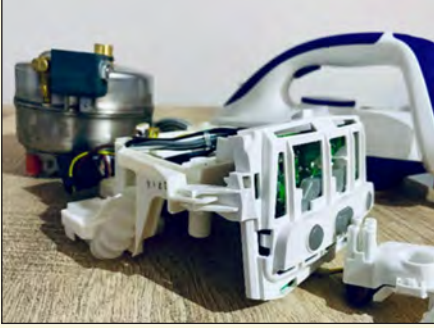
Görsel 6.25: Buhar kazanlı ütünün kazan kısmı
