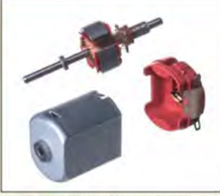
Görsel 9.24: DC motorun parçaları
