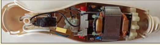
Görsel 2.18: Blenderın sökümü ve montajı
