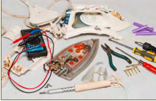
Görsel 6.12: Buharlı ütünün iç yapısı
