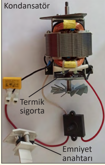
Görsel 2.72: Katı meyve sıkacağıın motoru, emniyet anahtarı ve termik sigortası
