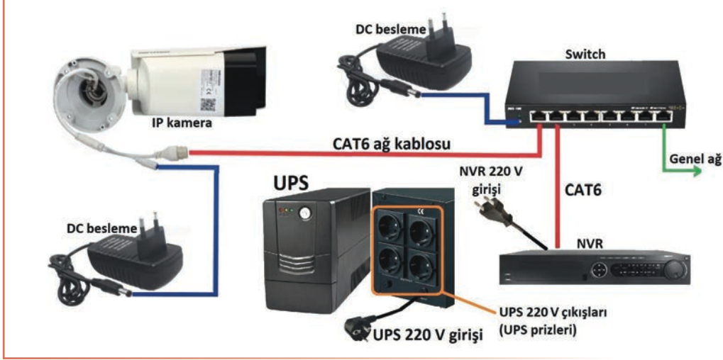
Görsel 3.53: CCTV sistemine UPS bağlantısı
