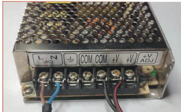
Görsel 3.5: Güç kaynağı
