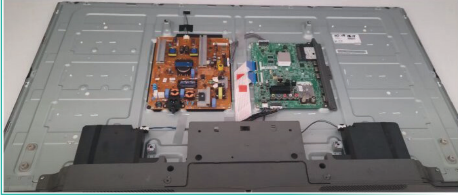
Görsel 1.77: LED TV arka aydınlatma LED'lerinin değiştirilmesi için arka kapak vidalarının sökülmesi
