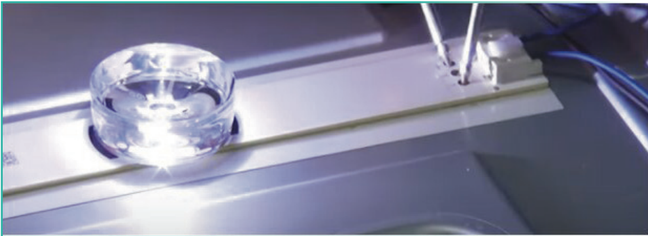
Görsel 1.87: Test cihazıyla LED'lerin kontrol edilmesi ve arızalı LED barların değiştirilmesi
