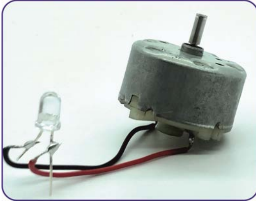
Görsel 1.20: Motor uçlarına LED'in lehimlenmesi
