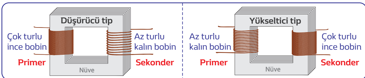
Görsel 3.111: Düşürücü ve yükseltici tip transformatörler
