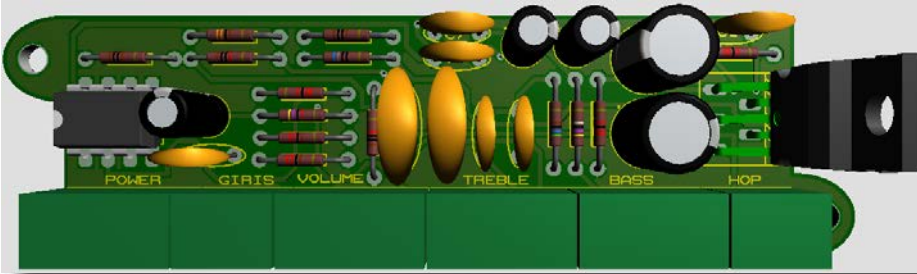
Plaketin boş yerlerinin bakırla kaplanması (üstten 3D)
