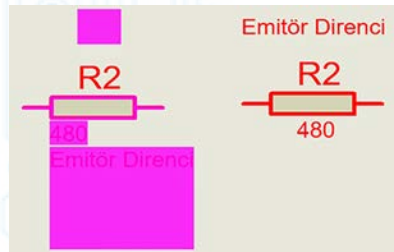
Görsel 1.52: Eleman üzerindeki yazının yerinin değiştirilmesi
