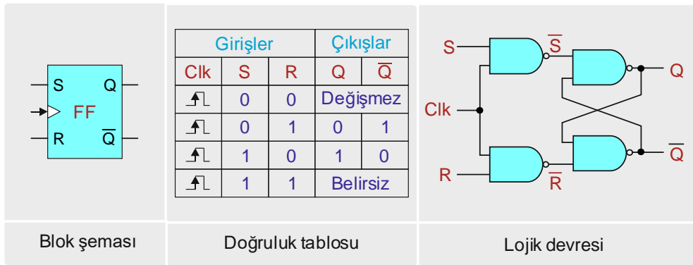
Görsel 6.48: Tetiklemeli RS flip-flop
