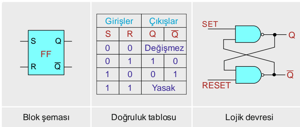
Görsel 6.47: NAND kapılı RS flip-flop
