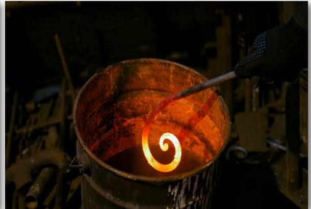
Görsel 7.11: Parçanın şekillendirilmesi ve suya daldırılarak sertleştirilmesi
