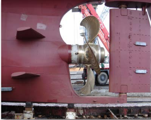
Görsel 5.13: Pitch kontrollü pervane ve kısımları
