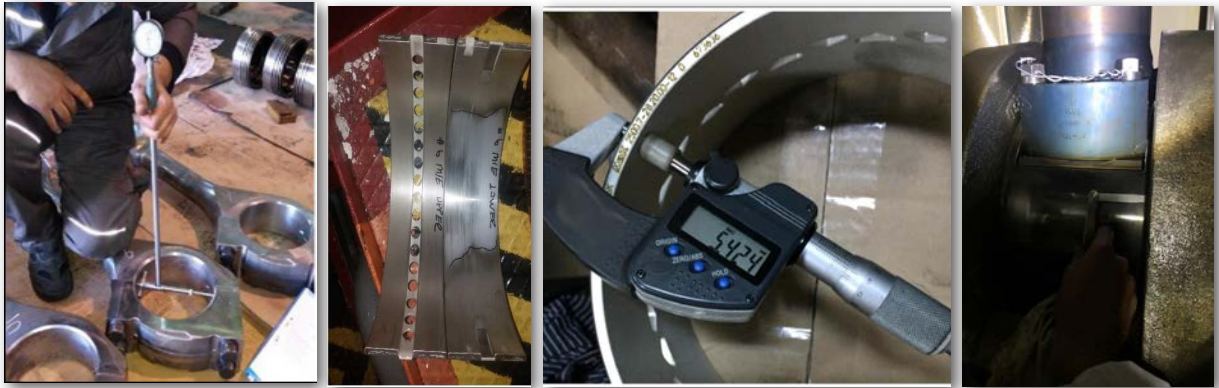
Görsel 4.50: Biyel kol muylusu ölçümü, krank ana muylusunun aşındırılmış olduğu alt ve üst kusunet yataklar
