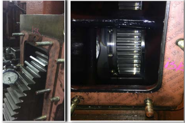
Görsel 4.6: Dişli boşluklarının ölçülmesi
