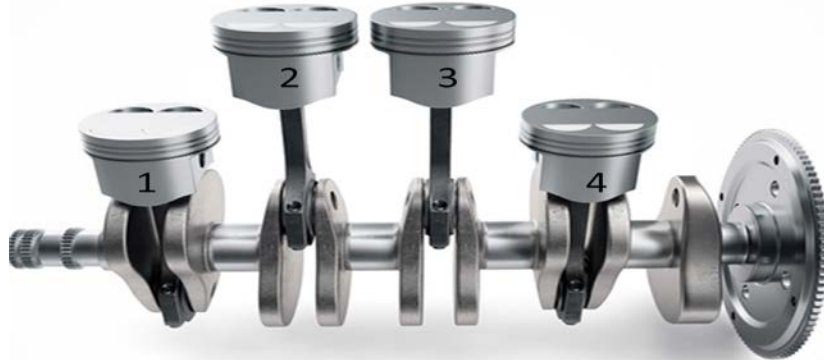
Görsel 1.1: Motorun beraber çalışan silindirlerini belirlemek
