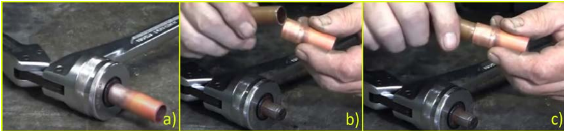
Görsel 9.17: Çift kollu muf açma aparatı kullanarak muf açmak
