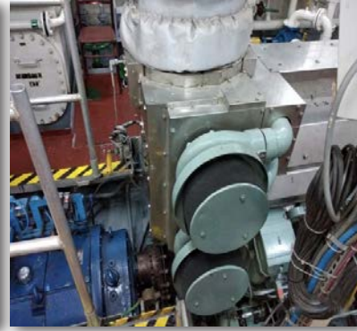
Görsel 2.2: Metal elemanlı hava filtresi
