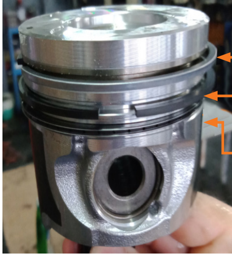
Görsel4.34: Piston üzerindeki segmanların özellikleri
