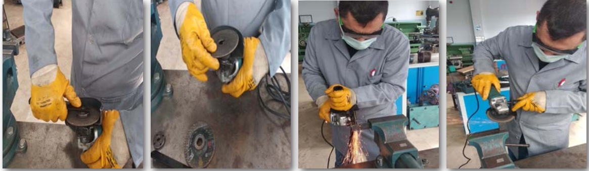
Görsel 8.36: Avuç içi taşlama makinesi ile kesme ve taşlama yapma
