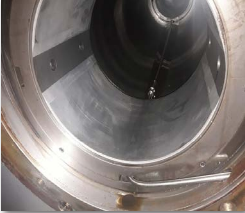
Görsel 5.8: White metalden yapılmış pervane şaft yatağı
