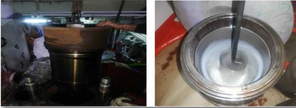
Görsel 3.29: Laynerin çekilmesi ve gerekli kontrollerin yapılarak laynerin honlanması
