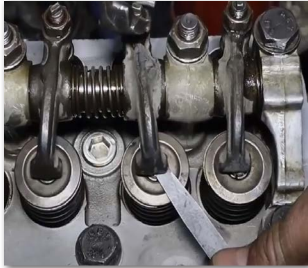
Görsel 1.2: Valf boşluğu ve valf boşluğunun sentil (filer çakısı) ile ölçülmesi
