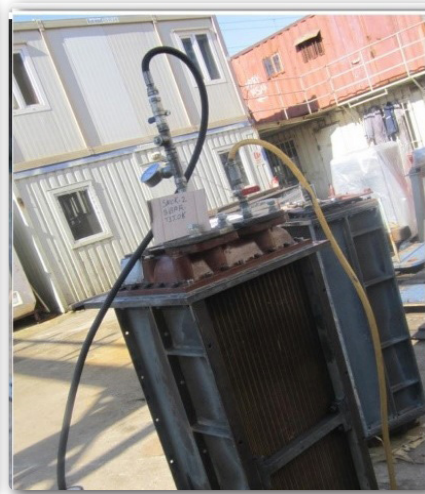
Görsel 2.18: Hava soğutucusunun basınçlı su ile test edilmesi
