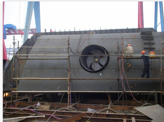
Görsel 5.17: Baş manevra pervanesi (bow thruster)
