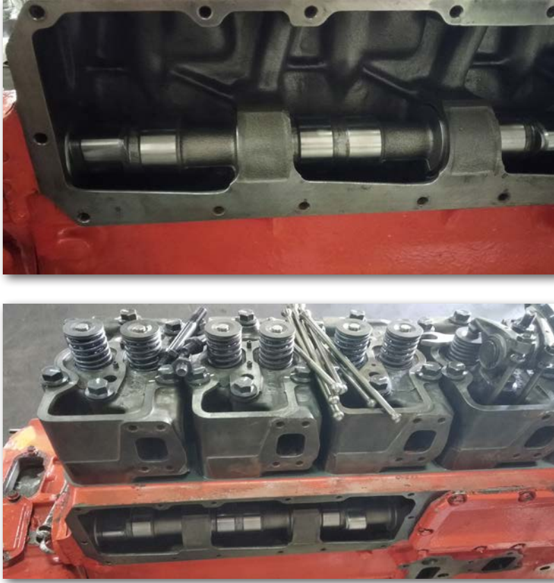
Görsel 4.7: L tipi valf mekanizmasında kam şaft konumu
