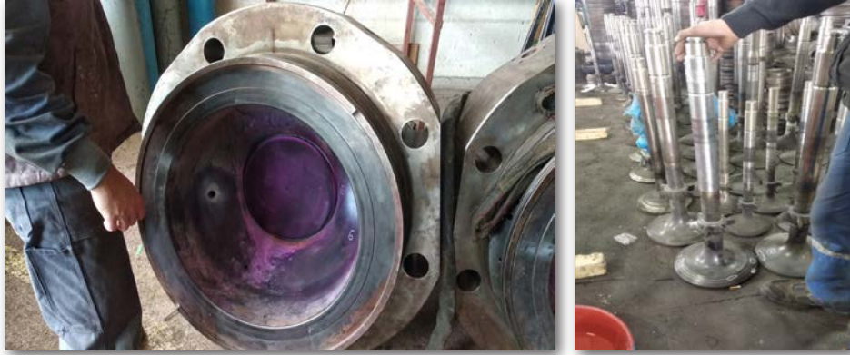
Görsel 4.16: İki zamanlı bir ana makinenin kaverinde bulunan egzoz valfi
