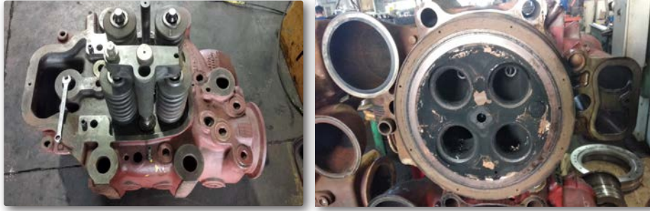
Görsel 3.10: Kaverin üstten ve yanma odası tarafından görünüşü
