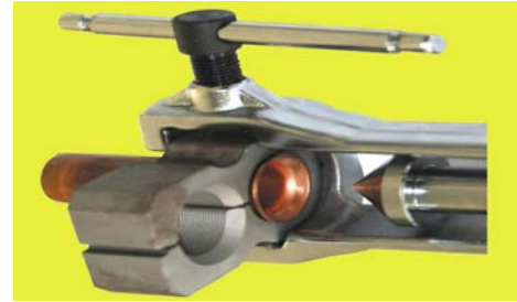
Görsel 9.19: Bakır ve alüminyum borulara havşa işkencesi ile havşa açma
