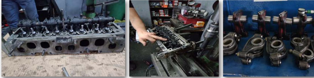
Görsel 3.9: Roker-armın motordan sökülmesi, takılması ve bakımının yapılması
