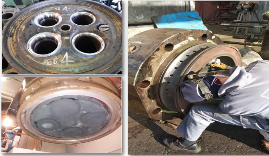
Görsel 3.17: Kaverde karbonları temizleme işlemi
