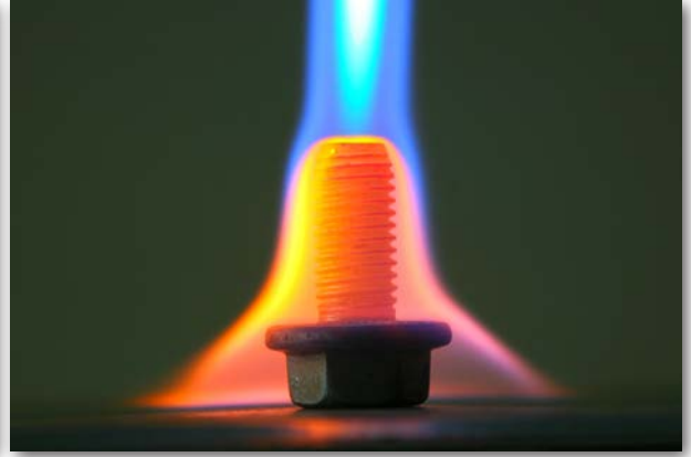
Görsel 7.10: Üfleç ile parçanın tavllanması
