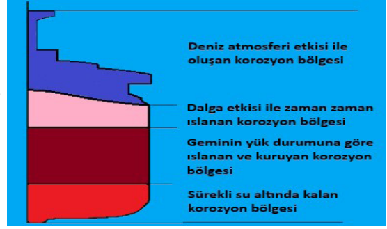
Şekil 7.3: Gemi gövdesinde korozyona maruz kalan yerler
