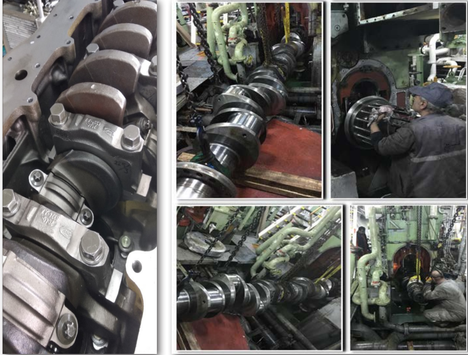
Görsel 4.44: Krank şaftın sökülmesi ve takılması
