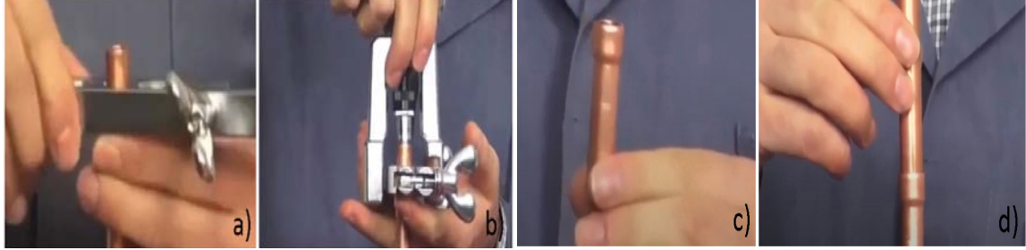
Görsel 9.15: Aparat kullanarak muf açma işlemi
