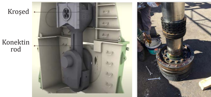
Görsel 4.37: Kroşed mekanizması, piston rod ve salmastra kutusu
