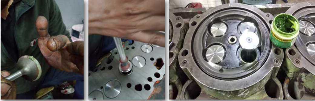
Görsel 4.29: Valf alıştırma aparatı ile alıştırma işlemi
