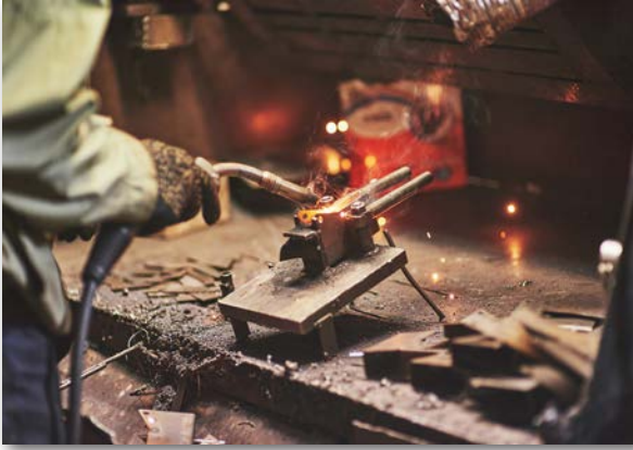
Görsel 7.10: Üfleç ile parçanın tavllanması
