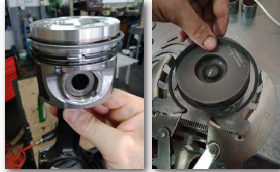
Görsel 4.40: Piston üzerindeki segmanların sökülmesi ve takılması
