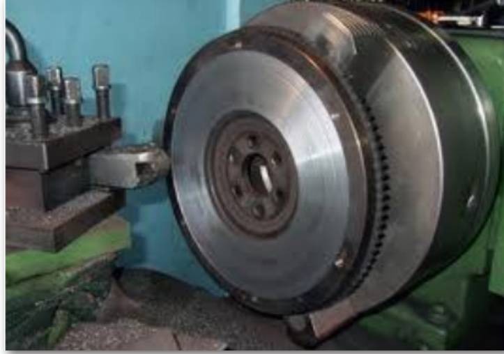
Görsel 4.53: Volanın ön yüzeyinin torna tezgâhında tornalam işlemi
