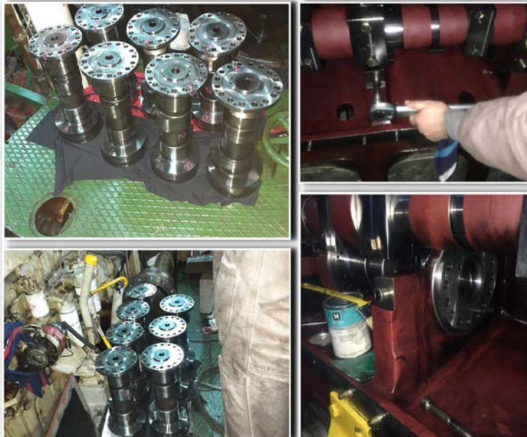
Görsel 4.9: Kam şaftın ana makineden sökülme aşamaları
