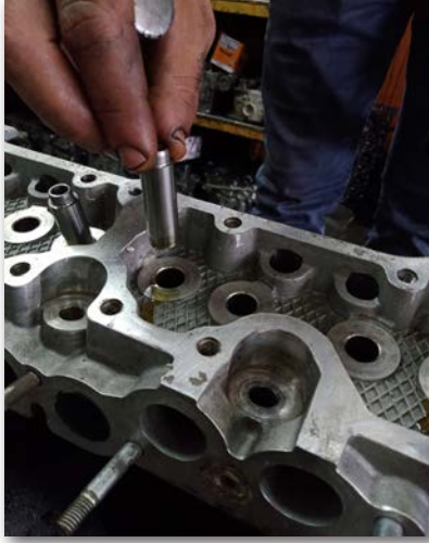
Görsel 4.18: Valf gayıtının silindir kapağına çakılması
