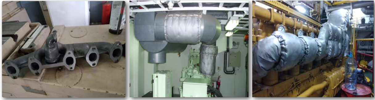
Görsel 3.2: Egzoz manifoldu ve ısı yalıtımı
