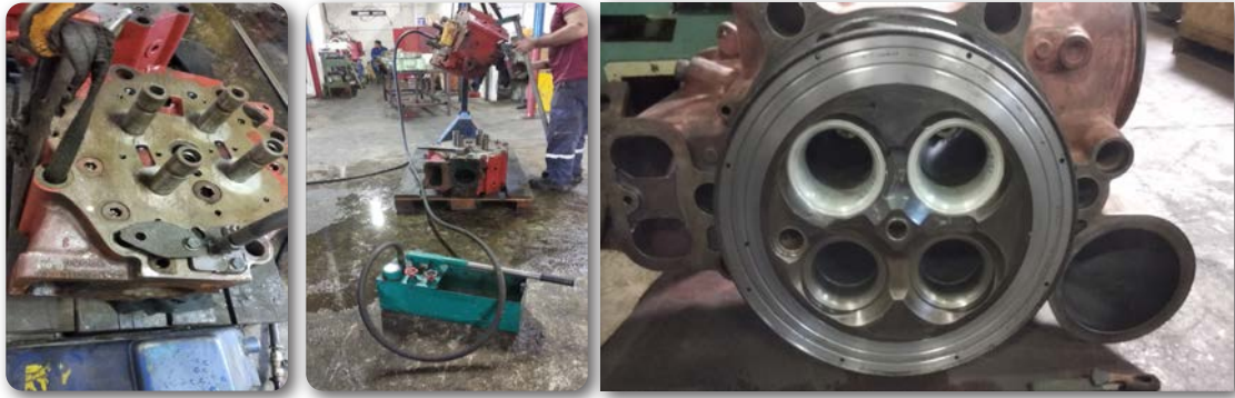
Görsel 3.20: Su testi ile kaçak kontrolü
