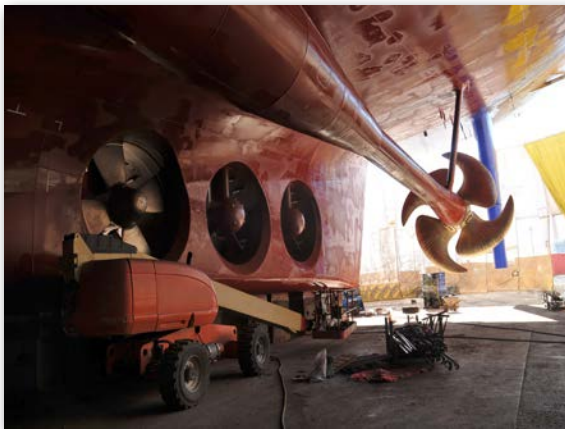
Görsel 5.17: Baş manevra pervanesi (bow thruster)
