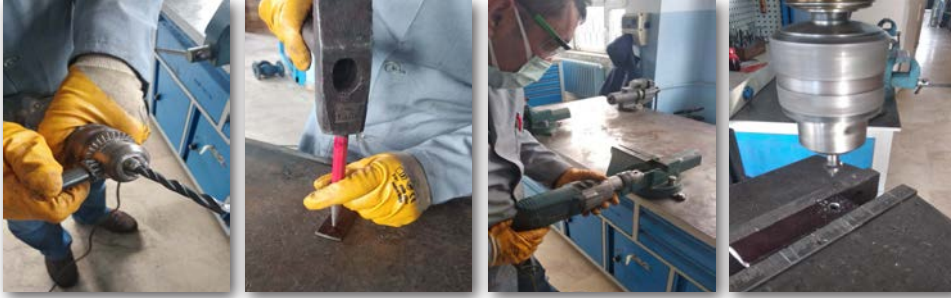
Görsel 8.37: El breyzi ile delme ve havşa açma
