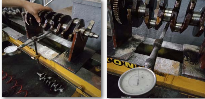
Görsel 4.46: Komparatör ile eğiklik ölçümü
