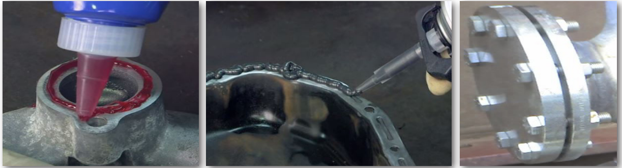
Görsel 7.14: Sıvı conta ile bağlantı
