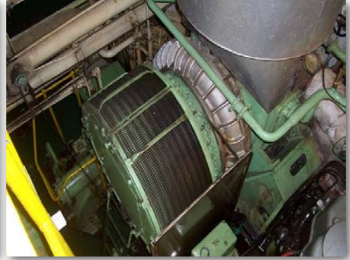
Görsel 2.2: Metal elemanlı hava filtresi
