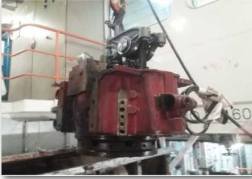
Görsel 3.12: Gemi ana makinesi kaveri ve kaverin kaldırılışı
