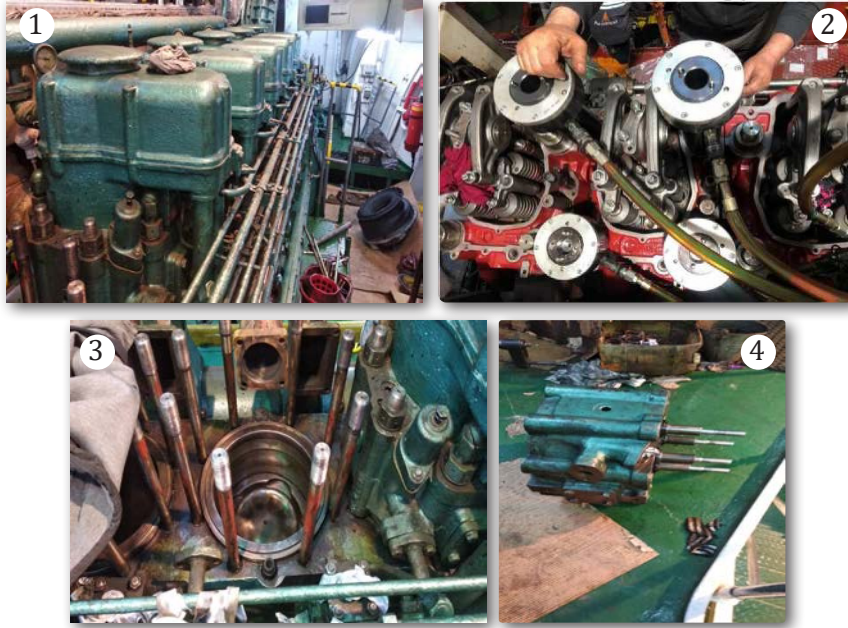
Görsel 3.15: Kaverin sökülmesi ve takılması
