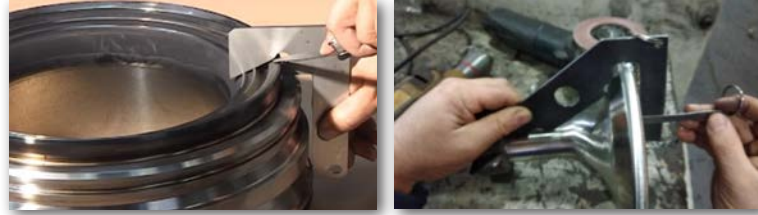
Görsel 4.25: Valf ve sit oturma yüzeyinin kontrolü
