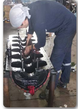
Görsel 3.23: Gemide jenaratörde kullanılan kutu şeklinde bedpleyt
