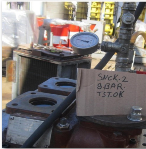
Görsel 2.18: Hava soğutucusunun basınçlı su ile test edilmesi
