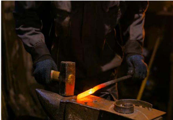
Görsel 7.11: Parçanın şekillendirilmesi ve suya daldırılarak sertleştirilmesi
