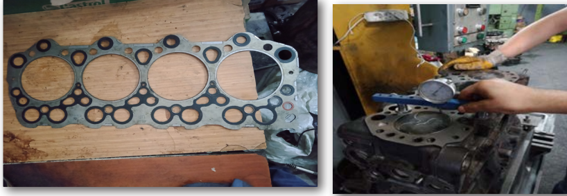
Görsel 3.16: Gasket kalınlığını belirleme işlemi
