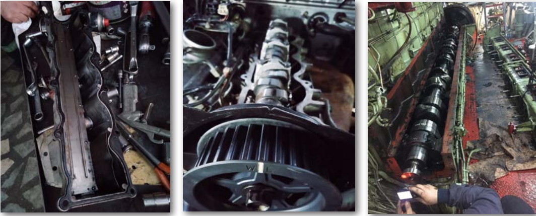
Görsel 4.8: Kapak üzerindeki mantar conta ve kam şaft kasağı üzerindeki işaret
