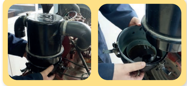
Görsel 13.5: Yağlı filtrenin bakımının yapılması
