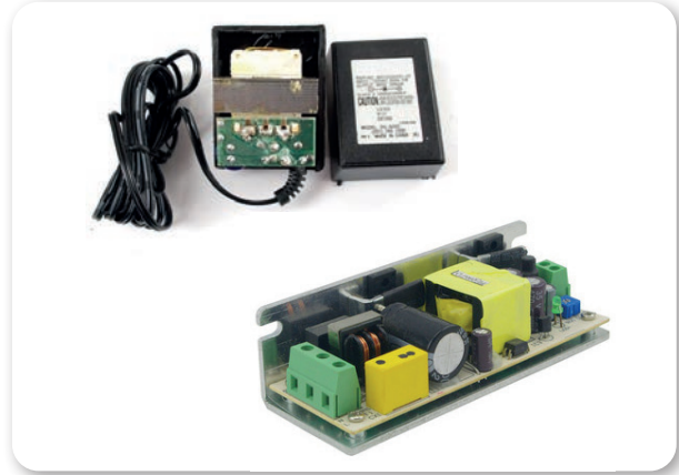
Görsel 18.8: Trafonun DC güç kaynaklarında kullanımı
