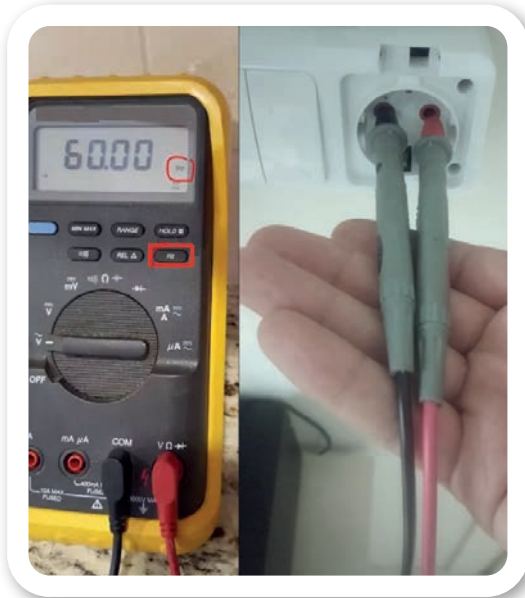
Görsel 17.30: Prizde frekans ölçümü yapılması
