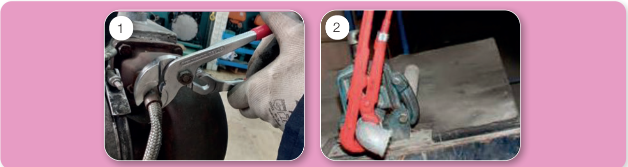
Görsel 10.7: Papağan pense ve boru anahtarı kullanma
