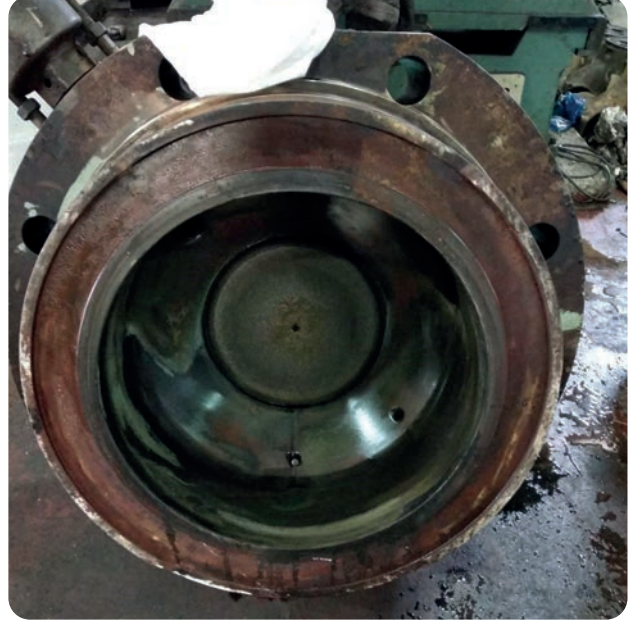
Görsel 13.15: İki zamanlı bir gemi makinesine ait kaver üzerinde valf kütüğü ve egzoz valfi
