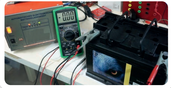
Görsel 18.16: Akünün şarj aletine bağlanması ve şarj edilmesi
