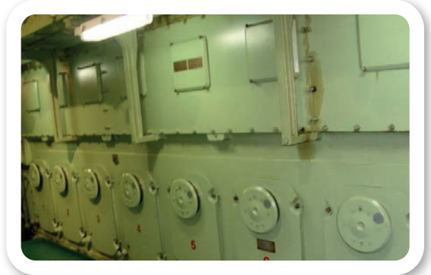
Görsel 13.20: Krank keys üzerinde karter kapakları ve rilif valf
