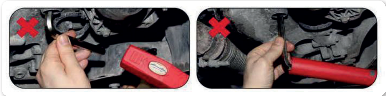
Görsel 10.11: Allen anahtarın hatalı kullanımı
