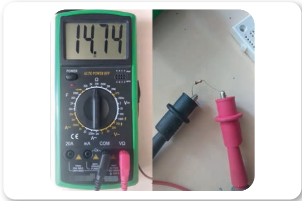
Görsel 17.27: Avometre ile örnek bir direnç ölçümü
