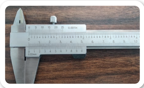
Görsel 11.8: 1/50 (0,02 mm) hassasiyetli mekanik kumpas
