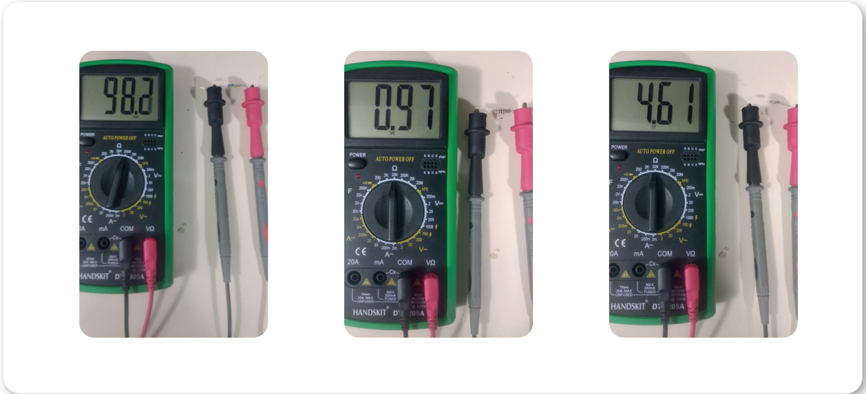
Görsel 16.10: Avometre ile direnç ölçümü
