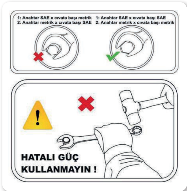
Şekil 10.2: Doğru ölçüde anahtar kullanımı
