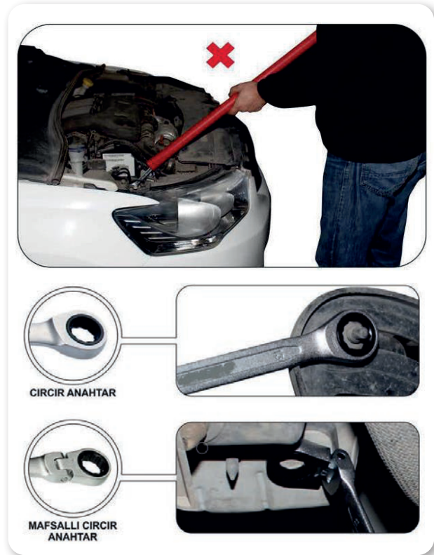
Görsel 10.14: Anahtarların doğru ve yanlış kullanımı
