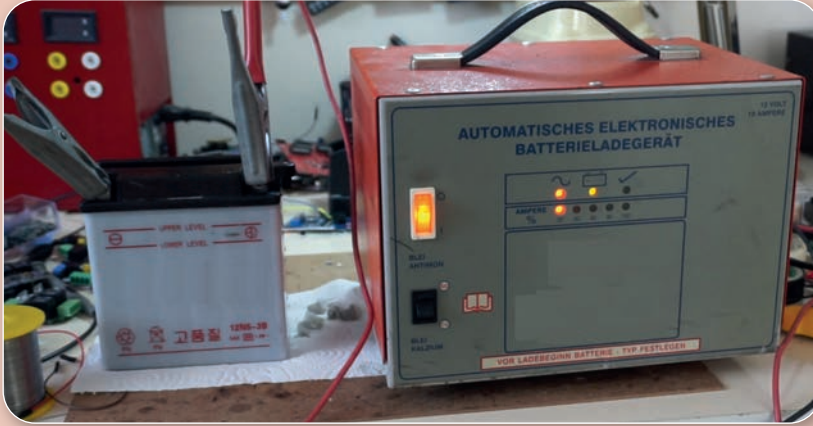
Görsel 18.17: Akü şarj cihazı ile akünün şarj edilmesi
