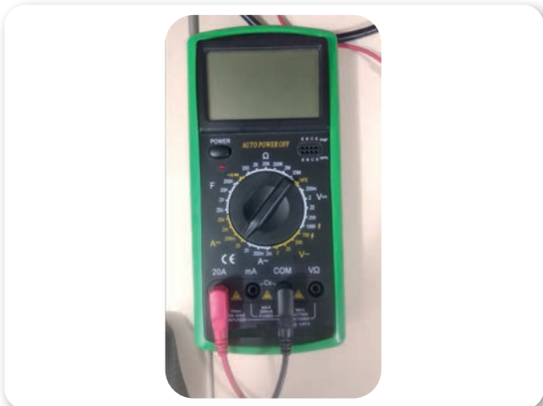
Görsel 16.6: 20 ampere kadar ölçüm yapabilmek amacıyla ayarlanmış bir avometre
