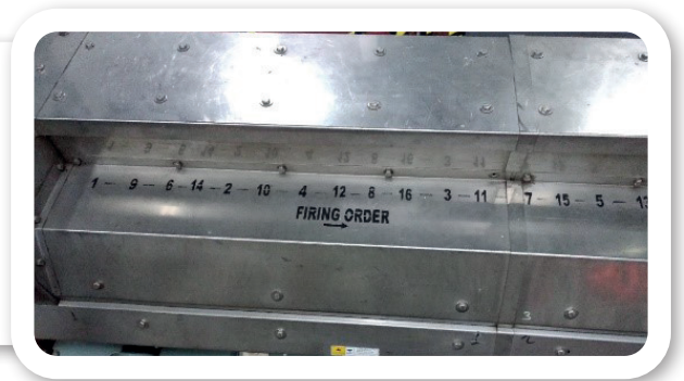
Görsel 12.4: Beraber çalışan pistonlar ve ateşleme sırası
