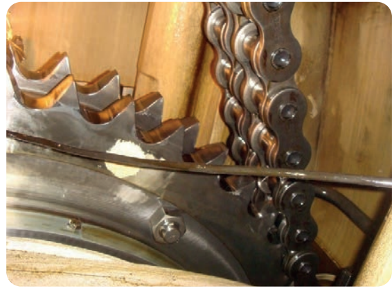
Görsel 14.3:Zincirli tip zaman ayar mekanizması ve ayar işareti
