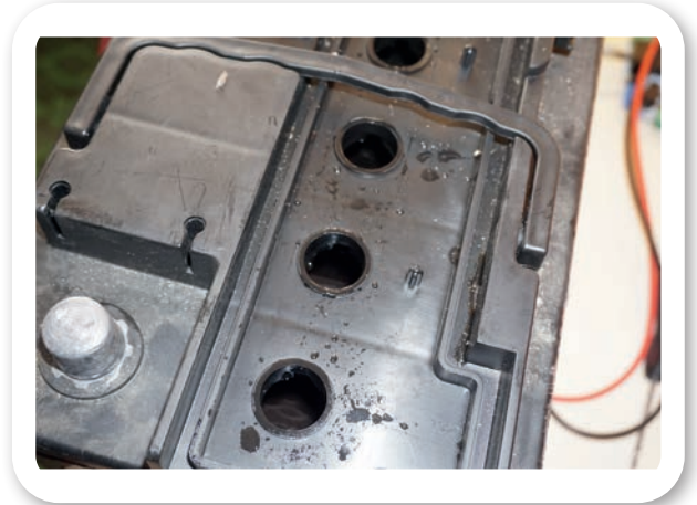
Görsel 18.11: Sıvı kontrolü yapılan bir akü
