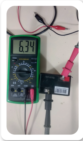
Görsel 17.28: Avometre ile akünün gerilim ölçümü
