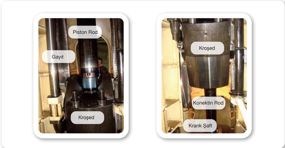
Görsel 14.14: İki zamanlı makinede kroşed
