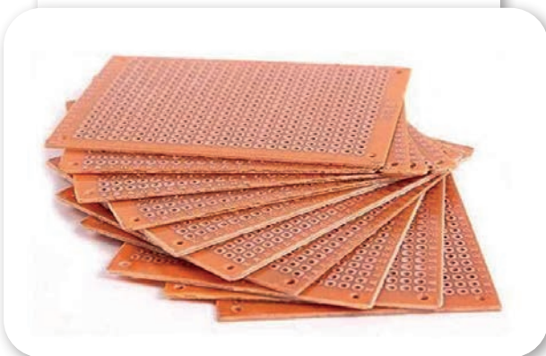
Görsel 17.7: Örnek elektronik devre kartları (PCB) ve delikli plaket
