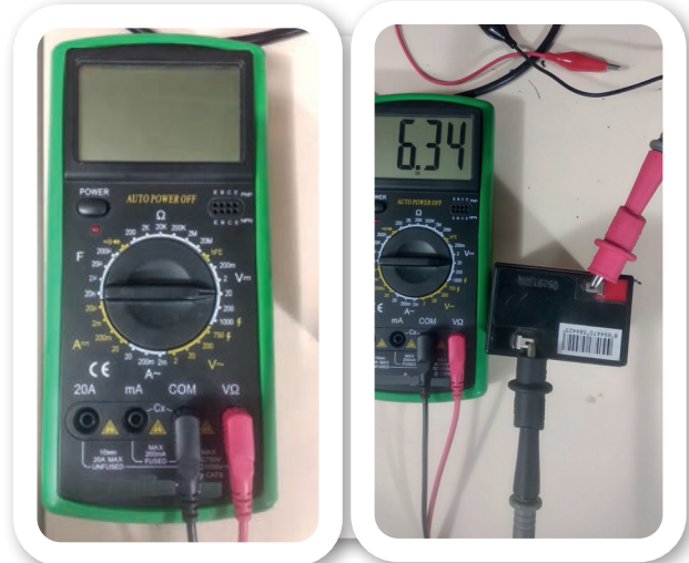
Görsel 16.8: Volt ölçümüne ayarlanan avometre ve örnek bir volt ölçümü
