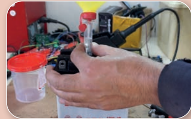
Görsel 18.18: Akü elektrolit seviyesinin kontrolü ve tamamlanması
