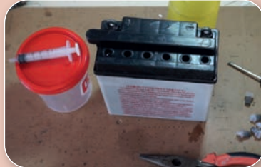
Görsel 18.18: Akü elektrolit seviyesinin kontrolü ve tamamlanması
