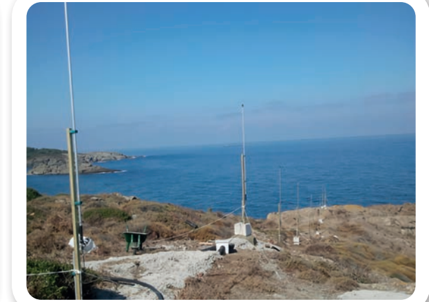
Görsel 6.8: HF Deniz radarı Avrupa yakası alıcı antenleri
